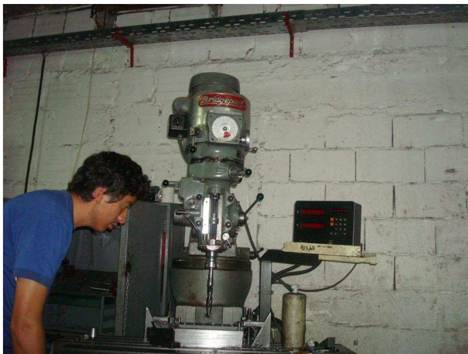
Fotografía 5.1 Fabricación de los soportes laterales
