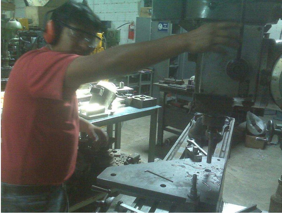
Fotografía 5.4 Elaboración de los agujeros en los soportes laterales Fuente: Propia
