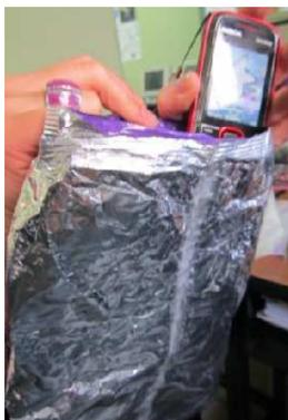
**Figura G.2: Aislamiento del dispositivo de señales de Radiofrecuencia**
