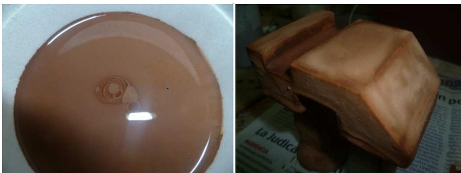
**Figura 3. 24** Aspecto de la pintura refractaria N° 5 después del secado.
