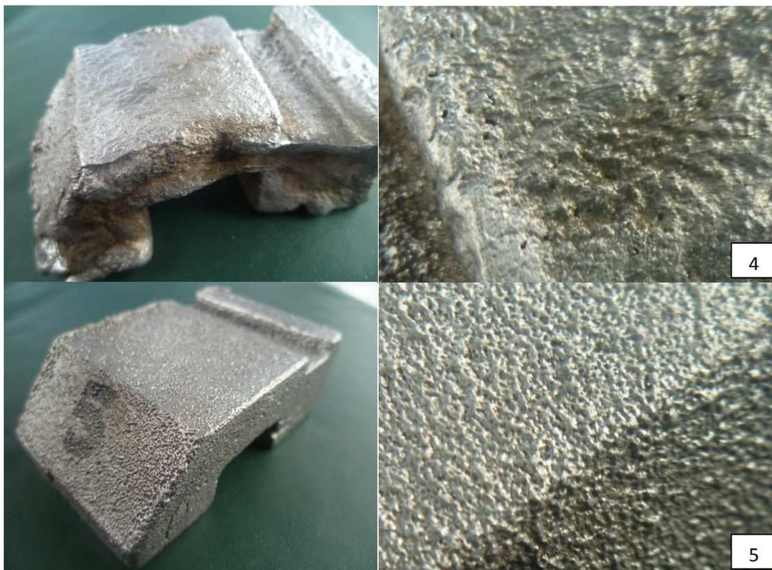
**Figura 4. 25** Piezas fundidas con las mezclas de arena respectivamente y forma de la superficie a 5x ampliado
