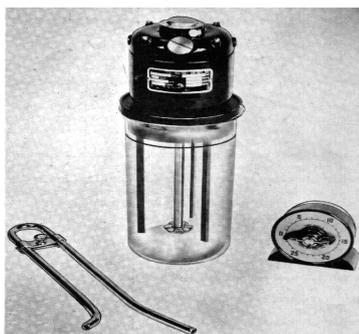
**Figura 2. 5** Agitador eléctrico y sifón
