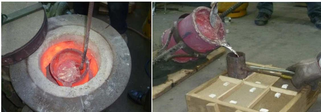
**Figura 5. 7** Colado del metal en el modelo gasificable
