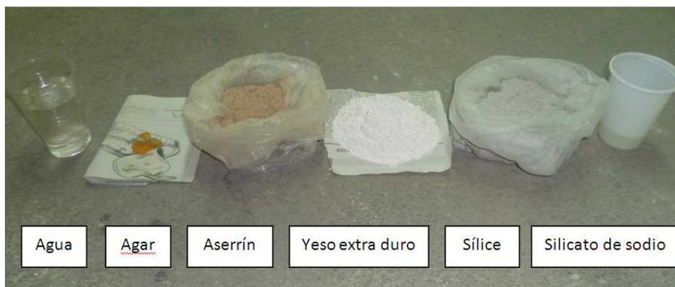
**Figura 3. 18** Elementos de la pintura refractaria N° 3.
