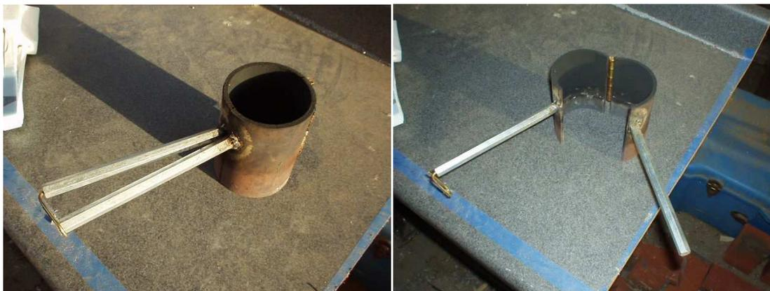
Figura 5. 4 Forma del bacín metálico construido
