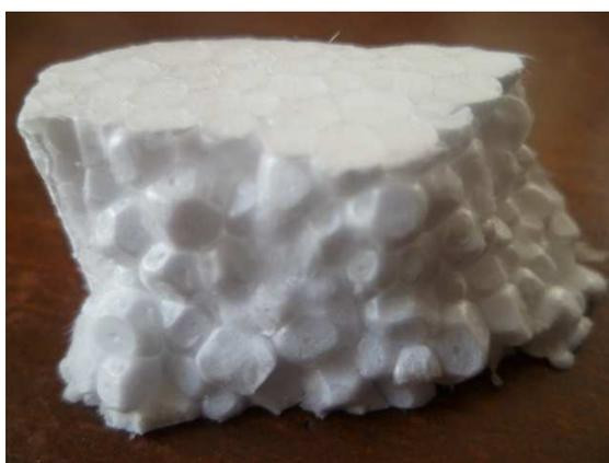
**Figura 1. 3** Fotografía de un fragmento de poliestireno expandido.
