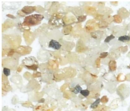
**Figura 2. 16** Fotografía de la forma de grano de arena marrón nueva del laboratorio de fundición de EPN, después de realizar el ensayo del contenido de arcilla.
