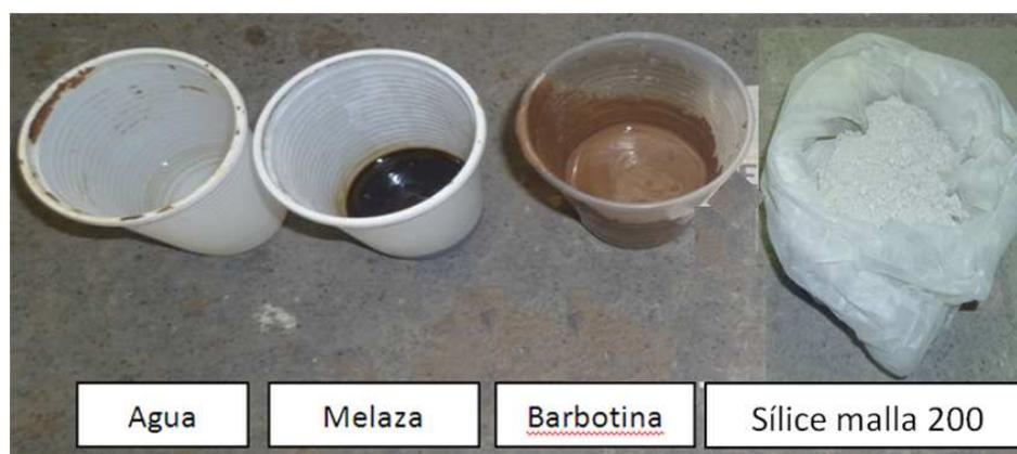
Figura 3. 23 Elementos de la pintura refractaria N° 5.
