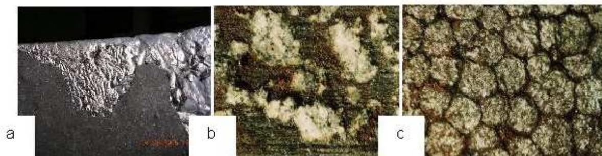
**Figura 4. 13** Defectos debidos al proceso de fundición; a) Gases atrapados, b) Inclusiones de arena, c) superficie rugosa.<sup>31</sup>
