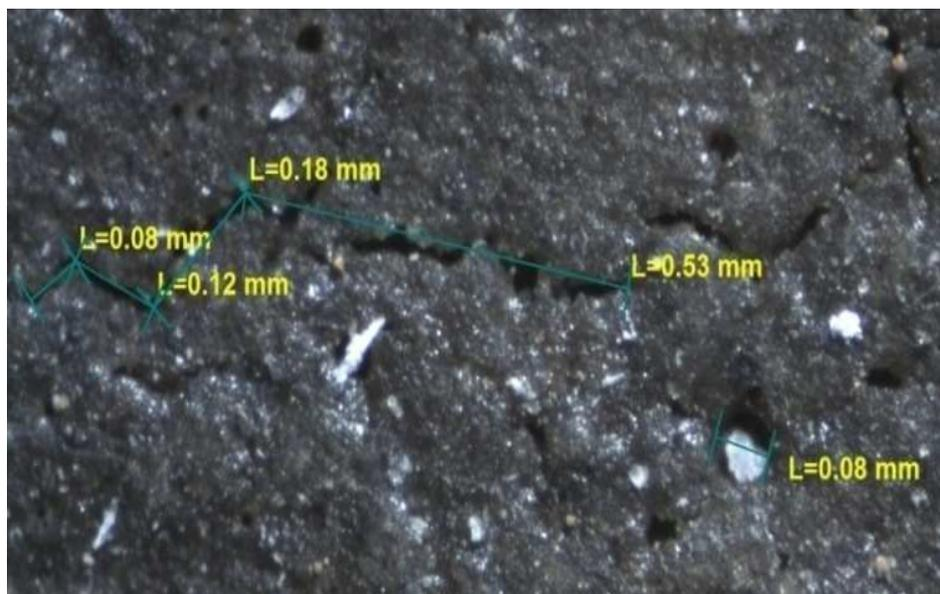
**Figura 3. 29** Cascara de la pintura refractaria seca a 40X de ampliación.
