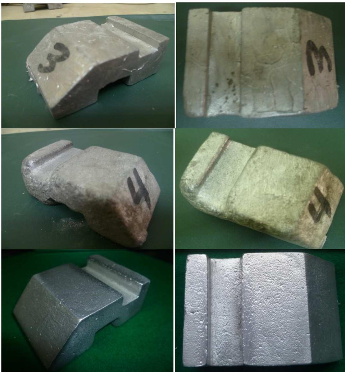
**Figura 4. 29** Piezas fundidas recubiertas con pintura refractarias en su orden respectivamente.
