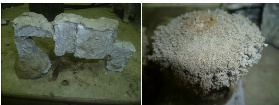
**Figura 3. 15** Aspecto de la pintura refractaria N° 1 después del secado.
