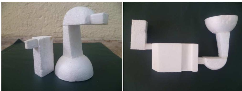
Figura 5. 3 Forma del sistema de alimentación y ubicación en el modelo de espuma
