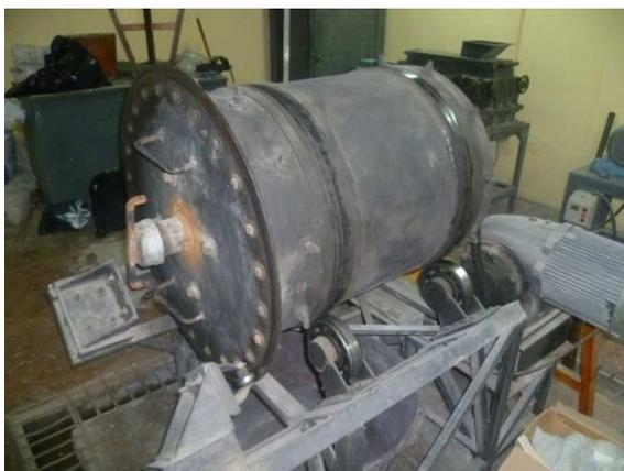
**Figura 3. 26** Molino de bolas de metalurgia extractiva en funcionamiento
