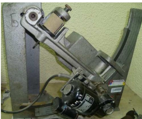
**Figura 2. 19** Máquina universal para determinar la resistencia de las arenas y machos de moldeo
