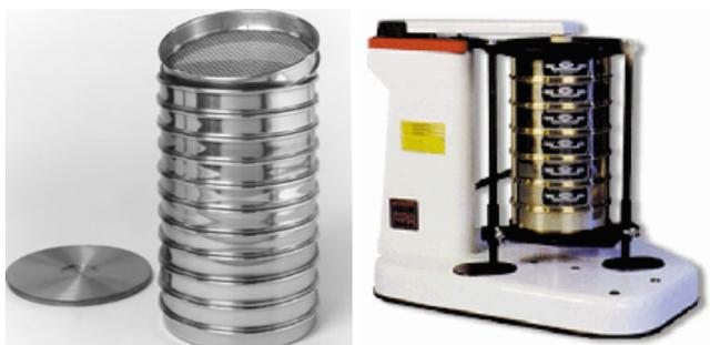
**Figura 2. 6** Aparato para determinar la composición granular de la arena
