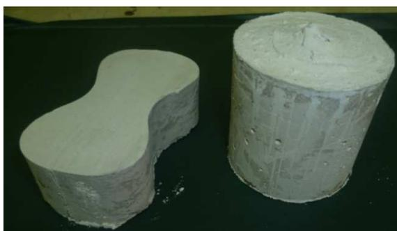
**Figura 3. 25** Forma de probetas para ensayos de pinturas refractarias.
