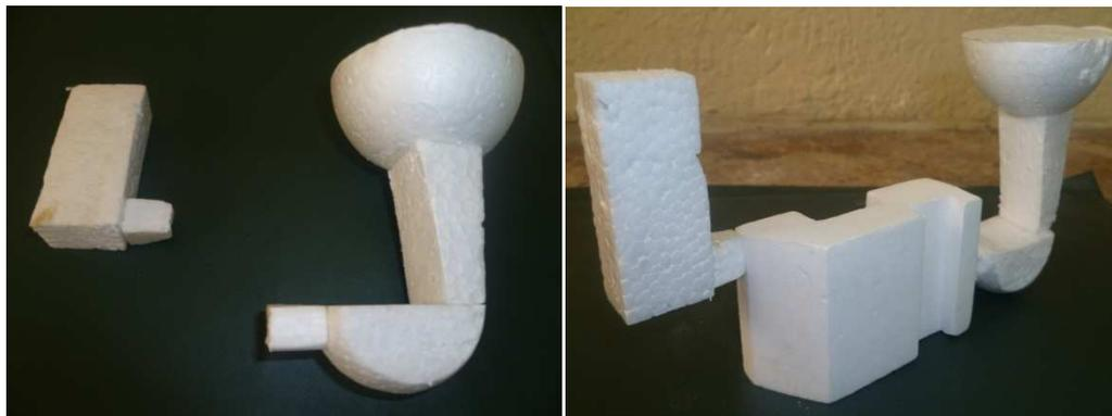
**Figura 4. 22** Forma del sistema de alimentación y ubicación en el modelo de espuma
