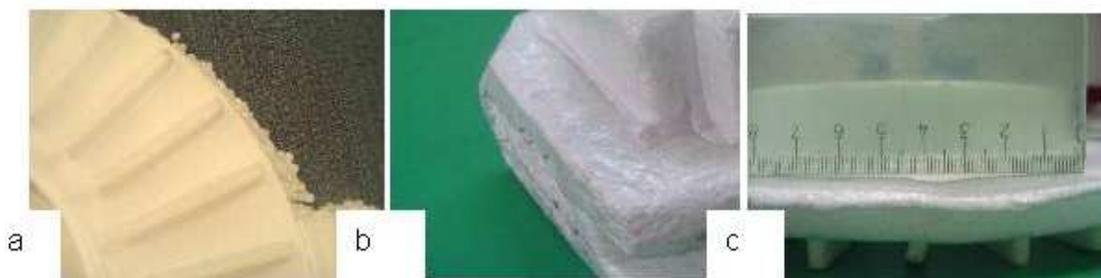
**Figura 4. 12** Defectos típicos en los modelos de espuma de poliestireno; a) Rebabas, b) Superficie quemada, c) desnivel.<sup>31</sup>
