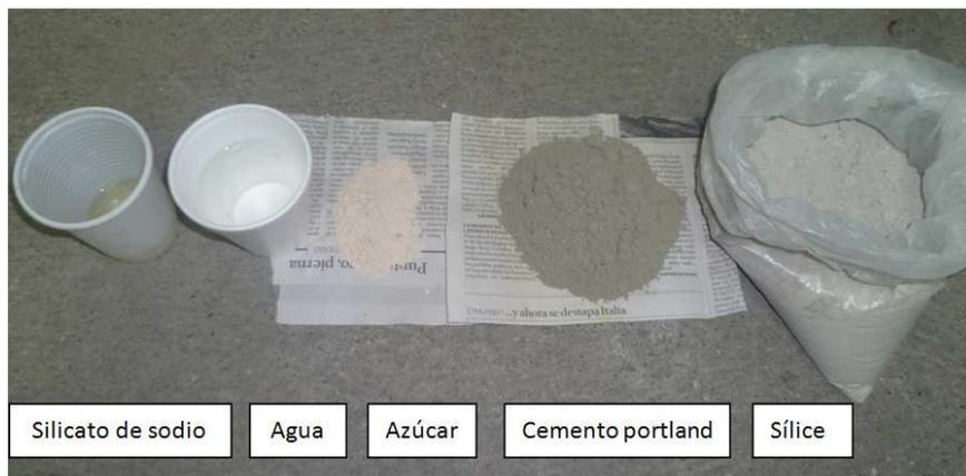
**Figura 3. 16** Elementos de la pintura refractaria N° 2.
