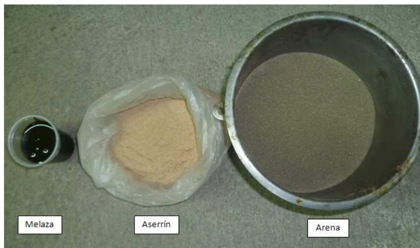
**Figura 3. 2** Elementos de la mezcla N° 2
