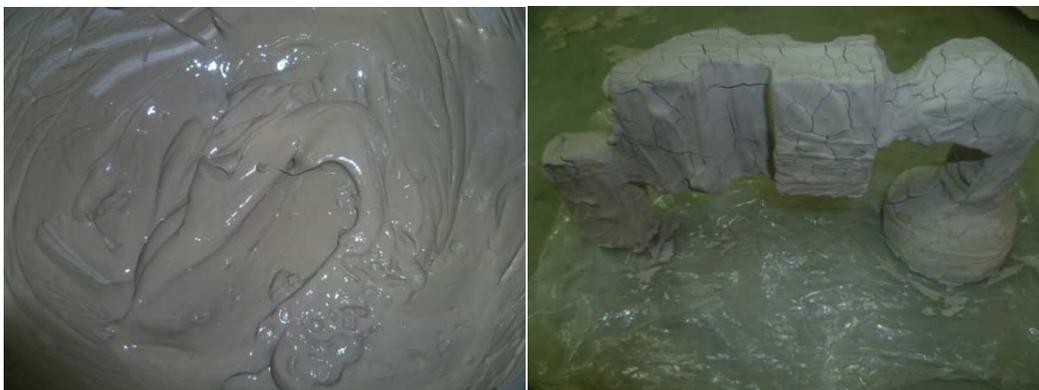
**Figura 3. 17** Aspecto de la pintura refractaria N° 2 después del secado.
