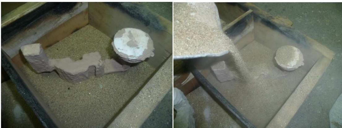
**Figura 5. 6** Proceso de moldeo del modelo recubierto con pintura refractaria
