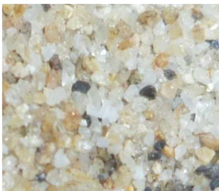
**Figura 2. 15** Fotografía de la forma de grano de arena marrón vieja del laboratorio de fundición de EPN, después de realizar el ensayo del contenido de arcilla.
