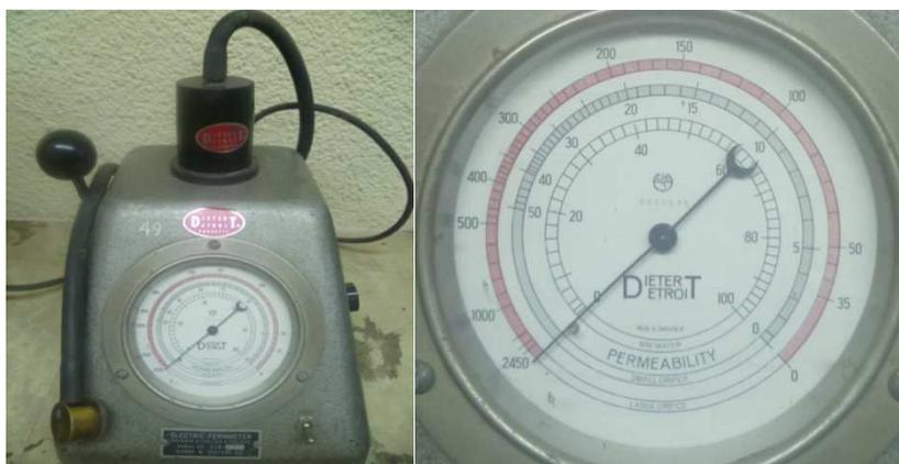
**Figura 2. 18** Medidor de permeabilidad eléctrico y escala de colores
