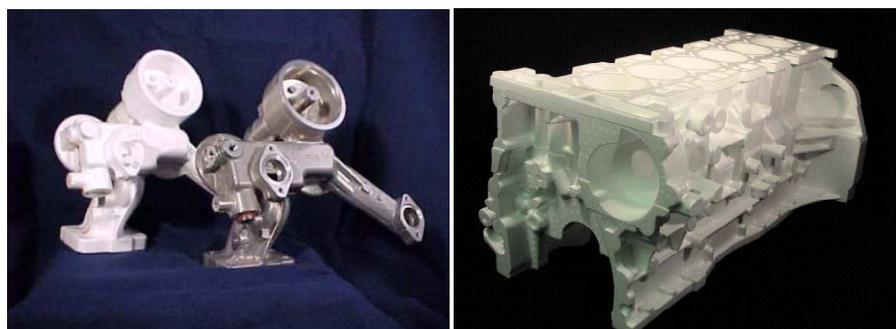
**Figura 1. 1** Modelos actuales del poliestireno expandible.<sup>2</sup>
