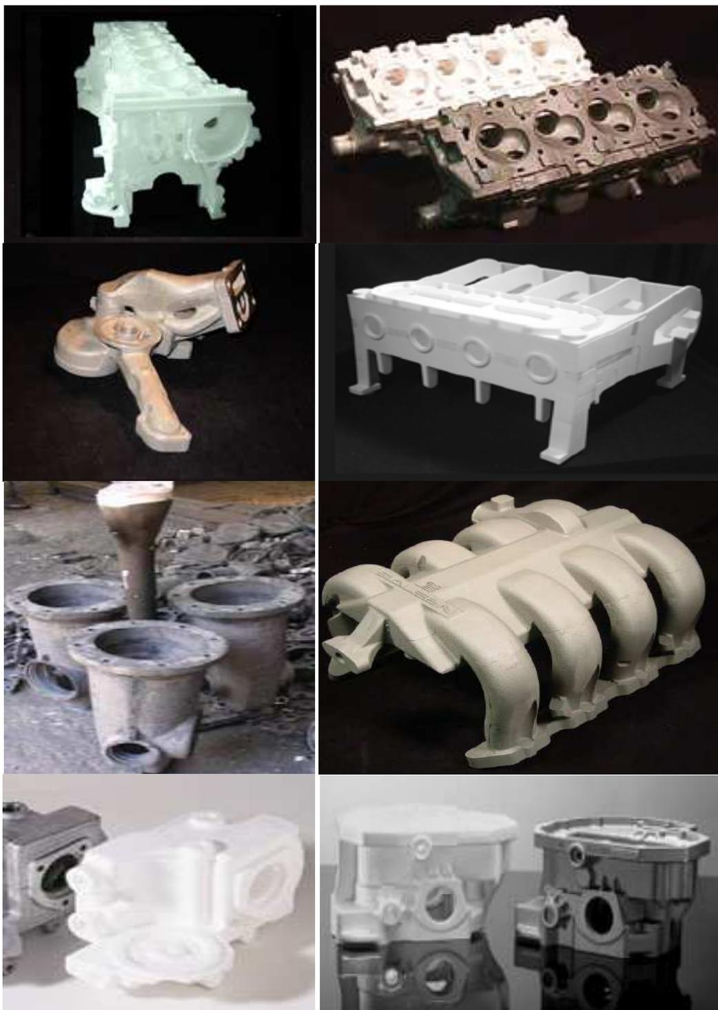
**Figura 1. 9.** Aplicaciones varias del Poliestireno en la fundición.<sup>12</sup>
