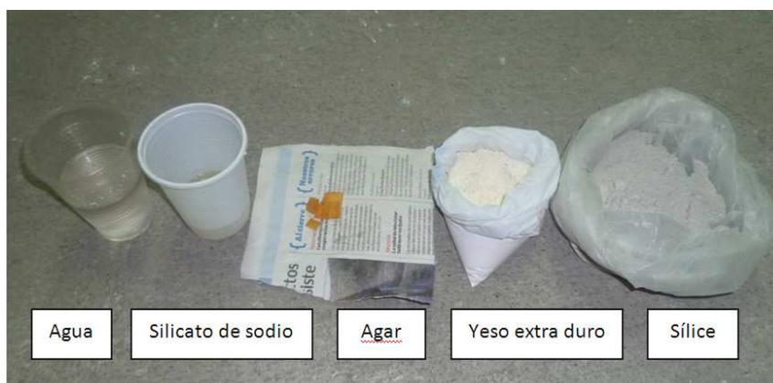
**Figura 3. 20.** Elementos de la pintura refractaria N° 4.
