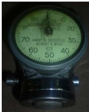
**Figura 2. 21** Instrumento para determinar la dureza en verde de moldes y machos (escala B).
