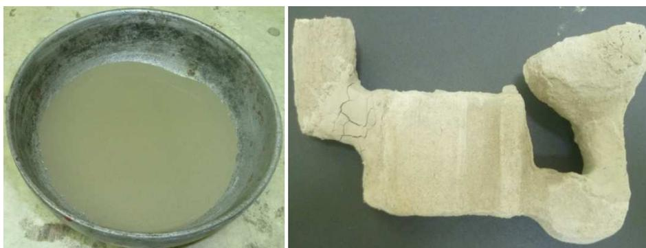
**Figura 3. 21** Aspecto de la pintura refractaria N° 4 después del secado.
