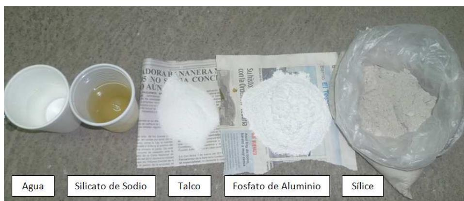
Figura 3. 14 Elementos de la pintura refractaria N° 1.
