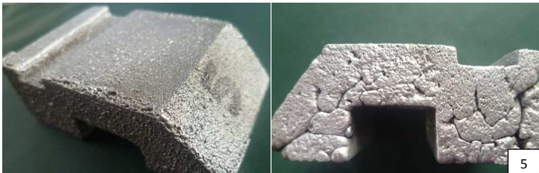
**Figura 4. 26** Defectos en la piezas fundidas con la mezclas de arena fabricadas respectivas.
