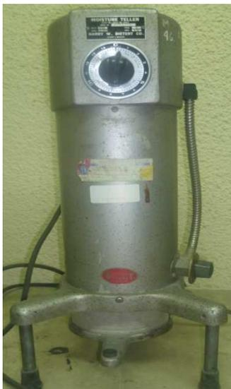
**Figura 2. 17** Instrumento para determinar el contenido de humedad de arenas para fundición.
