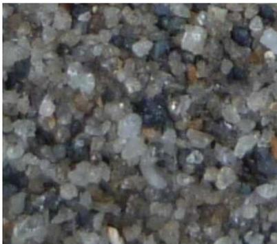
**Figura 2. 14** Fotografía de la forma de grano de arena negra del laboratorio de fundición de EPN, después de realizar el ensayo del contenido de arcilla.
