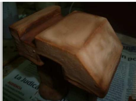
**Figura 5. 5** Aspecto de la pintura refractaria después del secado.
