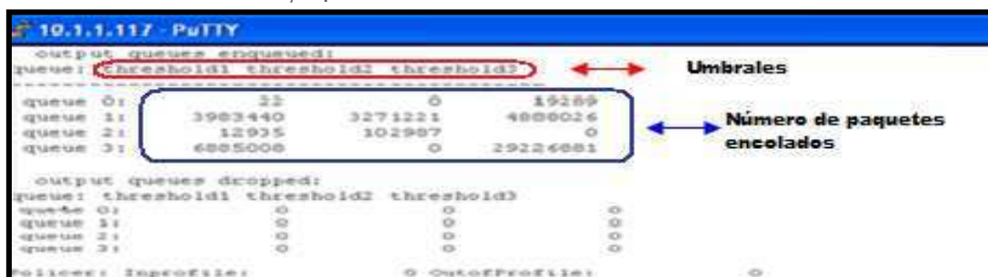
Figura 4.11 Número de paquetes encolados en las colas de salida en la interfaz gigabitEthernet 0/24 del Switch del Museo de la Ciudad.
