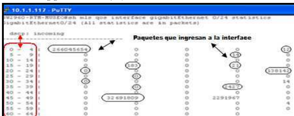
Figura 4.9 Estadísticas de los paquetes marcados que están ingresando en la interfaz gigabitEthernet 0/24 del Switch del Museo de la Ciudad.
