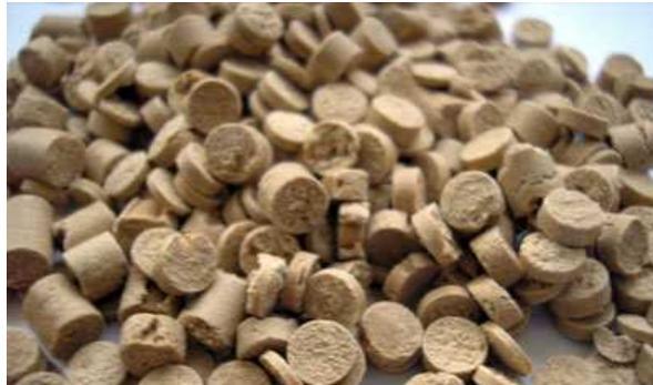
**Figura 14.** Granza de material compuesto obtenida del proceso de extrusión.
