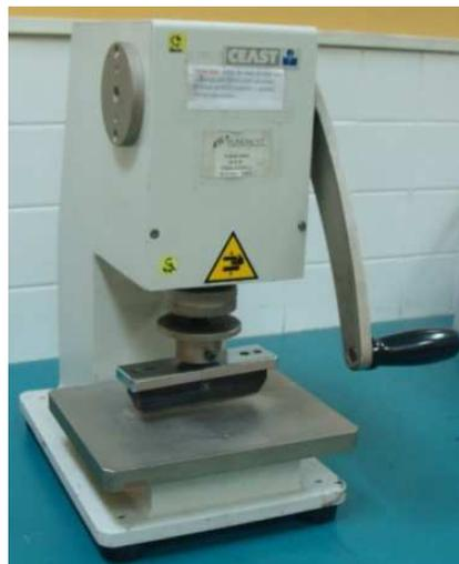
**Figura 31.** Troquel perteneciente al CIAP utilizado en el corte de probetas para pruebas mecánicas de material compuesto
