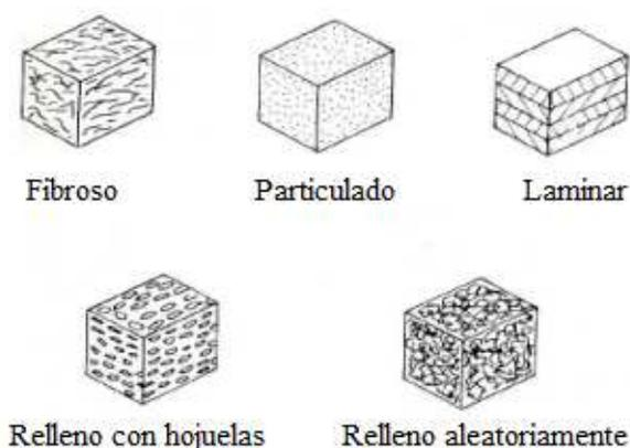
**Figura 5.** Diferentes tipos de refuerzos en materiales compuestos
