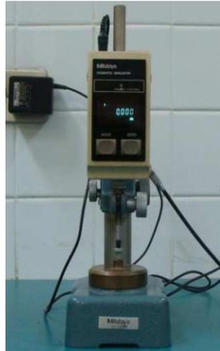
**Figura 32.** Micrómetro MITUTOYO utilizado en mediciones de espesor para pruebas mecánicas de material compuesto
