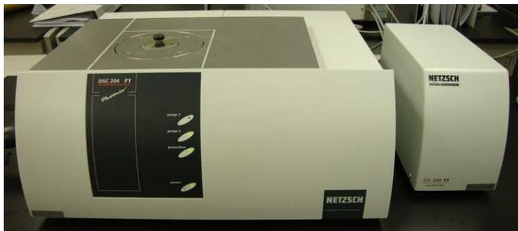
**Figura 23.** Calorímetro diferencial de barrido marca NETZSCH
