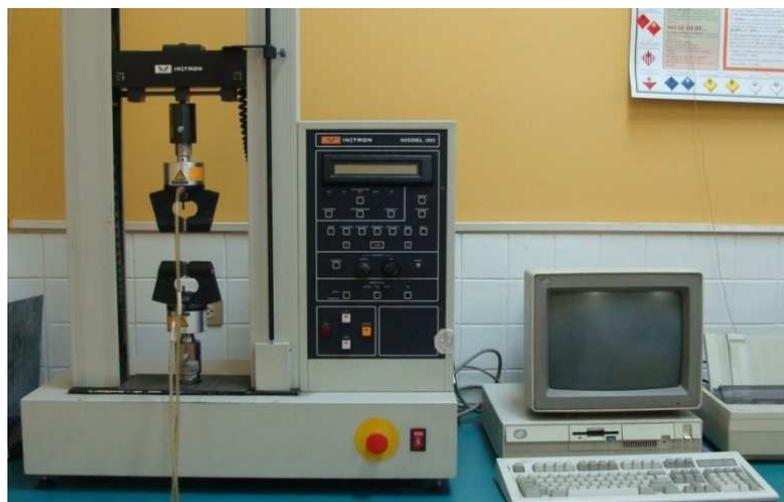
**Figura 33.** Máquina de ensayos universales
