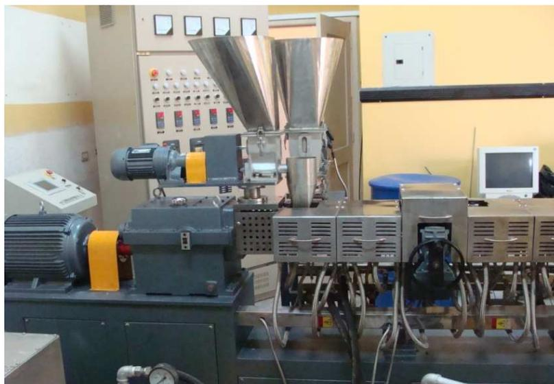
**Figura 25.** Extrusora de doble husillo co-rotante marca JIANGYSU XINDA.
