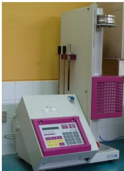
**Figura 34.** Plastómetro de extrusión empleado para la determinación del índice de fluidez
