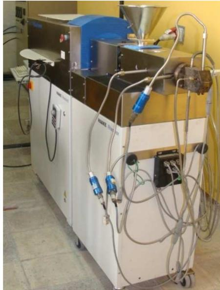
**Figura 30.** Reómetro de torque electrónico marca HAAKE modelo PolyLab System utilizado para la conformación de cintas
