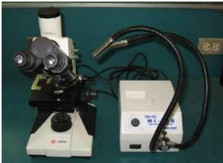
**Figura 29.** Microscopio Thomas Scientific 1230CM con el equipo de luz Fiber-Lite MI-150 High Intensity Illuminator.
