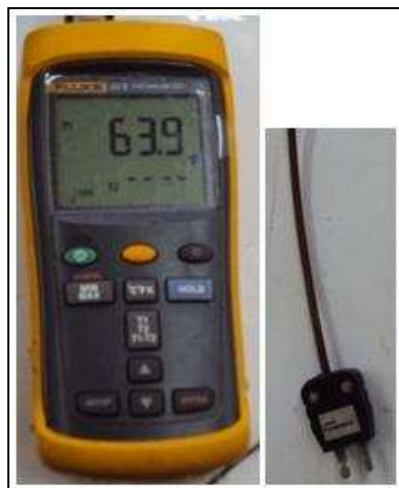
Figura 2.4. Medidor de temperatura marca Fluke y termocupla tipo J.
