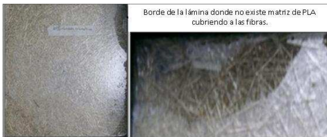
Figura 3.10. Láminas de material compuesto con zonas donde la fibra no está cubierta por la matriz completamente.
