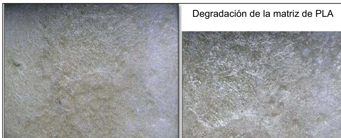
Figura 3.12. Láminas de material compuesto con zonas donde la matriz ha sufrido degradación.
