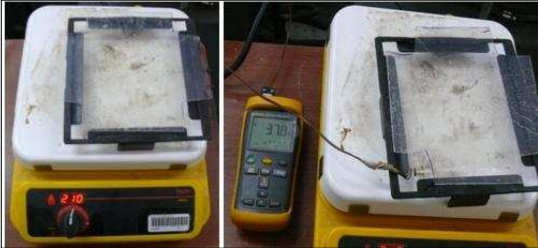
Figura 2.25. Calentamiento de las láminas.
