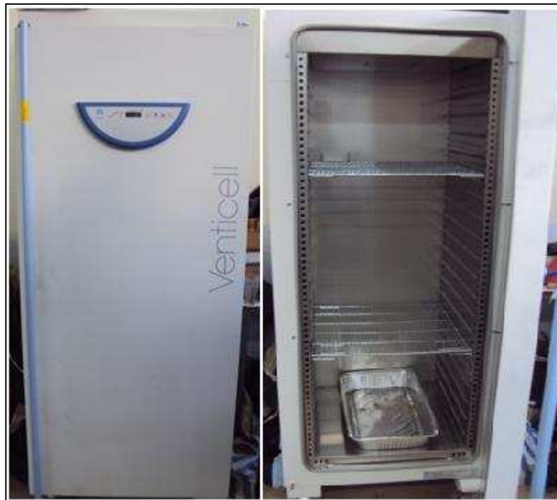
Figura 2.6. Estufa para secado del PLA y de la fibra natural marca Venticell.
