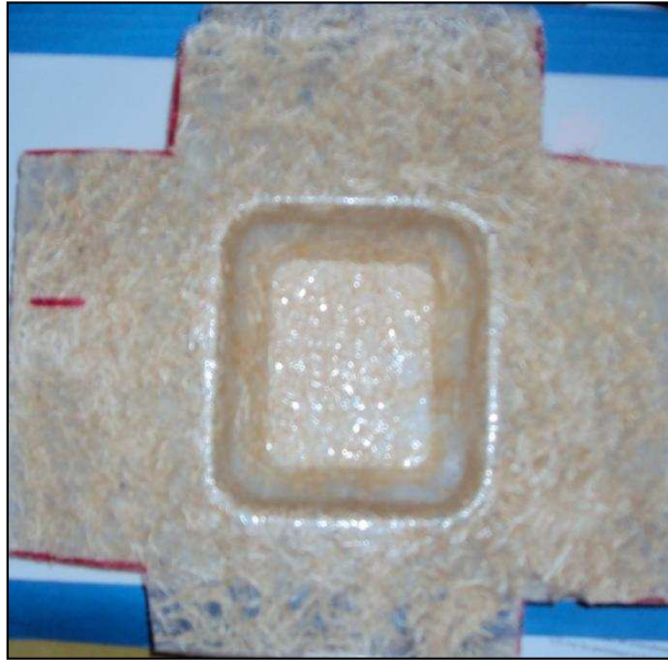
Figura 3.36. Bandeja unida al resto de la lámina de material compuesto.
