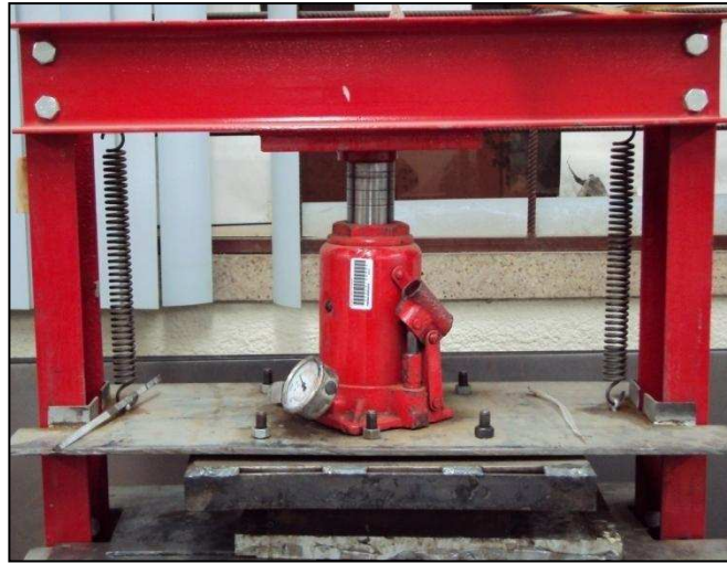
Figura 2.5. Prensa hidráulica de 12 toneladas para enfriamiento de láminas bajo presión.
