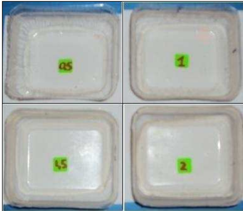
Figura 3.37. Prototipos de PLA elaborados con láminas de 0,5; 1,0; 1,5 y 2,0 mm.
