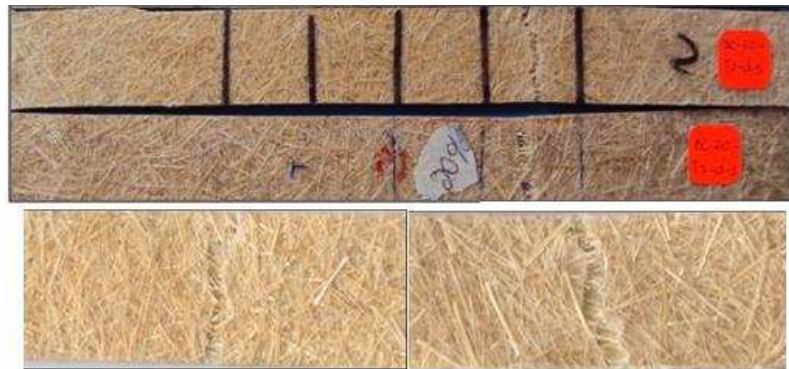
(c) Fractura producida enteramente en la matriz. Las fibras se encuentran entrelazadas unas con otras sin sufrir fractura.
