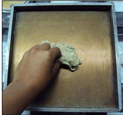
Figura 2.17. Aplicación de cera desmoldante sobre el molde.
