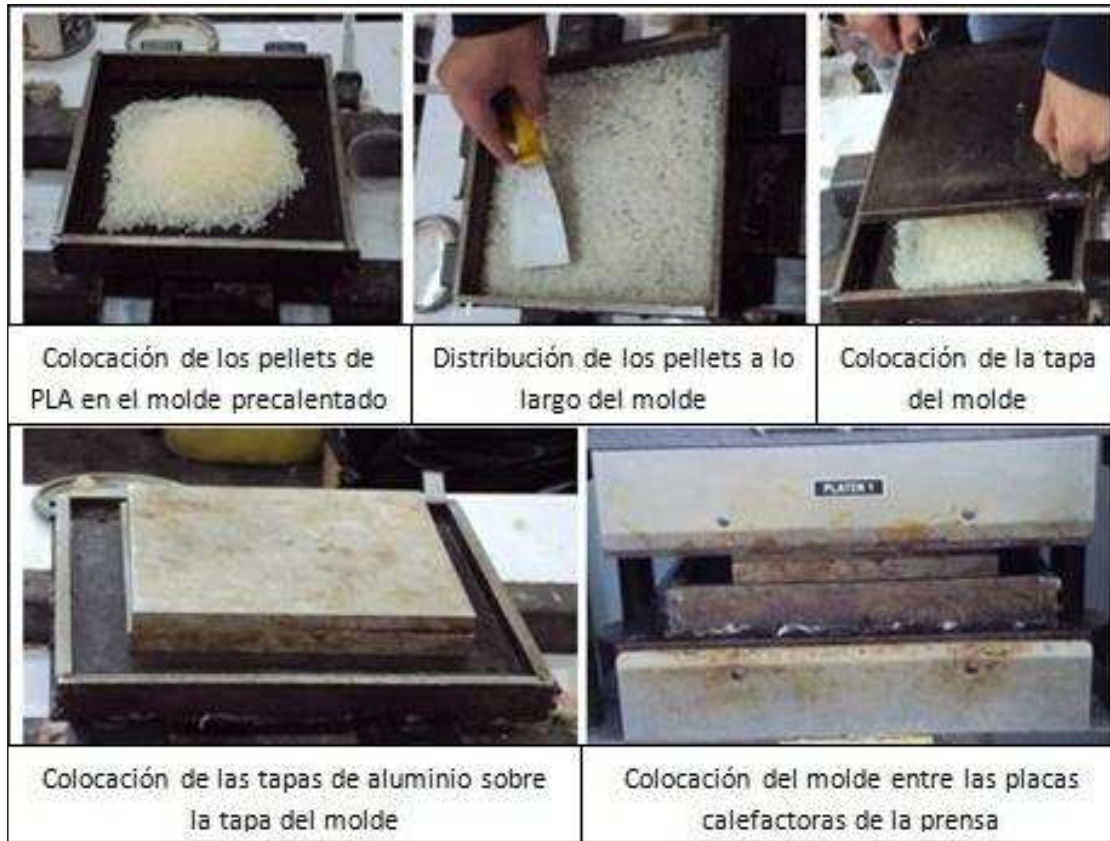
Figura 2.18. Colocación de los pellets de PLA en el molde.
