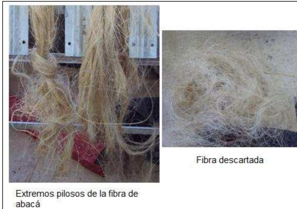
Figura 2.16. Pilosidad en los extremos de la fibra de abacá almacenada.
