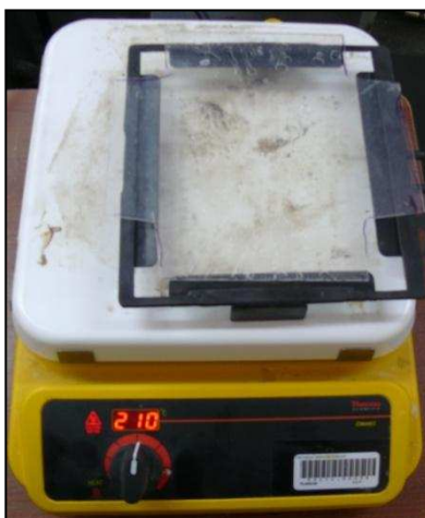
Figura 2.11. Estufa para calentamiento de láminas Thermo Scientific modelo Cimarec.
