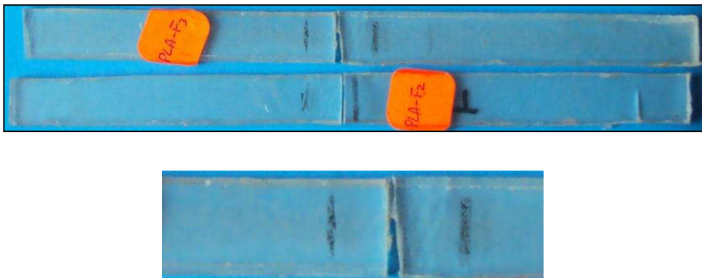
(a) Fractura completa de la matriz al final del ensayo.
