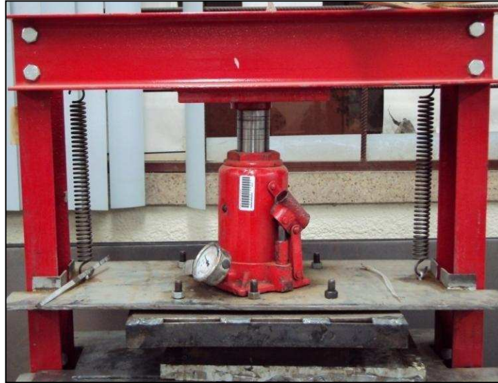
Figura 3.9. Prensa utilizada en el enfriamiento lento con aplicación de presión.
