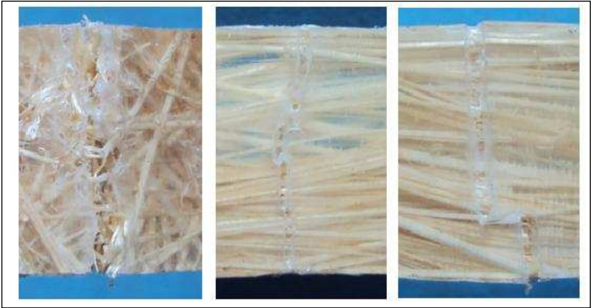
Figura 3.21. Fractura típica en la matriz de PLA en los materiales compuestos de fibra corta y continua unidireccional.
