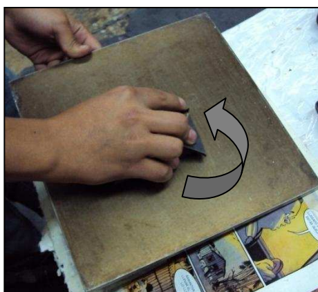
Figura 3.1. Lijado de las paredes del molde para mejorar el acabado superficial.
