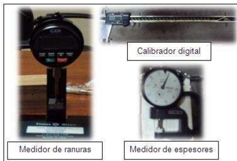
Figura 2.9. Equipos utilizados en la medición de las dimensiones de las probetas.
