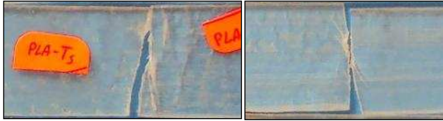
(a) Fractura frágil de la matriz sin producirse una reducción de la sección de la probeta.
