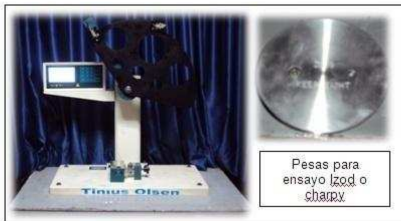
Figura 2.8. Máquina de impacto Tinius Olsen modelo IT 504.
