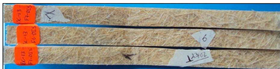
(a) Fractura completa de la matriz al final del ensayo.
