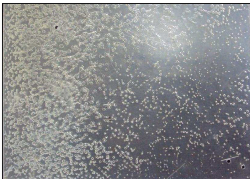
Figura 3.4. Fallas superficiales e internas del PLA por exceso de temperatura de procesamiento.
