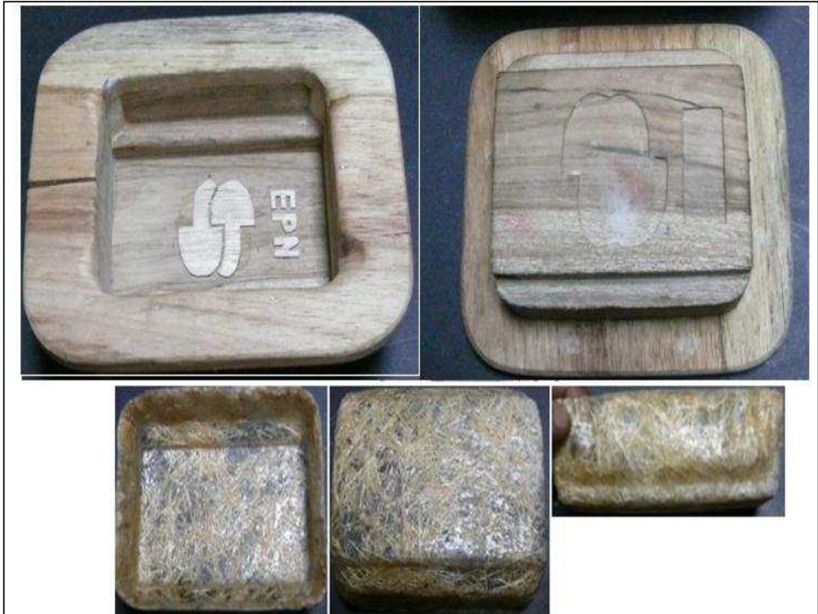
Figura 3.32. Molde macho-hembra de madera y caja de material compuesto termformada en el mismo.
