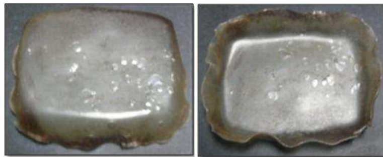
Figura 3.30. Láminas de PLA termoformadas sin molde.
