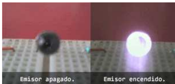
Figura 1.7 Led infrarrojos en funcionamiento. (5)
