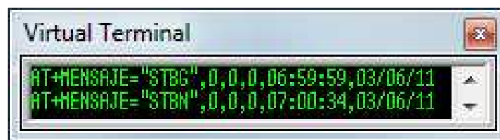
Figura 2.40 Envío de datos al módulo externo inicio de recorrido.
