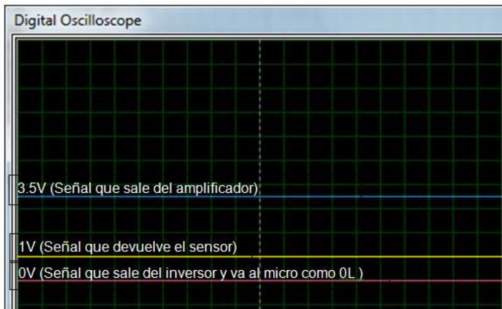
Figura 2.16 Señales cuando se corta la señal infrarroja
