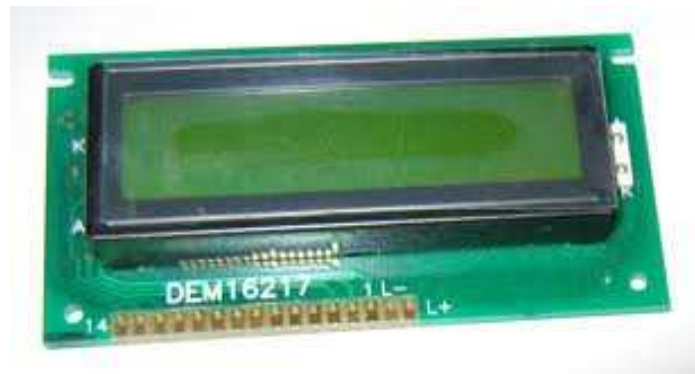
Figura 1.15 Display LCD 16 x 2. (14)
