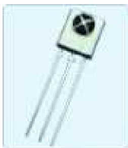
Figura 1.8 Receptor o sensor infrarrojo. (5)
