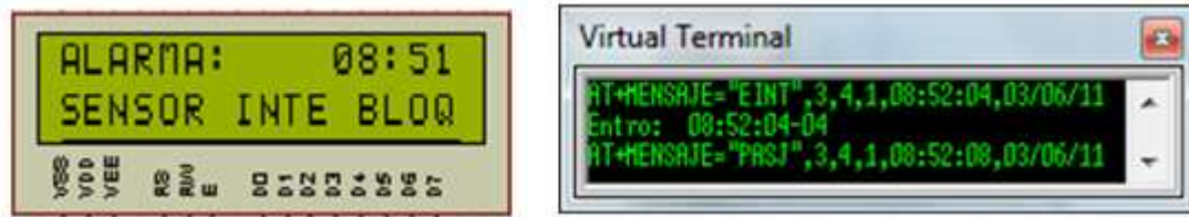
Figura 2.48 Información de bloqueo de sensor interno.
