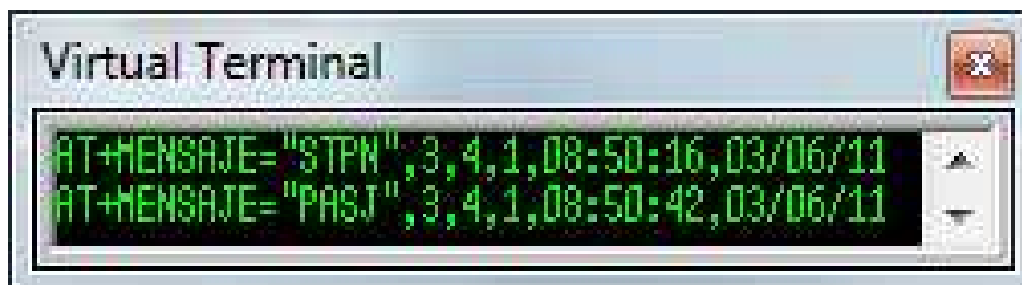
Figura 2.46 Mensaje desactivación del modo Parada.
