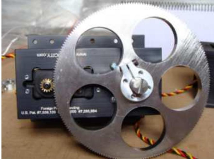
**Figura 2-62.** Servomotor HITEC HS-7955TG ocupado en el sistema de apuntamiento.
