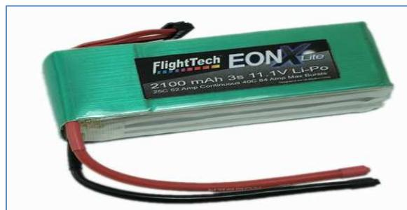
**Figura 2-113.** Batería de Polímero de Litio 2100 mAh 11.1 V, ocupada en sistema de apuntamiento móvil.
