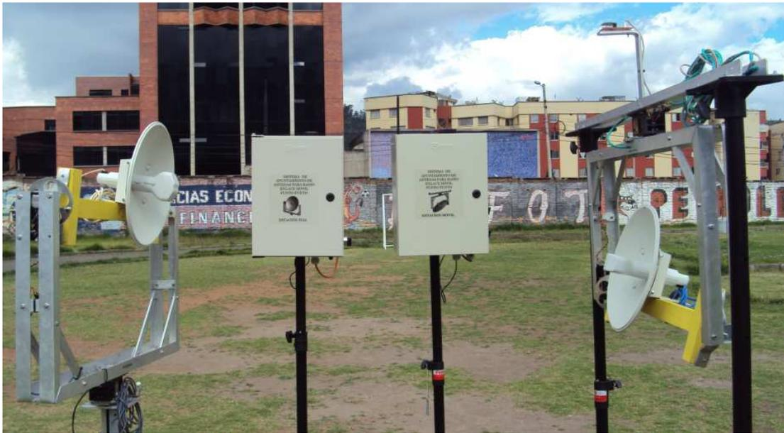
**Figura 2-120.** Sistema final: se puede apreciar tanto la antena transmisora como la receptora con sus respectivos sistemas de control.
