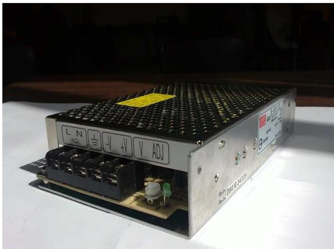
**Figura 2-112.** Fuente conmutada de 120(Vac) a 12(Vdc) para 5 amperios como carga máxima.
