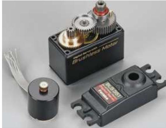
**Figura 2-47.** Vista externa e interna de un servomecanismo utilizado en robótica.
