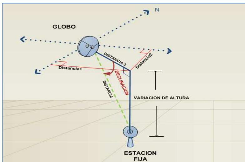
**Figura 2-80.** Variación de declinación de Antena Móvil
