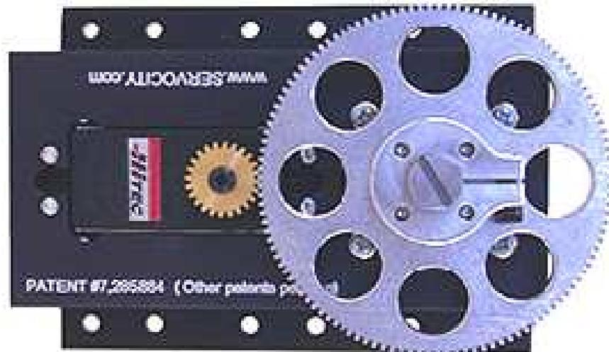
**Figura 2-48.** Sistema de engranaje acoplado al servomotor para aumentar el torque.
