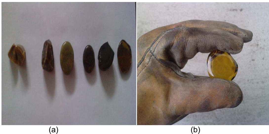
Figura 3.1. (a) Diferentes escorias producto de la elaboración del “Plomo de Obra”; (b) Escoria final obtenida del “Plomo de Obra”
