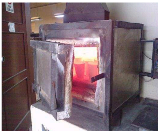
Figura 2.2. Crisoles dentro del horno eléctrico de mufla de marca Sepor
