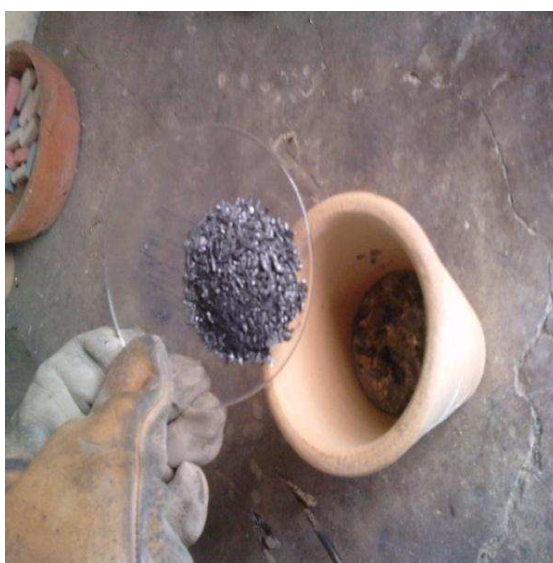
Figura 2.4. Colocación del zinc en “Plomo de Obra” acondicionado a la temperatura del ensayo
