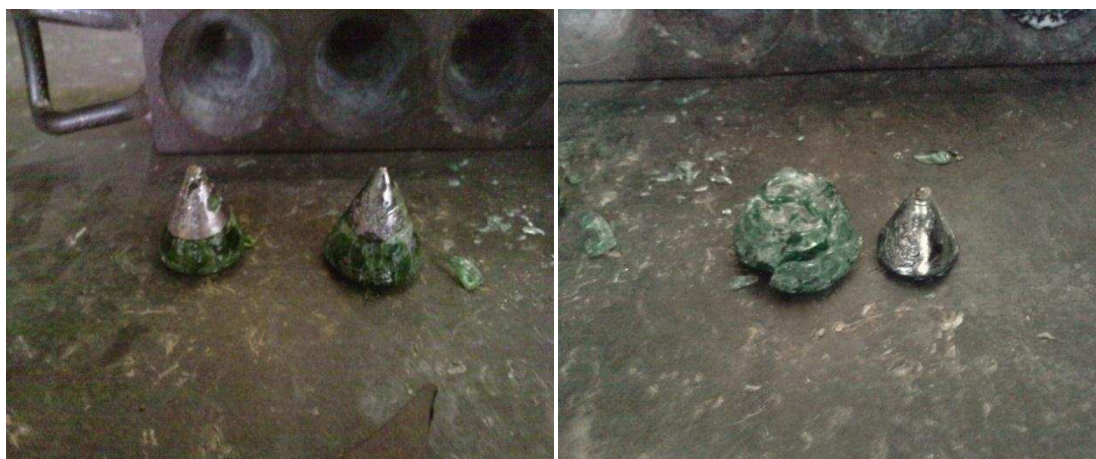
Figura 2.3. (a) Producto del proceso de fusión; (b) A lado izquierdo se encuentra la escoria y a lado derecho el “Plomo de Obra”
