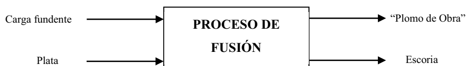
Figura 3.7. Esquema de la elaboración del “Plomo de Obra”
