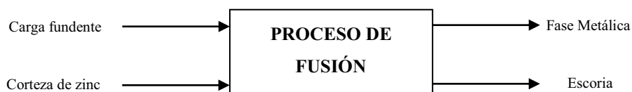
Figura 3.9. Esquema del proceso de fusión para extracción de plata
