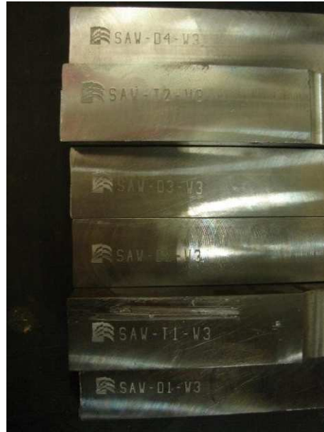
Figura 2. 7 Marcación de Probetas para Ensayos Destructivos SA-516 Gr. 70
