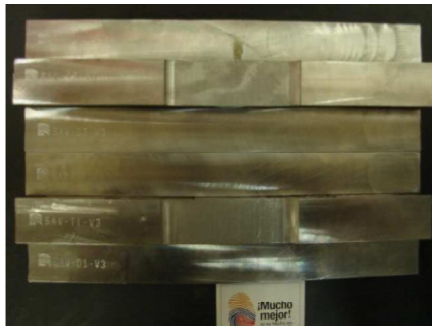
Figura 2. 8 Marcación de Probetas para Ensayos Destructivos SA-516 Gr. 70
