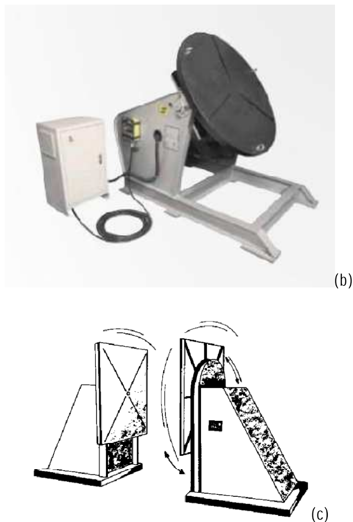
Figura 1.9 Posicionadores y Viradores: (a) Virador de Rodillos giratorios, (b) Posicionador de Inclinación y Giratorio, y; (c) Posicionador de Plataforma Giratoria
