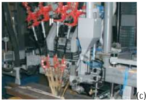
Figura 1.2 Variaciones del Proceso de Soldadura por Arco Sumergido: (a) disposición de un electrodo, (b) disposición de electrodo gemelo, y; (c) disposición de múltiples electrodos.
