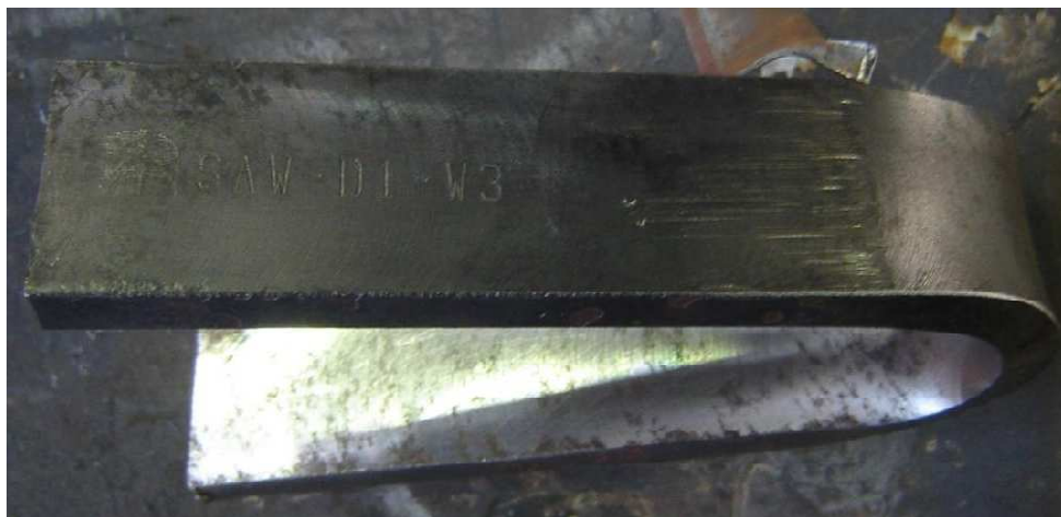
Figura 2.11 Resultado de Ensayo de Doblado de Probeta SAW-D1-W3
