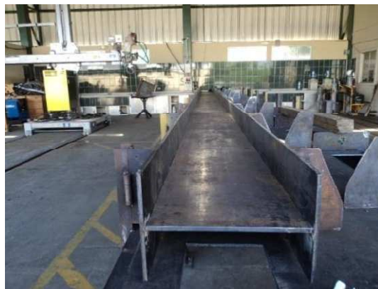
Figura 4. 36 Disposición de la Columna en Posición de Soldadura a Filete
