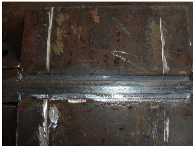
Figura 4. 33 Soldadura de Raíz con Un Pase
