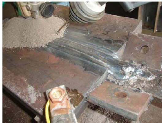
Figura 4. 31 Soldadura por Arco Sumergido
