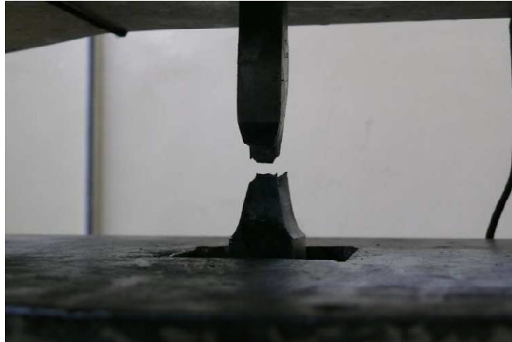
Figura 2.9 Ruptura por Tracción de Probeta SAW-T1-W3
