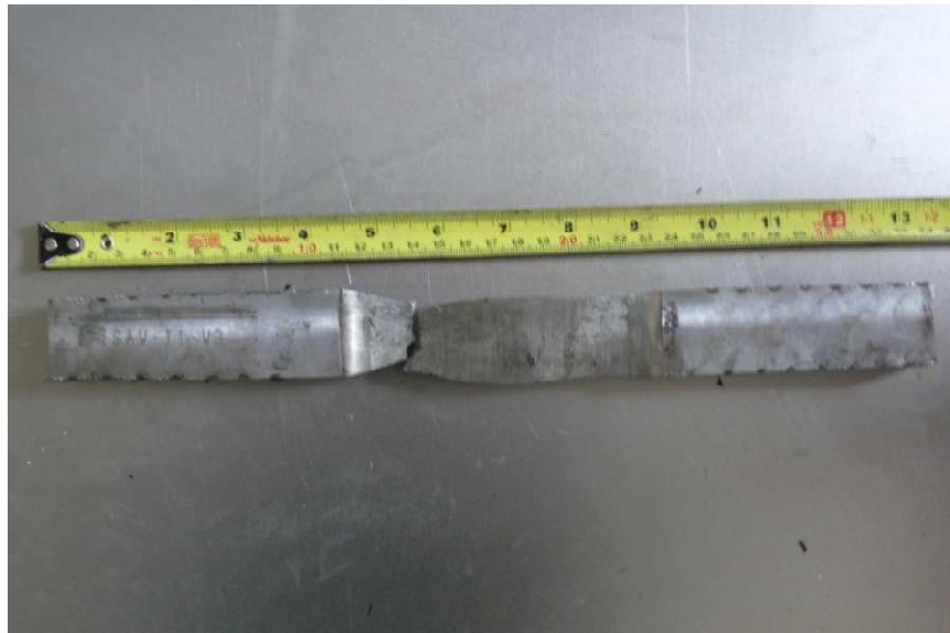
Figura 2.10 Resultado de Ensayo de Tracción de Probeta SAW-T1-W3
