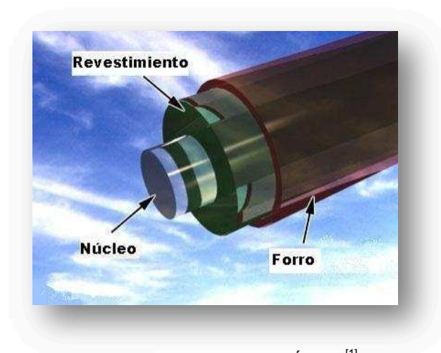
Figura 1.1 Partes de la Fibra Óptica [1]
