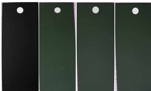
Figura 7. Placas rectangulares de 40x100 mm de acero al carbono, acero galvanizado, cobre y aluminio con recubrimientos de pintura
