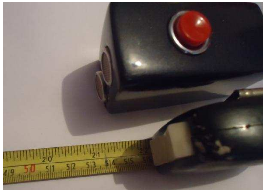
Figura 4.2 Prueba con el flexómetro a 54cm.
