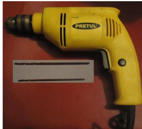
Figura 2.32 Taladro para perforar la placa.
