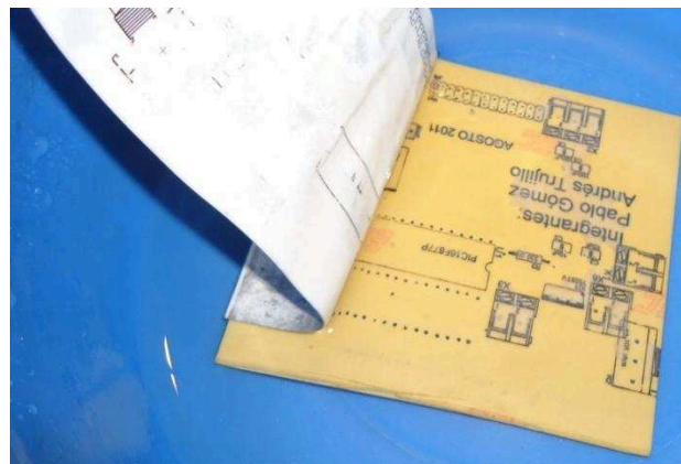
Figura 2.34 Retirar la lámina.
