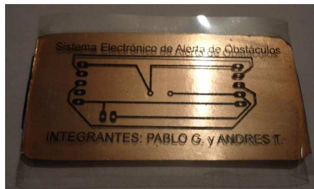
Figura 2.28 Placa lista para el planchado.
