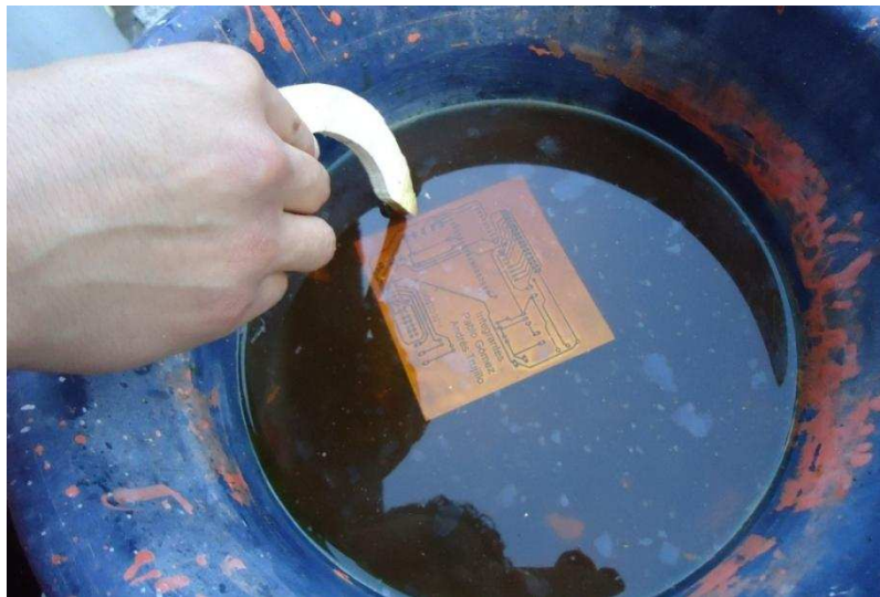
Figura 2.30 Quemado de la placa con acido.
