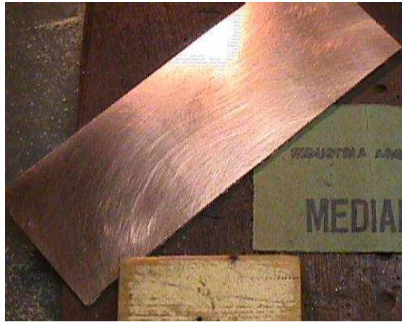
Figura 2.27 Placa limpia y lista para la transferencia.
