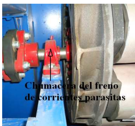
Figura A3.10 Chumacera del freno de corrientes parásitas.
