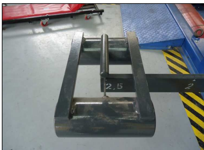
Figura 4.10 Colocación del peso de 30 kg en la barra de calibración.
