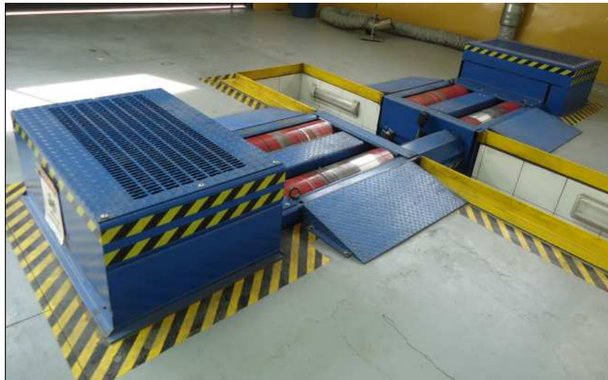
Figura 3.1 Dinamómetro de chasis LPS 3000 asignado como sistema mecánico.
