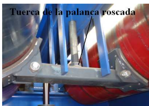
Figura A3.30 Tuerca de la palanca roscada.
