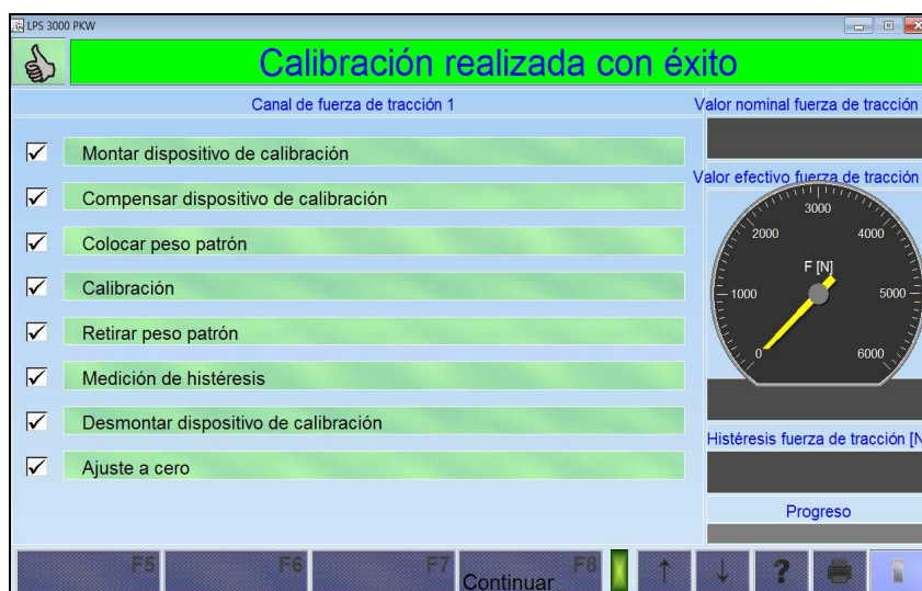
Figura 4.13 Ajuste a cero de la fuerza de tracción.
