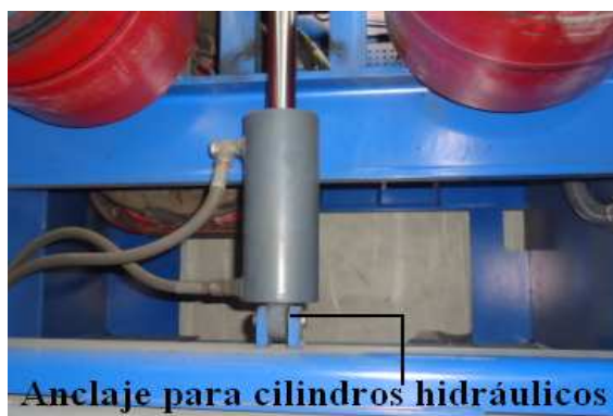
Figura A3.29 Anclaje para cilindros hidráulicos.
