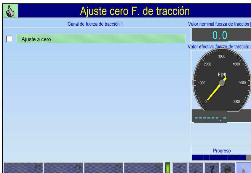
Figura 4.4 Ajuste a cero fuerza de tracción (canal 1).
