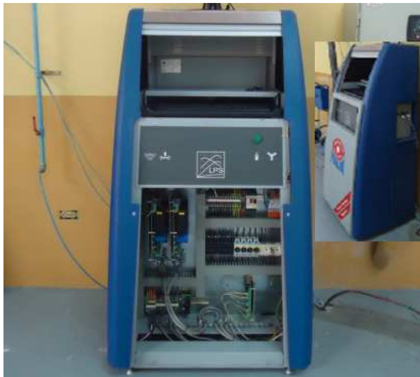
Figura 3.6 Sistema electrónico del dinamómetro de chasis LPS 3000.
