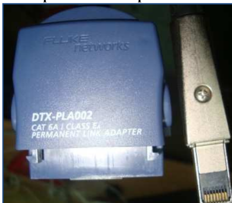
Figura 4-27 Adaptador de enlace permanente DTX-PLA002
