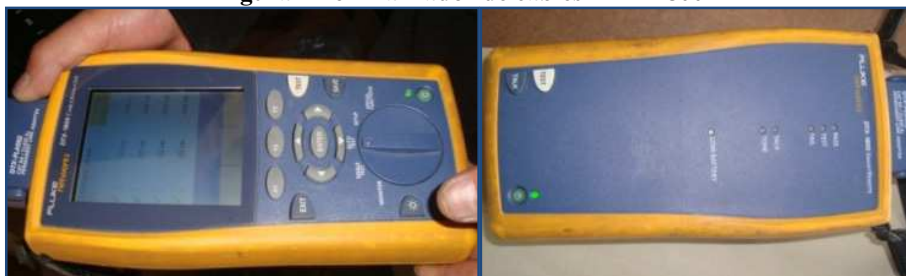
Figura 4-26 Analizador de cables DTX-1800
