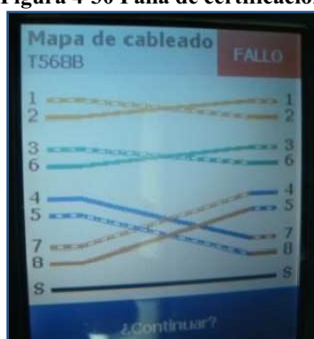
Figura 4-30 Falla de certificación
