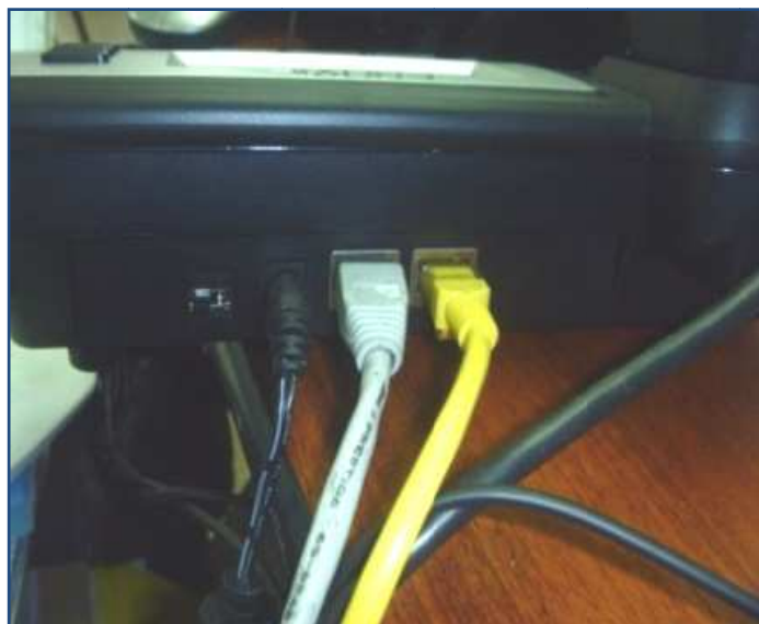
Figura 2-8 Conexiones (de izquierda a derecha): Alimentación eléctrica, a la PC, al Switch.
