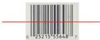
Figura 1.50 Dirección del láser en luz unidireccional
