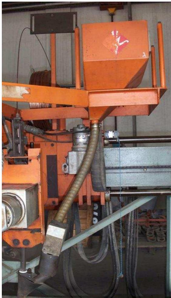
**Figura 2.9.** Componentes del dosificador de fundente.
