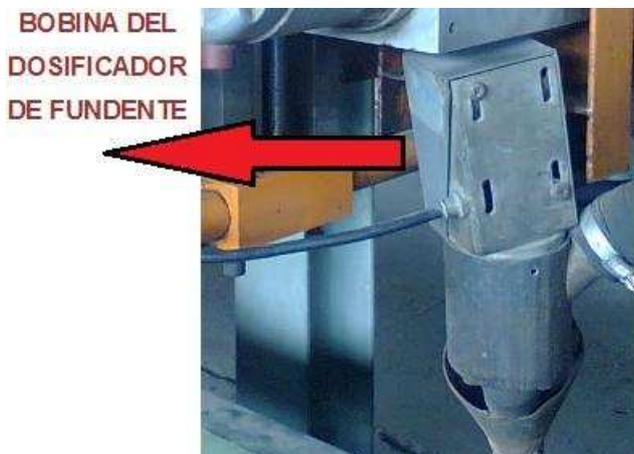
**Figura 4.16.** Bobina del dosificador de fundente.
