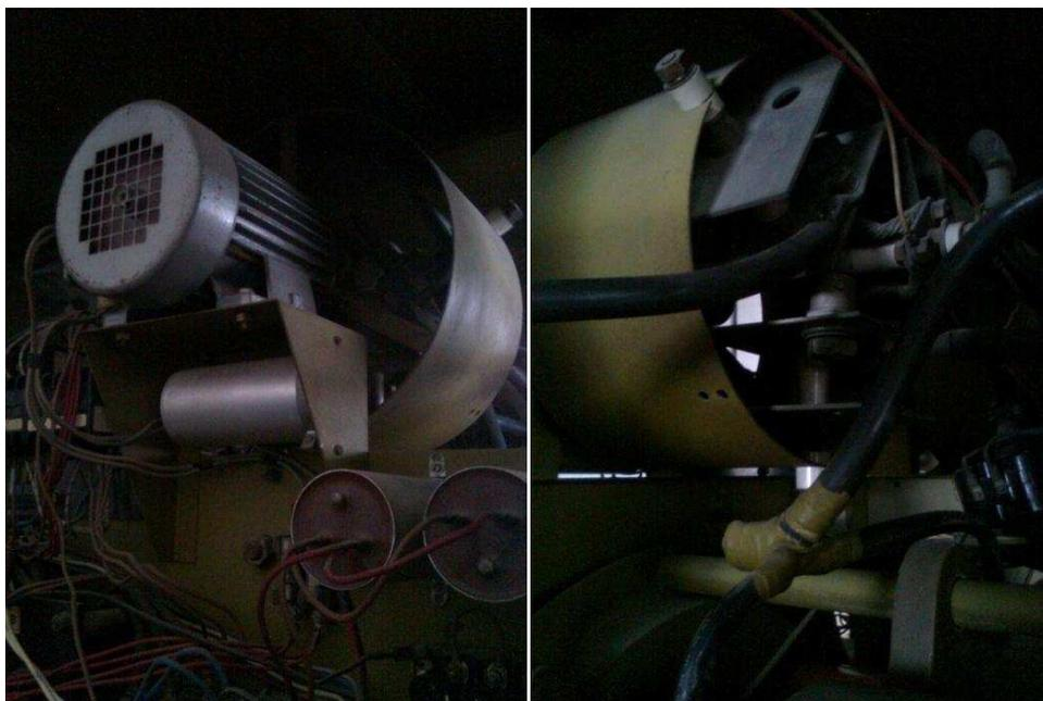
**Figura 2.3.** Motor acoplado a ventilador y puente trifásico no controlado.
