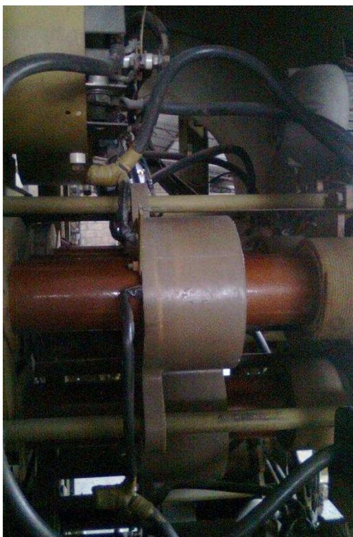
**Figura 2.4.** Núcleo móvil del transformador de suelda.
