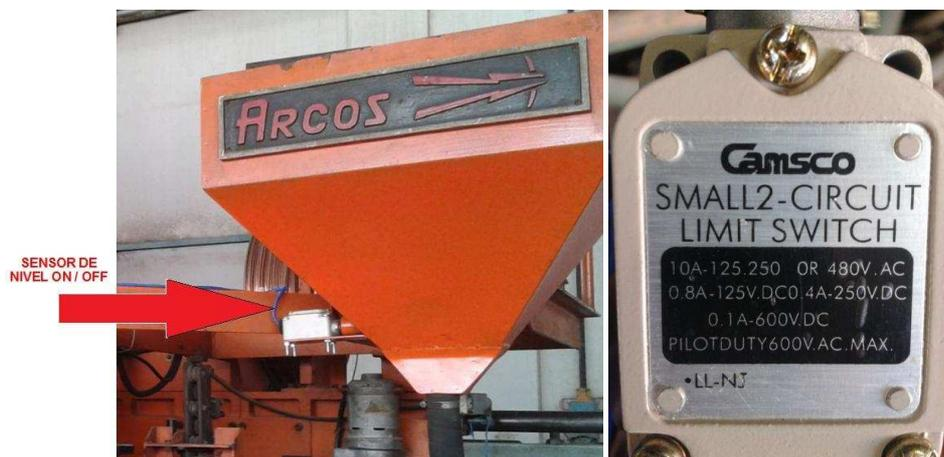
**Figura 4.12.** Sensor de nivel ON/OFF instalado en la tolva de fundente.
