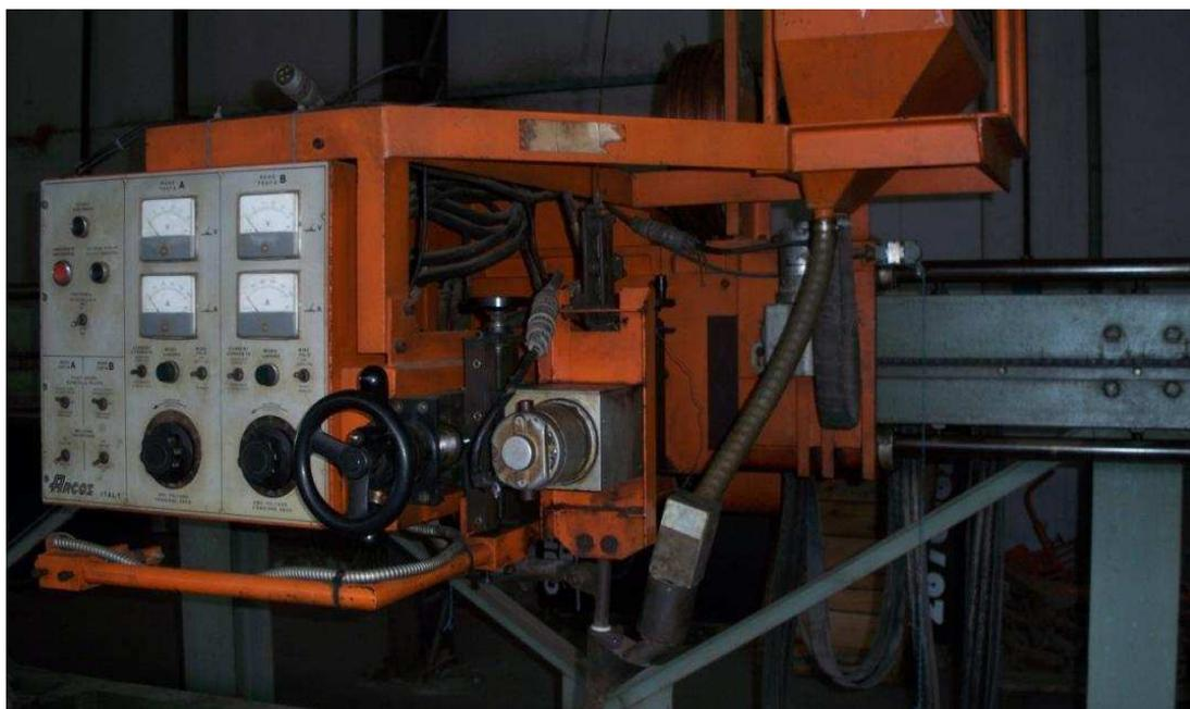
**Figura 2.6.** Cabezal de la máquina soldadora industrial.
