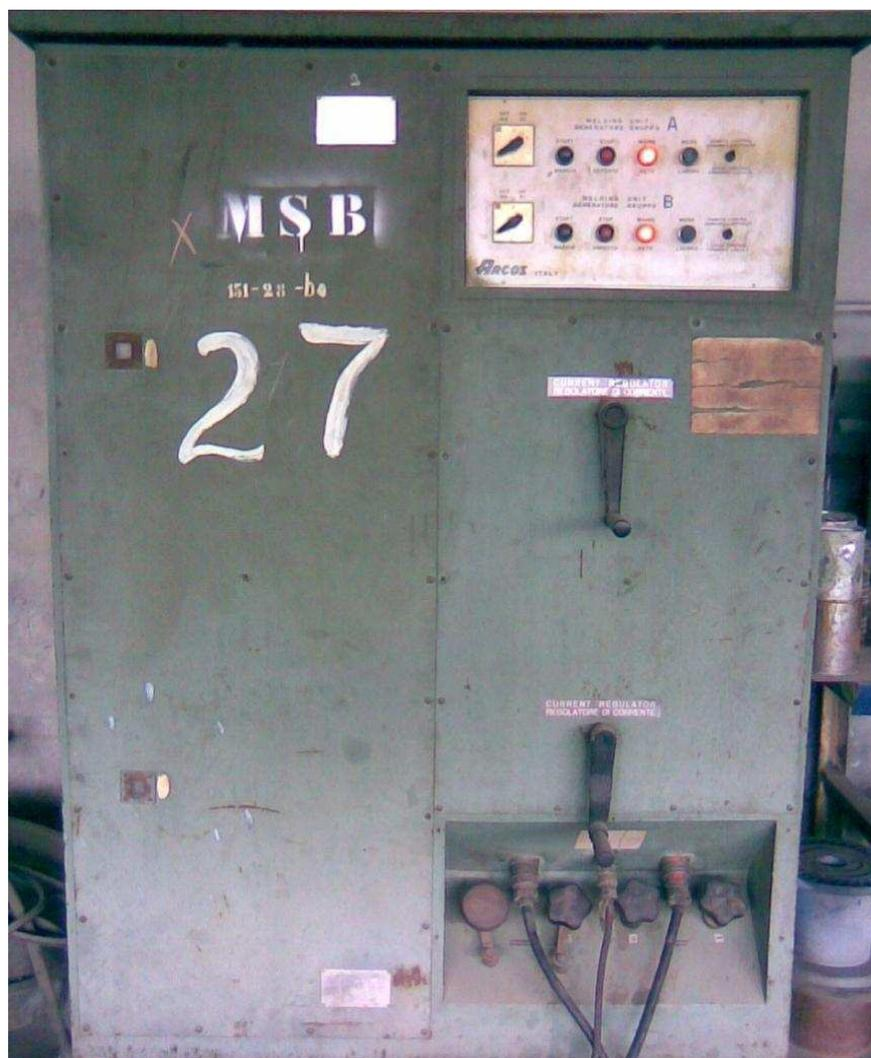
**Figura 2.1.** Transformador – Rectificador.
