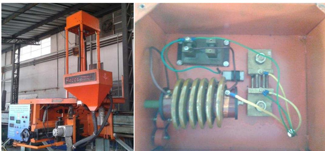
**Figura 4.17.** Torre construida y circuito de control de transformador de suelda.
