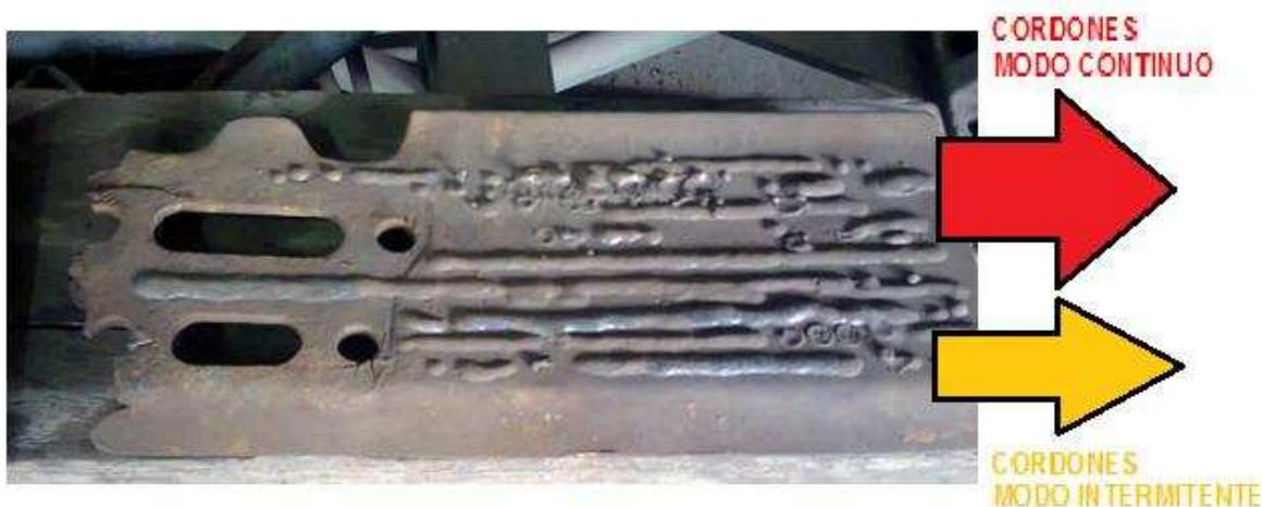
**Figura 4.5.** Cordones realizados sobre una zapata con el sistema original.
