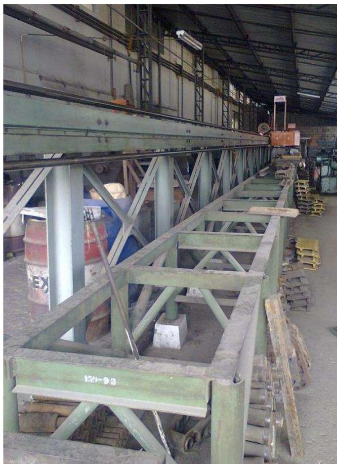
**Figura 2.5.**Bastidor de la soldadora industrial en línea recta.
