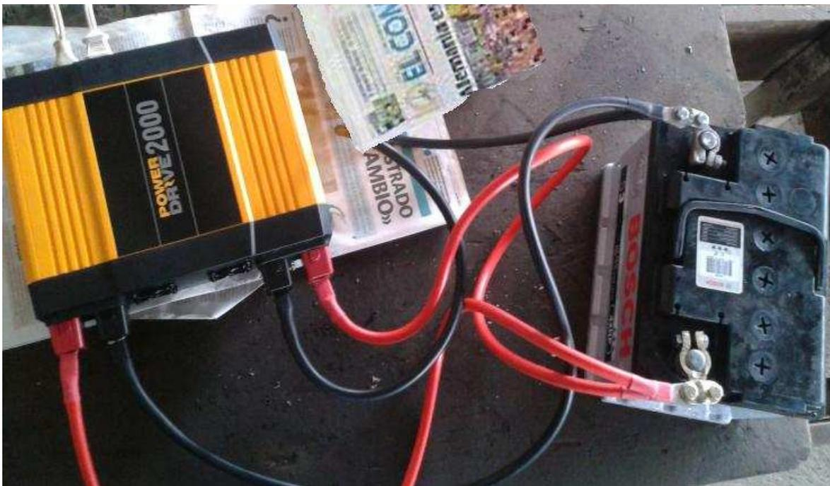
**Figura 4.20.** Inversor de voltaje y batería de 12 [V] utilizados en las pruebas de soldadura.
