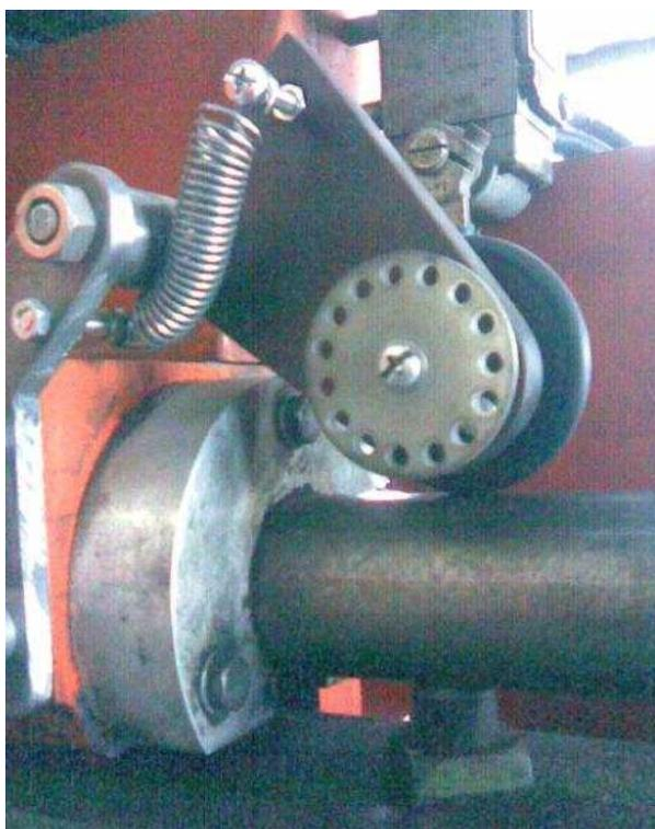
**Figura 3.1.** Encoder montado en el cabezal de suelda.
