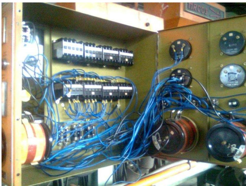
**Figura 4.3.** Circuito de control de la pistola B.
