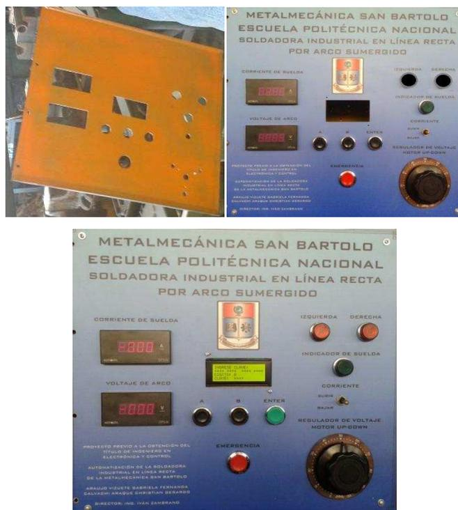
**Figura 3.26.** Instalación del panel frontal.
