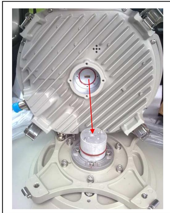
Fig. 2.27 Instalación de la ODU
