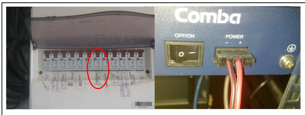
Fig. 2.37 Conexión de energía de la IDU
