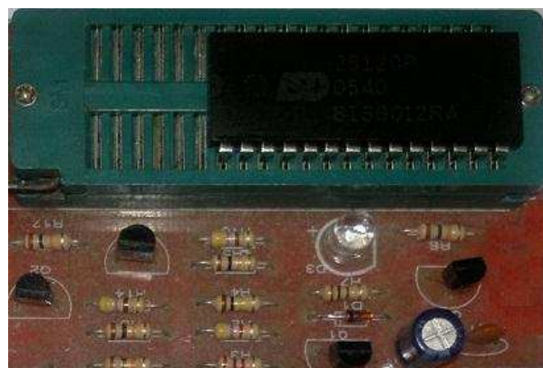
Figura 2.29 Imagen del producto terminado del Módulo de tasa de crecimiento (MTC) con la ubicación del ISD25120 para su grabación [16] .
