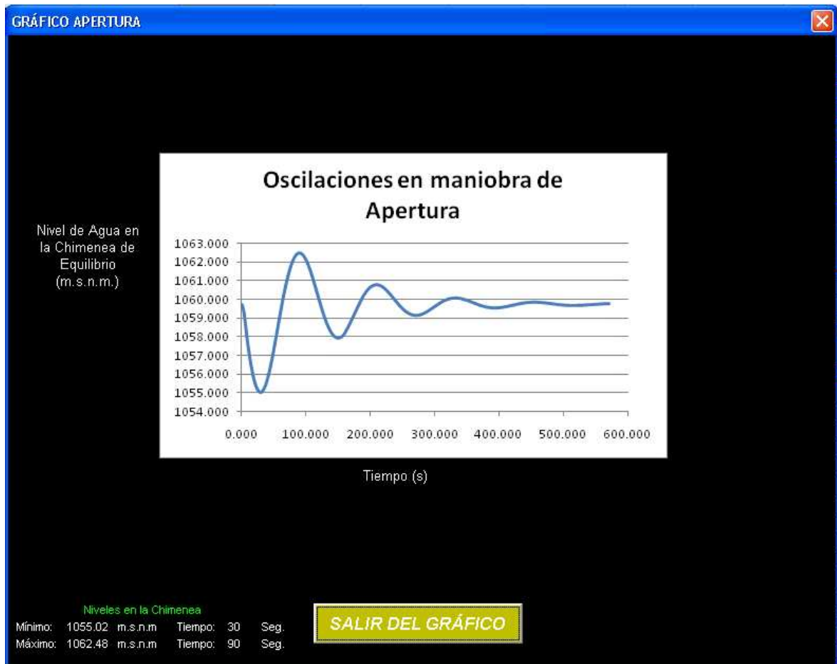
Figura 6.27. Gráfico de las oscilaciones de agua dentro de la chimenea de equilibrio para una maniobra de apertura, nivel mínimo en el embalse y mínimo caudal turbinado
