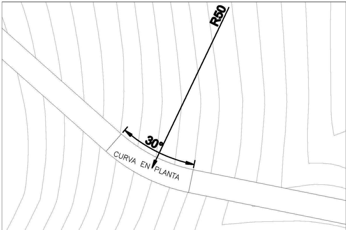
Figura 6.10. Vista en planta de la curva
