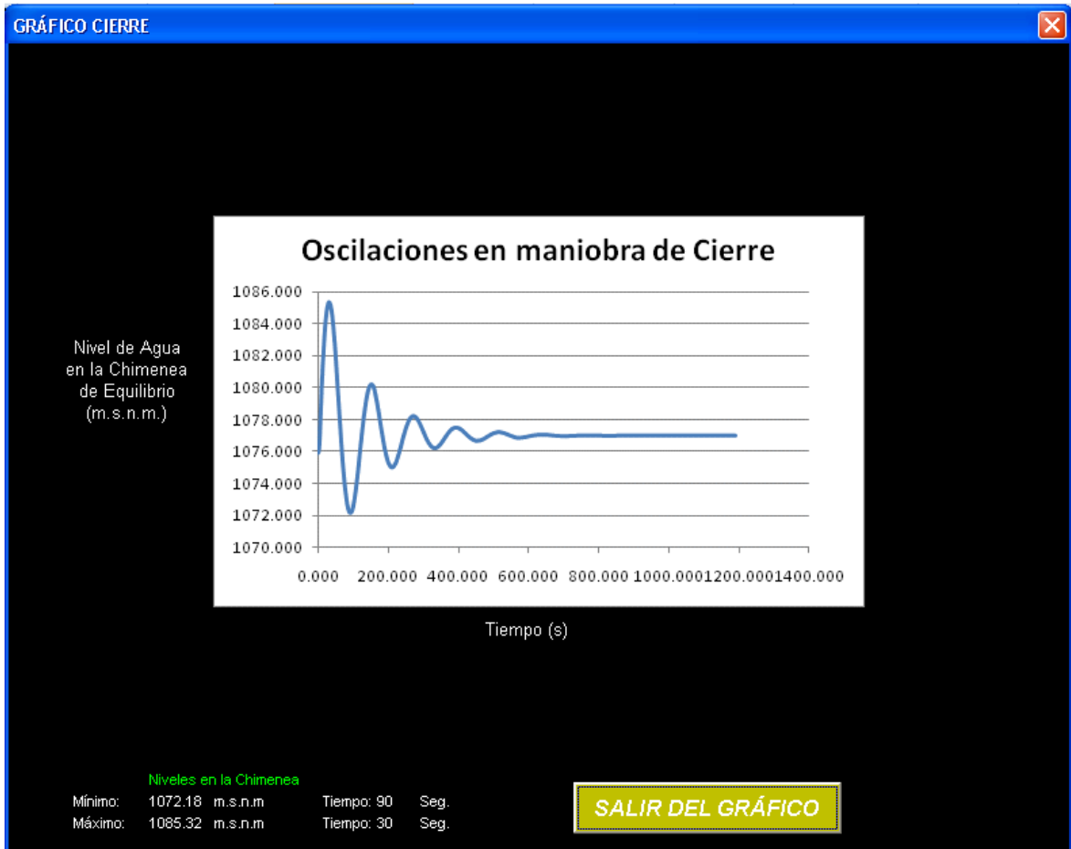
Figura 6.24. Gráfico de las oscilaciones de agua dentro de la chimenea de equilibrio para una maniobra de cierre, nivel máximo en el embalse y máximo caudal turbinado.
