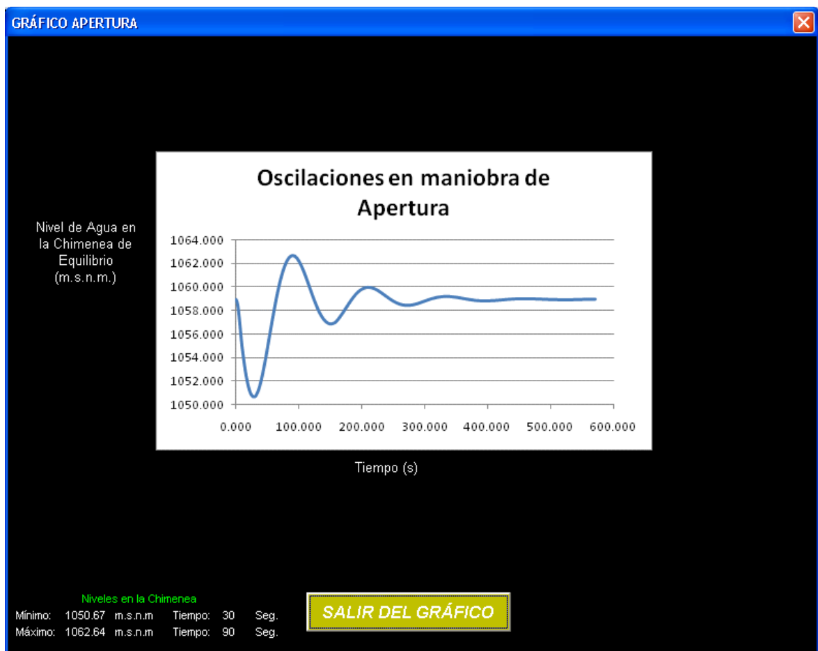
Figura 6.25. Gráfico de las oscilaciones de agua dentro de la chimenea de equilibrio para una maniobra de apertura, nivel mínimo en el embalse y máximo caudal turbinado
