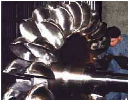
Gráfico 3.13. Rodete de una turbina Pelton. Fuente: 60
