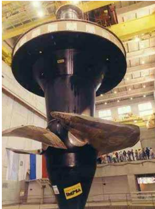
Gráfico 3.10. Turbina de reacción tipo Kaplan. Fuente 57
