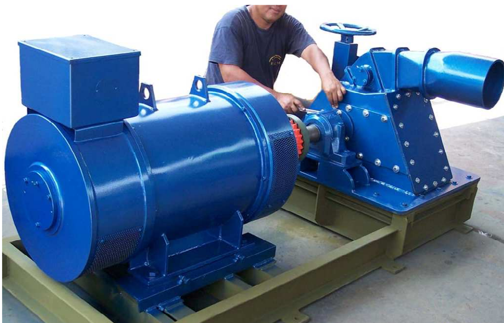
Gráfico 3.21.-Generador eléctrico conectado con un acople directo a una turbina hidráulica. Fuente: 84
