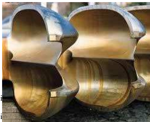
Gráfico 3.13. Rodete de una turbina Pelton. Fuente: 60
