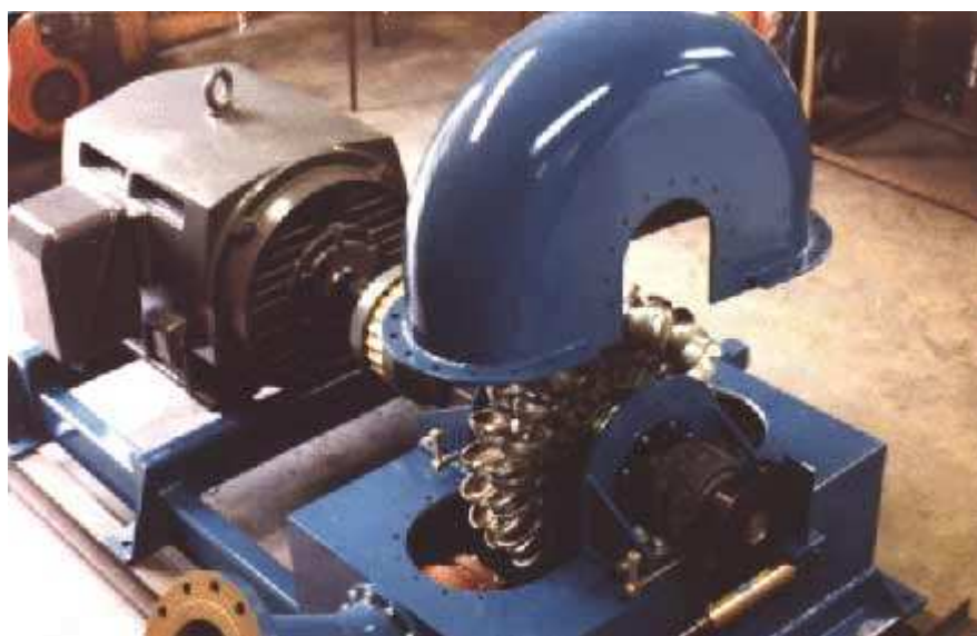
Gráfico 3.15 Carcasa y rodete de una turbina Pelton. Fuente: 62
