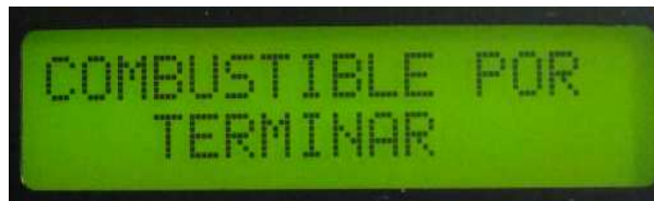
Figura 2.19 Cuando el tanque esta vacio y quedarce sin gasolina.
