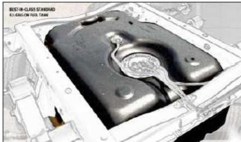
Figura 1.4 Tanque de combustible
