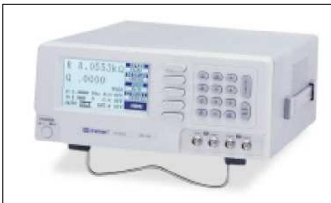
Figura 4. 2: Medidor LCR 819<sup>63</sup>.
