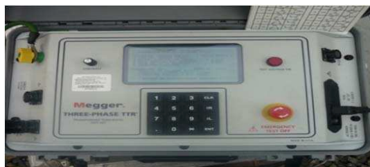
Figura 3.19. Equipo para medición de relación de transformación.
