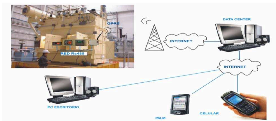
Figura 5.6. Arquitectura de Comunicación del Sistema de Monitoreo.
