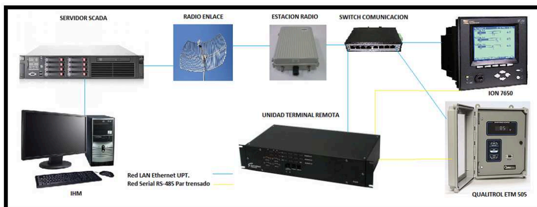
Figura 5.14. Estructura de comunicación de equipos para la transmisión de datos.
