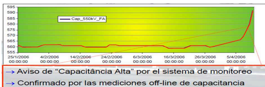
Figura 4.21. Detección de fallo en por tendencia de Capacitancia.
