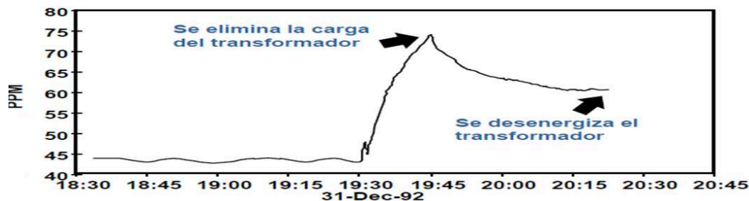
Figura 4.23. Tendencia de presencia de Hidrógeno generado por falla en un OLTCs. [106]
