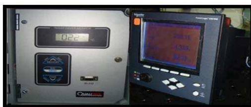
Figura. 5.13. Equipo empelado, Medidor QUALITROL ETM 505 y ION 7650.
