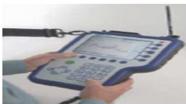
Figura 4.14. Receptor de señales RFI (Antena) marca DOBLE. [106]
