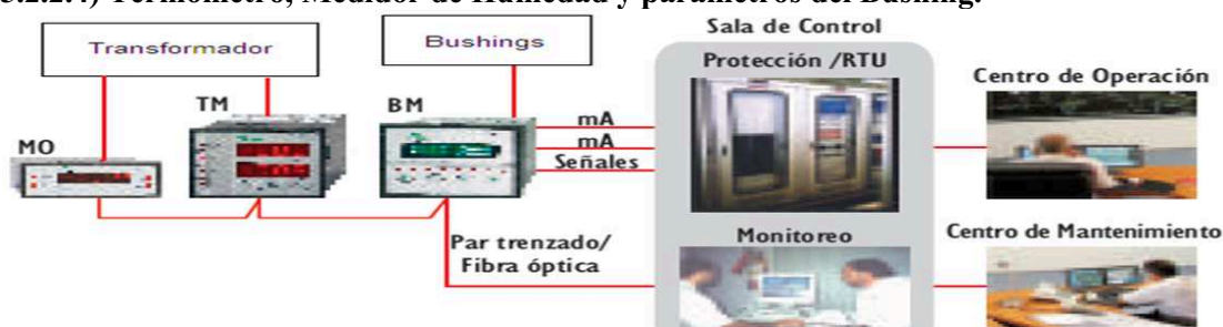
Figura 5.12. Módulo con Termómetro, Medidor de Humedad y Bushings.
