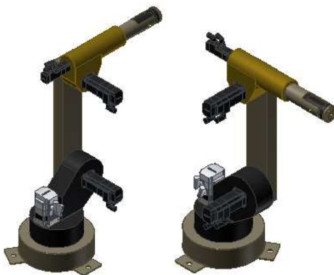
Figura 7-2: Geometría del robot con los servomotores instalados.
