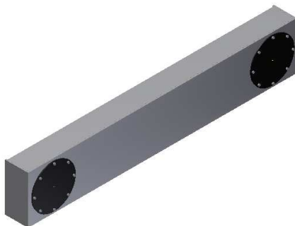
Figura 3-3: Aproximación del diseño estructural del eslabón brazo.
