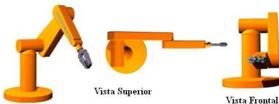
Figura 2-6: Configuración del Robot angular tipo “Puma”. 29
