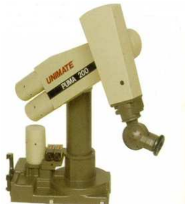
Figura 2-10: Robot Unimate PUMA 200, con configuración de brazo distante. 33
