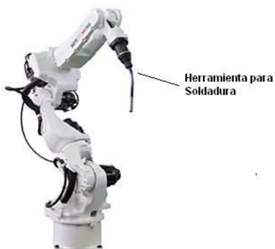
Figura 1-5: Herramienta para Soldadura en un robot Industrial. 14
