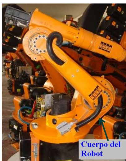
Figura 2-8: Robot KUKA KR15 con cuerpo de menor altura y desplazado. 31
