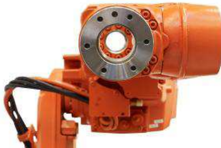
Figura 2-12: Acople para efectores finales de un robot ABB IRB2600ID.
