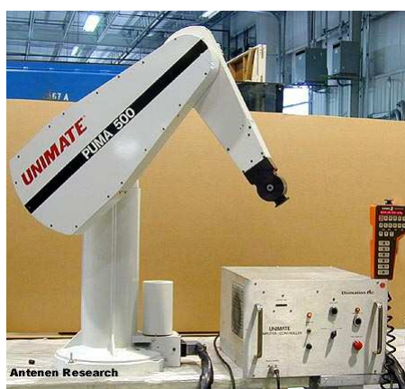
Figura 2-7: Robot Unimate PUMA 500, con cuerpo de altura vertical en referencia a su base. 30
