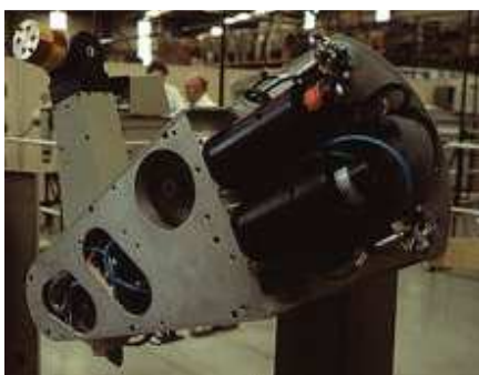
Figura 2-9: Antebrazo de un Unimate PUMA. 32
