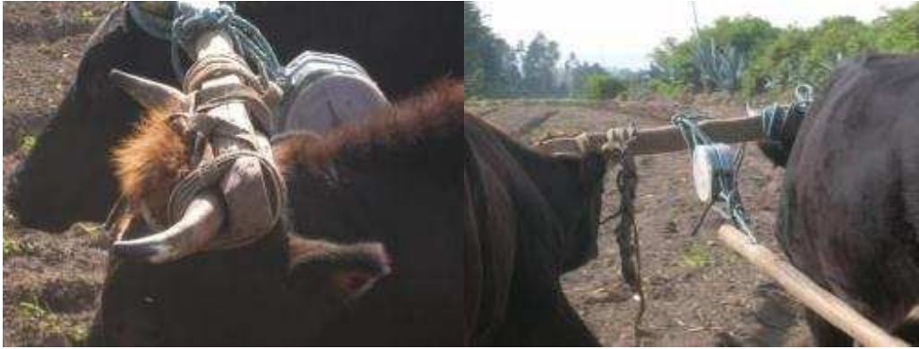
Figura 4.3 Adaptación de los dinamómetros en el mecanismo de labranza con yunta
