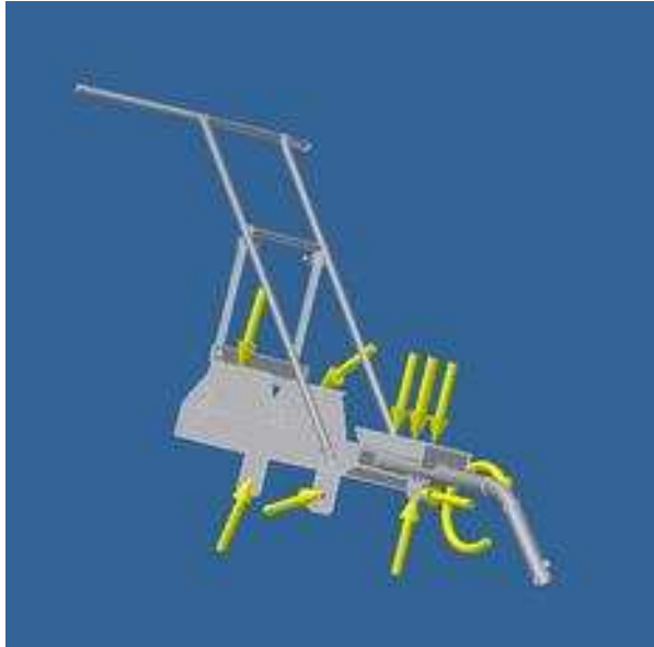
Figura 4.36 Esquema de la colocación de cargas en la estructura
