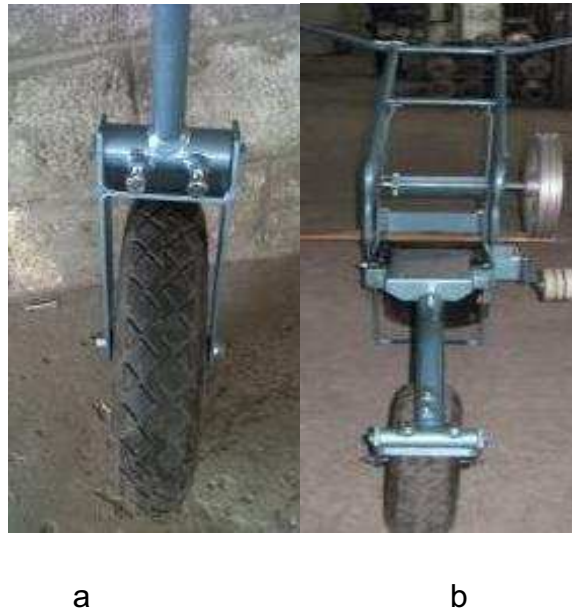
Figura 5.7 a) Rueda delantera b) Estructura
