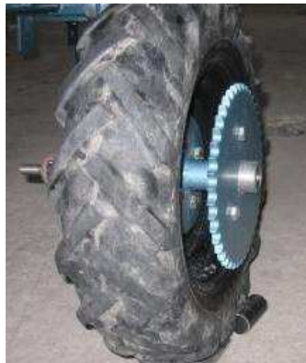
Figura 5.6 Montaje de la rueda de tracción
