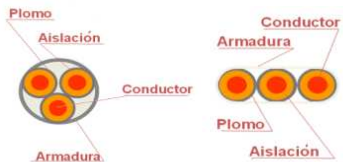
FIGURA 4.24 PARTES DE UN CABLE DE POTENCIA
