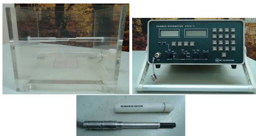
Figura 3.3: Equipos utilizados para la calibración del haz de radiación
