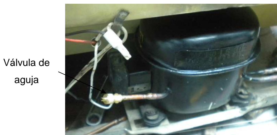
Figura 5.8. Válvula de aguja en la zona de alta
