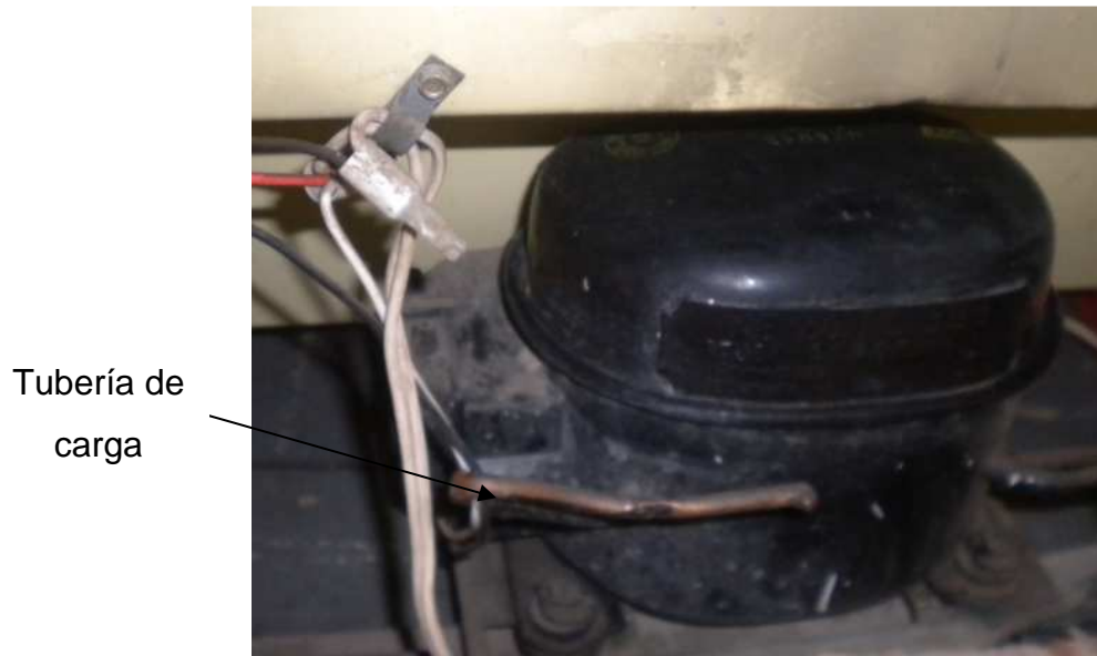
Figura 5.1. Compresor con la tubería de carga original
