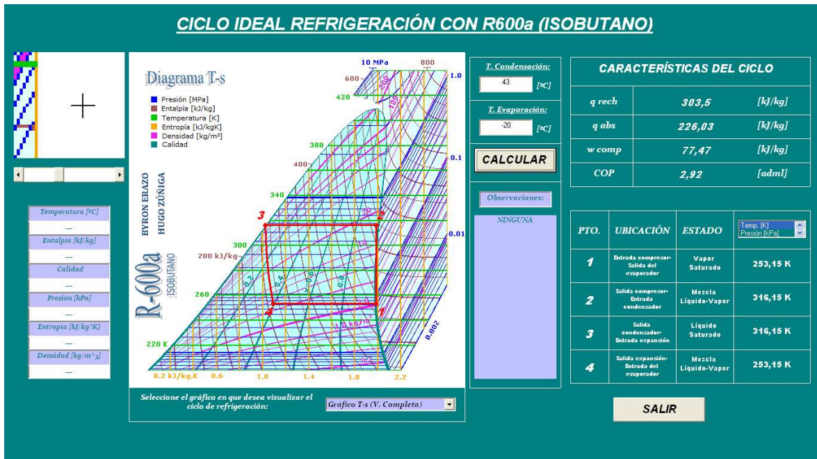
Figura 4.10. Pantalla Ciclo de refrigeración con R-600a
