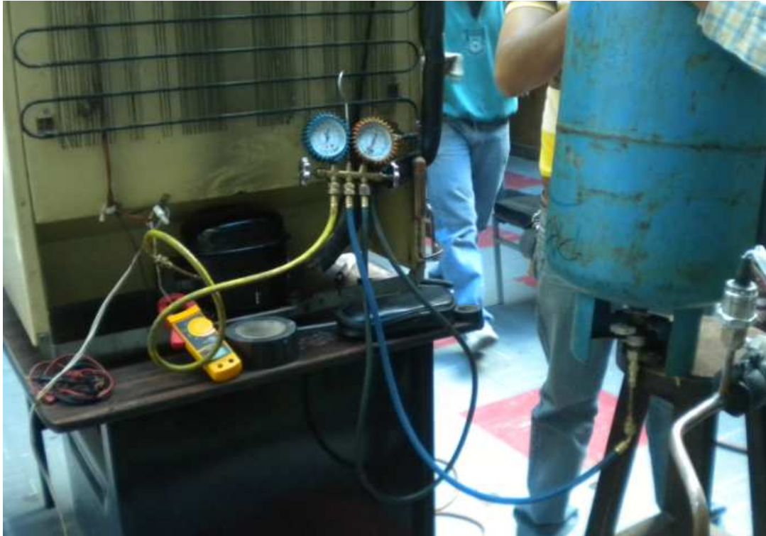
Figura 5.16. Carga del propano
