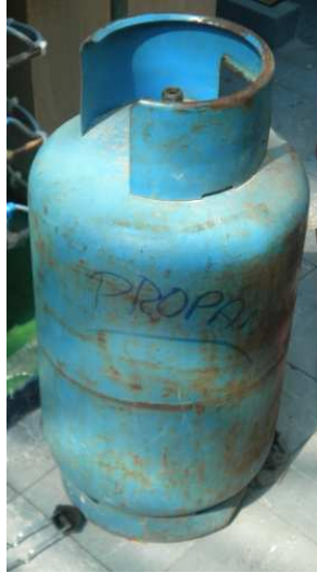
Figura 5.15. Cilindro de gas propano
