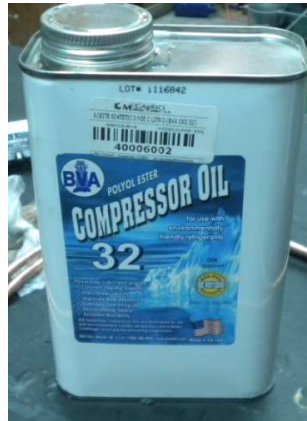
Figura 5.10. Aceite sintético para R-134a
