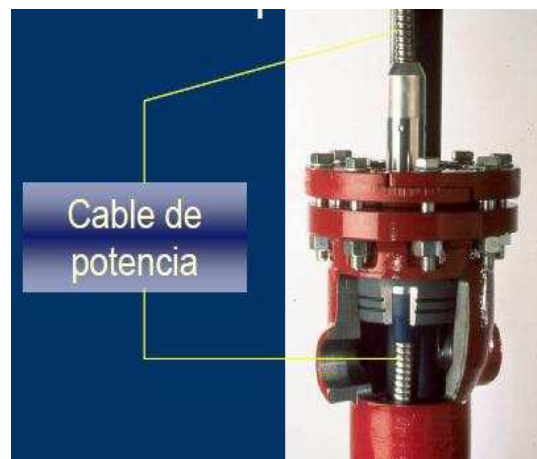
Figura 2.18 CONEXIÓN DEL CABLE DE POTENCIA
