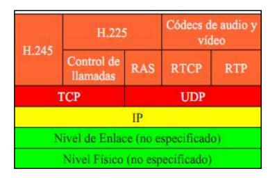
Figura 1-12 Pila de Protocolos H.323 [12]
