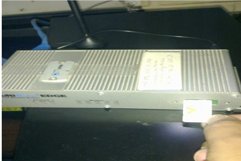
Figura 4.32 Router Multitech con SIM.
