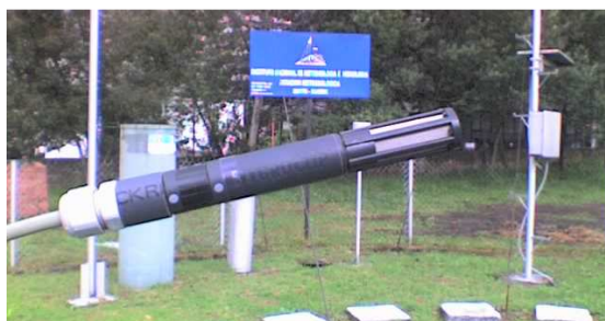
Figura 1.7 Sensor de Humedad Relativa Hygroclip.
