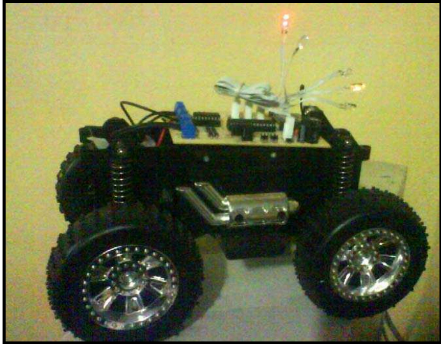
Figura 2.33. Implantación del Circuito Receptor (Vista Lateral)
