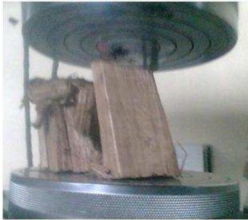
**Probeta de madera sometida a ensayo de compresión**
