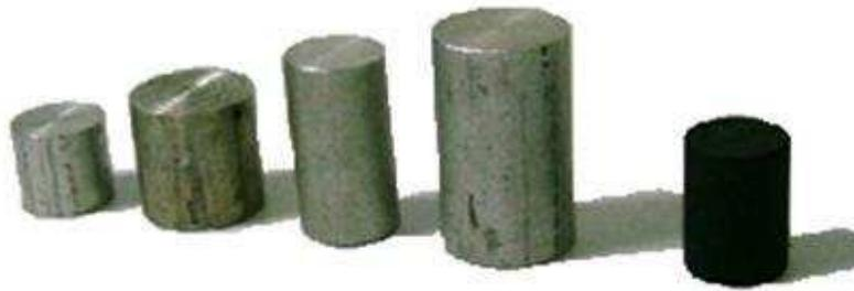
**Figura 1.6.** Probeta ensayo de compresión.<sup>6</sup>
