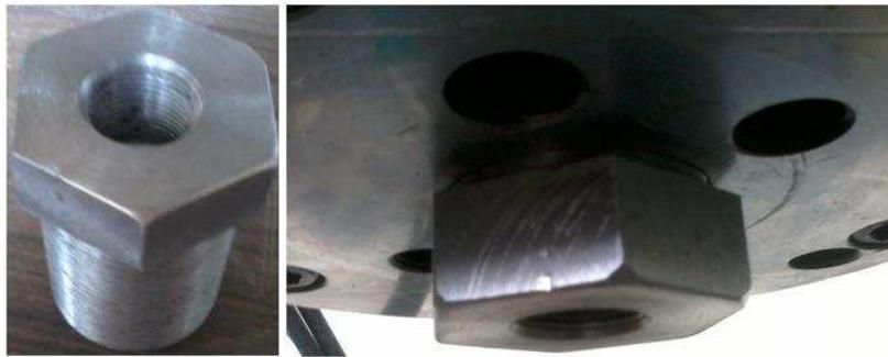
**Dado de sujeción colocado en plato de la celda de carga**
