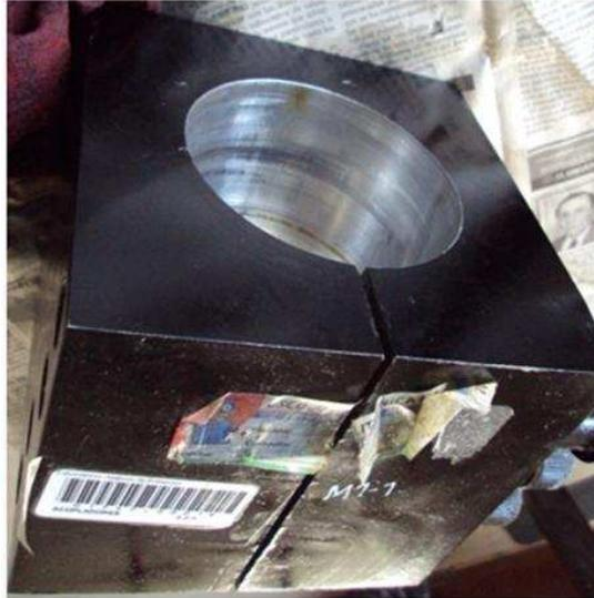
**Figura E.6.** Acople de actuador rotacional y lineal.
