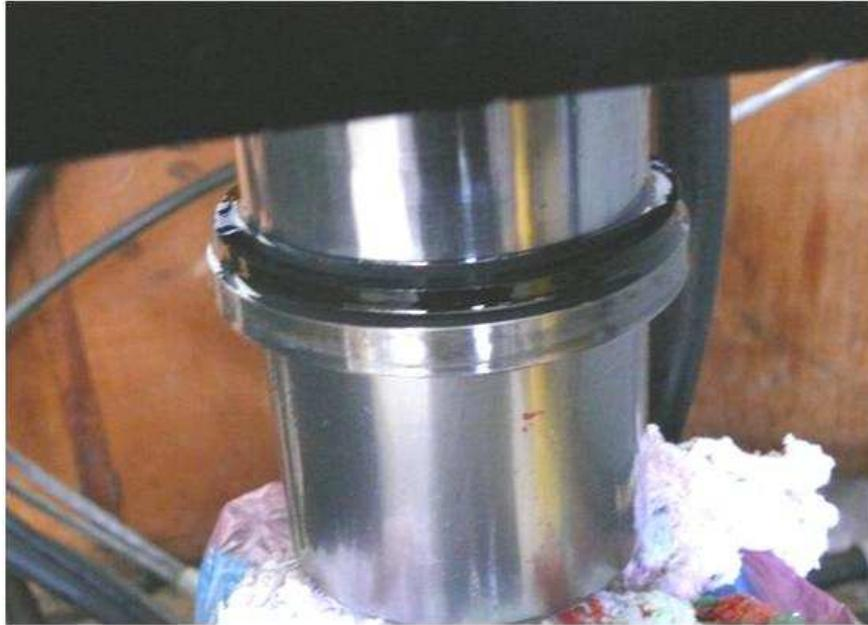
**Figura F.4.** Salida de los sellos de baja presión del actuador lineal.
