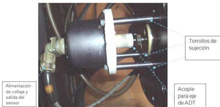
**Figura 4.2.** ADT montado al actuador.
