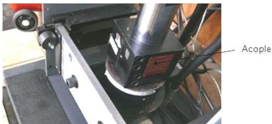
**Figura E.3.** Acople entre actuador rotacional y lineal.
