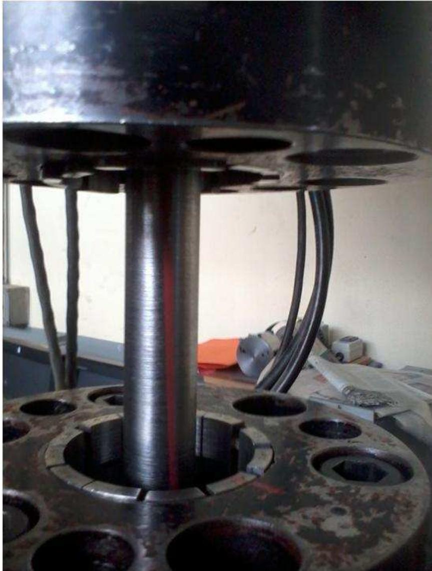
**Figura 4.10.** Probeta deformada.
