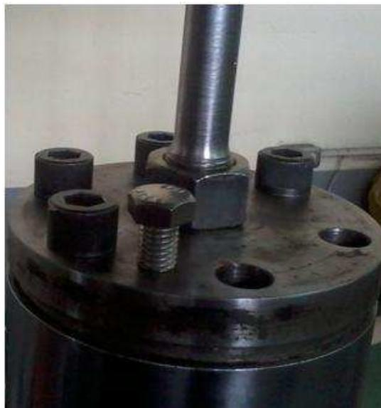
**Probeta asegurada para ensayo de tracción**
