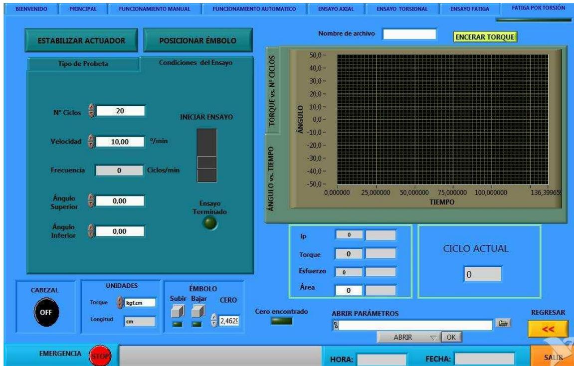
Figura 3.17. Pantalla para el ensayo de fatiga por torsión.
