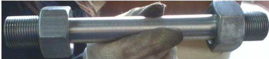
**Colocación de tuercas en probeta**
