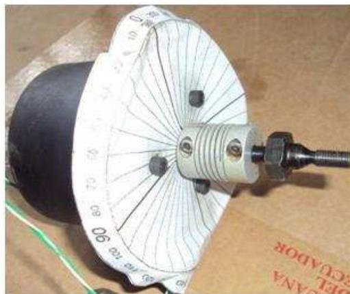
**Figura 2.11.** ADT desmontado y con graduador.
