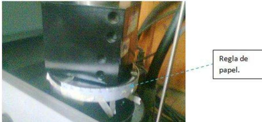
**Figura 4.3.** Actuador rotacional con regla incorporada.
