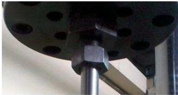
**Enroscando probeta a dado de sujeción**
