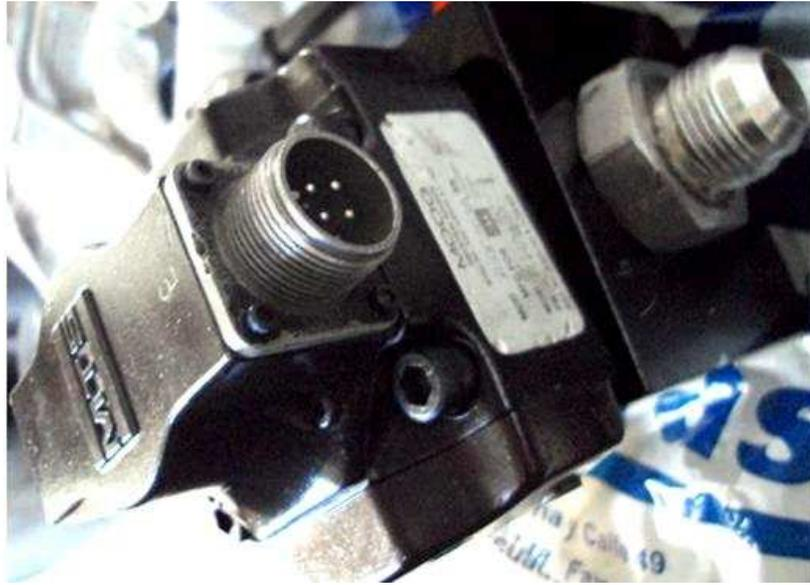
**Figura E.4.** Servo-válvula.
