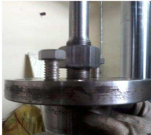
**Enroscando base móvil a probeta**
