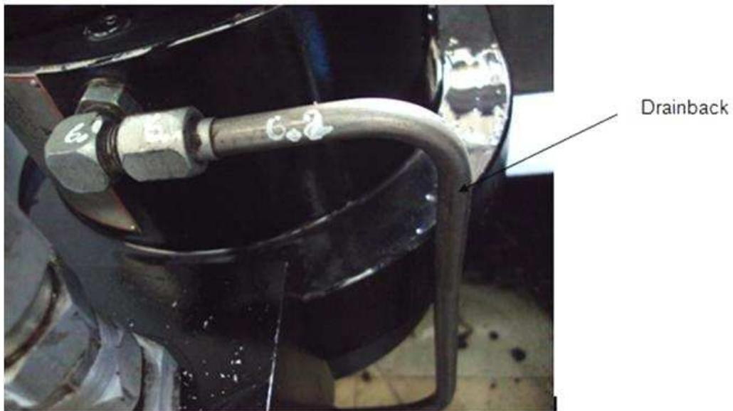
**Figura E.5.** Tubo drainback (drenaje) del actuador rotacional.
