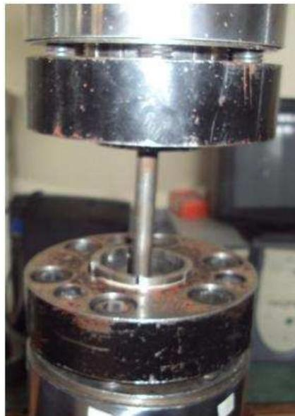
**Probeta colocada en la mordaza de torsión**
