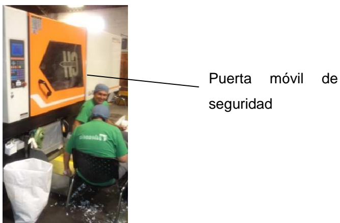
Figura 4.2 Resguarda móvil con bloqueo máquina inyectora
