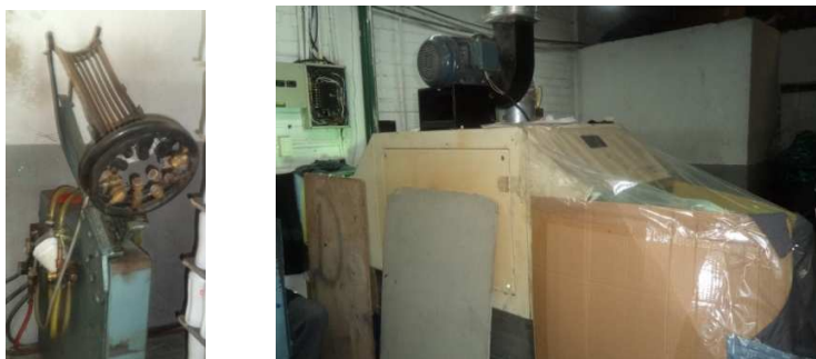
Figura 2.10 Flameador de gas licuado de petróleo y Secador UV para serigrafía
