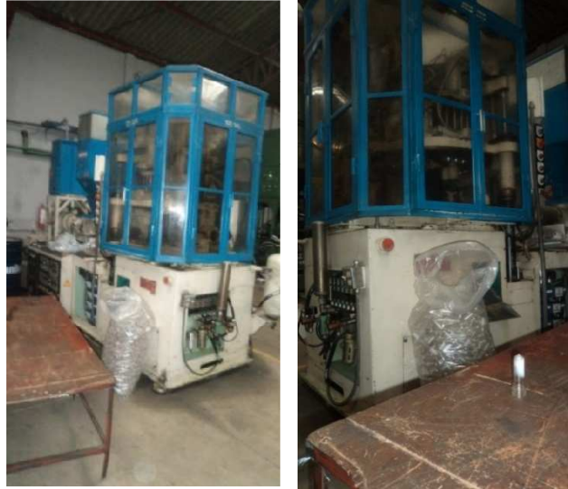
Figura 2.5 Máquina de inyección – soplado de plástico
