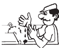
Figura 1.3 Peligro de cizallamiento
