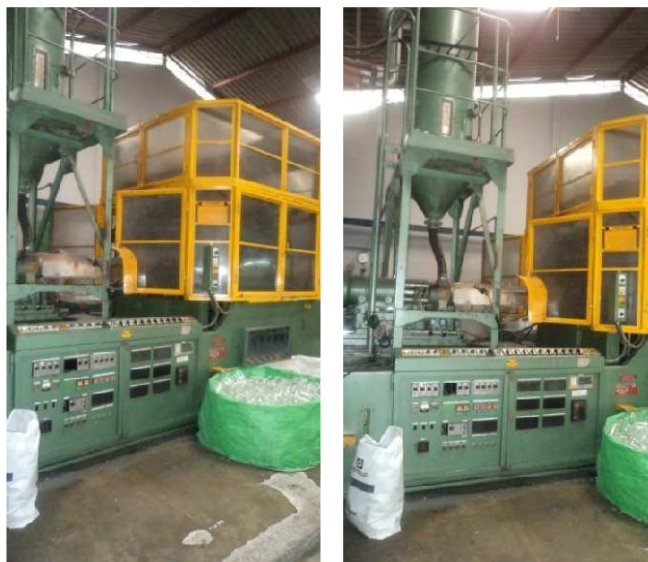
Figura 2.6 Máquinas de extrusión – soplado de plástico
