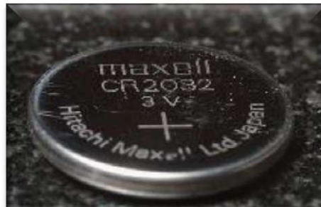
Figura 1.19 Batería de Litio CR2032 3 Voltios
