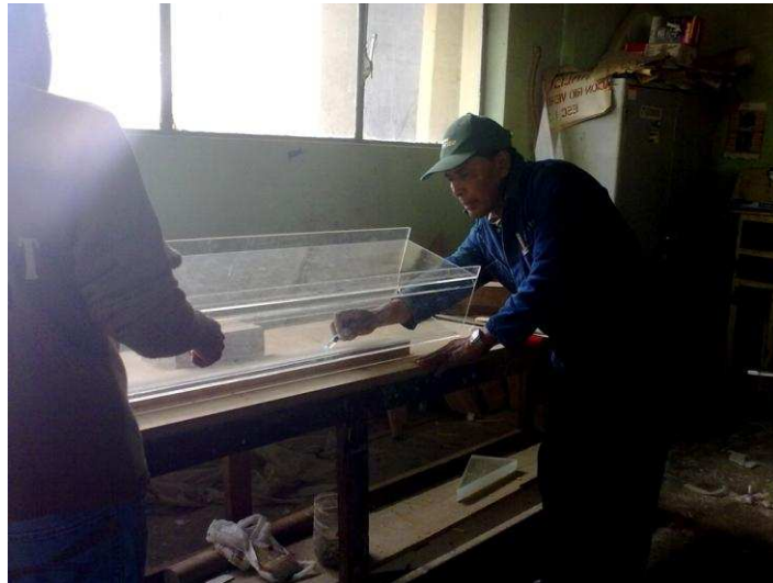
FOTOGRAFÍA No. 5.12: Moldeado en acrílico de la transición.
