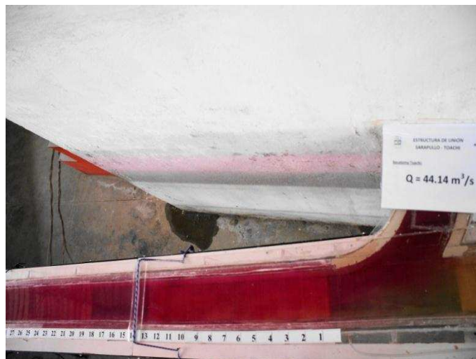
Fotografía No. 44: Estructura de Unión e inicio de la Galería de Interconexión, flujo desde la bocatoma en el embalse Toachi ( Q_T = 44.1 \text{ m}^3/\text{s} ).
