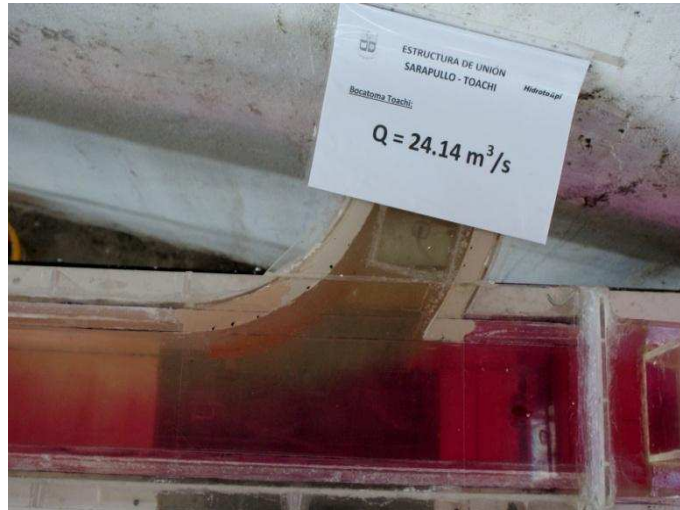
Fotografía No. 26: Características del flujo de aproximación desde el túnel Sarapullo ( Q_S = 13.3 \text{ m}^3/\text{s} ).
