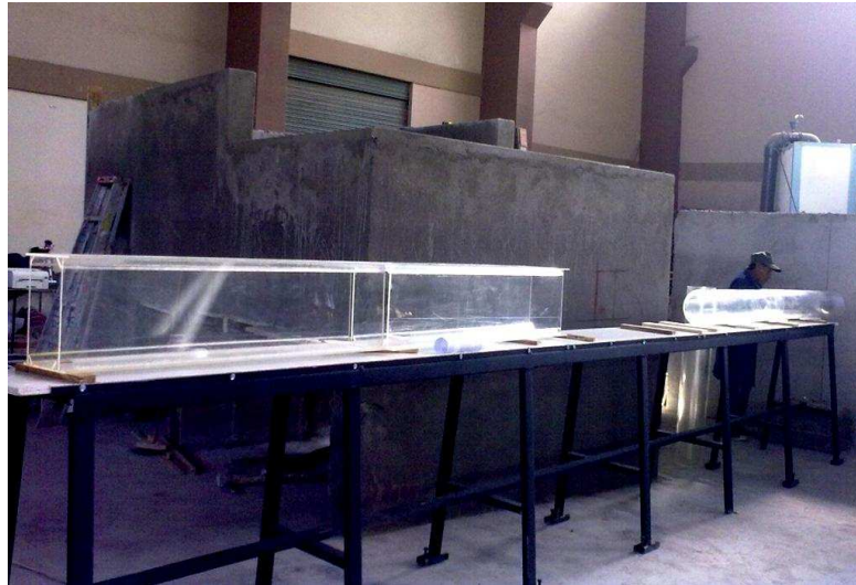
FOTOGRAFÍA No. 5.13: Montaje de piezas en acrílico del modelo.
