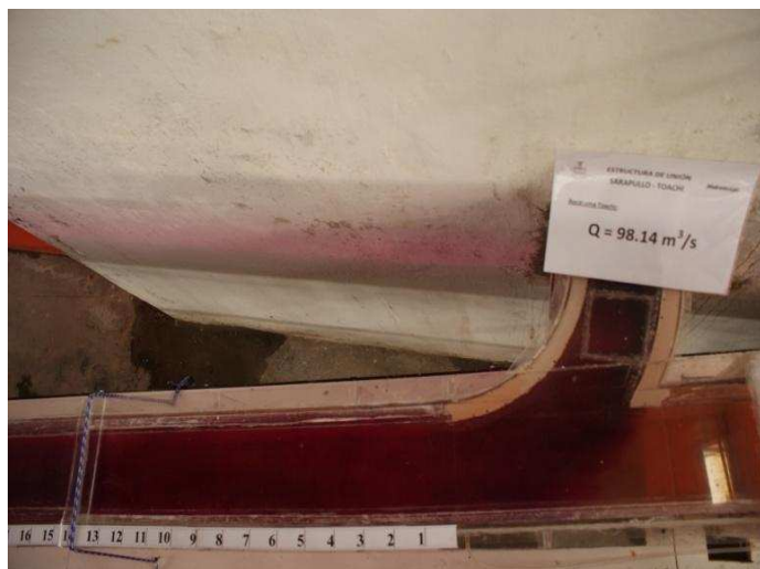
Fotografía No. 50: Estructura de Unión e inicio de la Galería de Interconexión, flujo desde la bocatoma en el embalse Toachi ( Q_T = 98.4 \text{ m}^3/\text{s} ).
