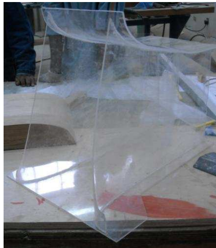
FOTOGRAFÍA No. 5.10: Pieza en acrílico de la Bocatoma de la Presa Toachi.
