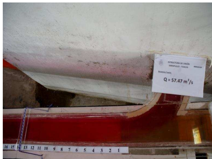
Fotografía No. 46: Estructura de Unión e inicio de la Galería de Interconexión, flujo desde la bocatoma en el embalse Toachi ( Q_T = 57.5 \text{ m}^3/\text{s} ).
