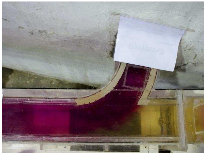
Fotografía No. 31: Características del flujo desde la bocatoma en el embalse Toachi ( Q_T = 31.5 \text{ m}^3/\text{s} ).
