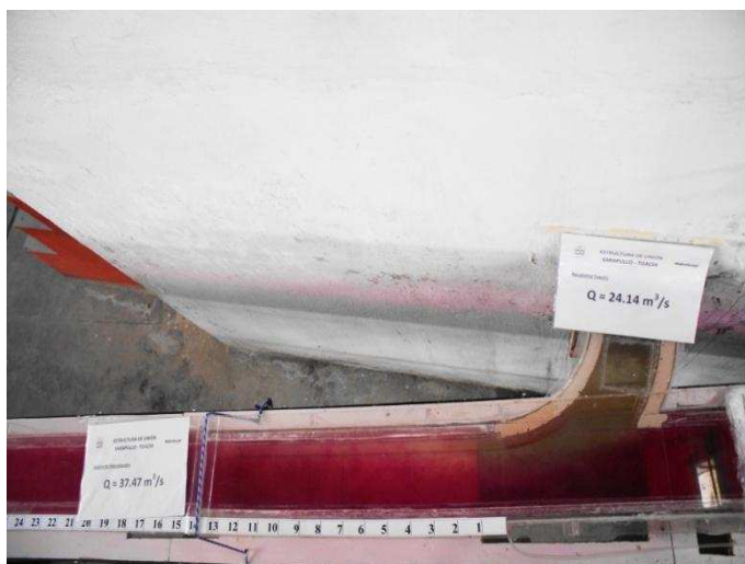
Fotografía No. 41: Estructura de Unión e inicio de la Galería de Interconexión, flujo de aproximación desde el túnel de descarga Sarapullo ( Q_S = 13.3 \text{ m}^3/\text{s} ).
