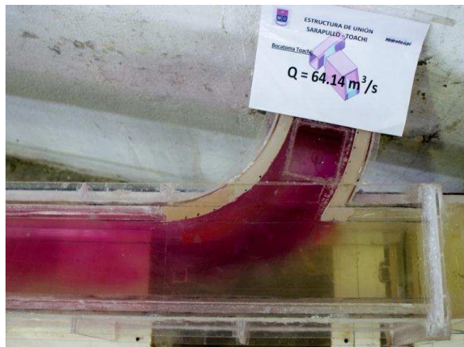
Fotografía No. 23: Características del flujo desde la bocatoma en el embalse Toachi ( Q_T = 64.1 \text{ m}^3/\text{s} ).
