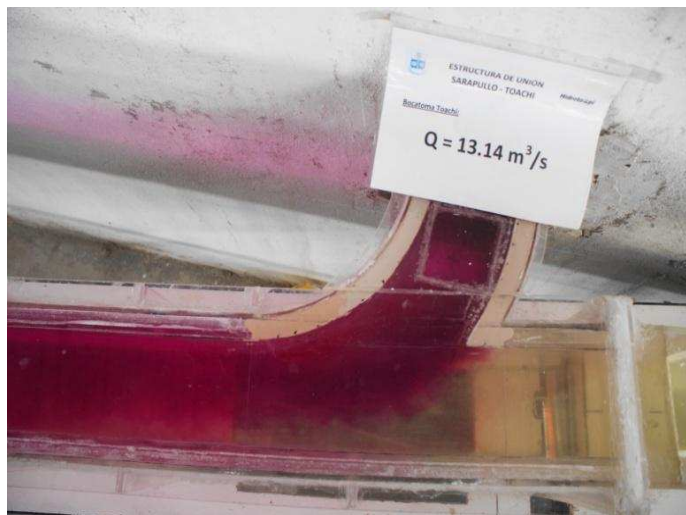
Fotografía No. 25: Características del flujo desde la bocatoma en el embalse Toachi ( Q_T = 13.1 \text{ m}^3/\text{s} ).
