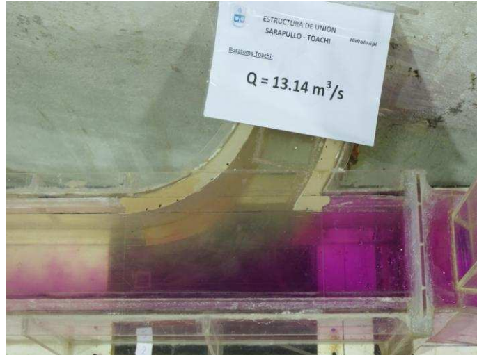
Fotografía No. 14: Características del flujo de aproximación desde el túnel Sarapullo ( Q_S = 6.0 \text{ m}^3/\text{s} ).
