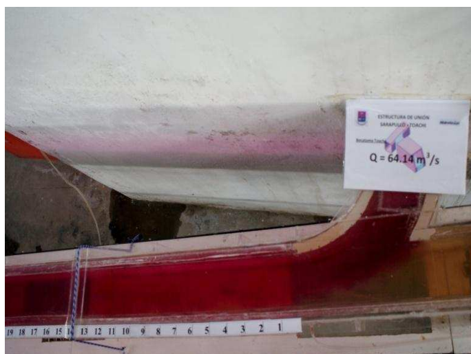
Fotografía No. 48: Estructura de Unión e inicio de la Galería de Interconexión, flujo desde la bocatoma en el embalse Toachi ( Q_T = 64.1 \text{ m}^3/\text{s} ).
