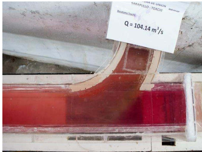
Fotografía No. 38: Características del flujo desde la bocatoma en el embalse Toachi ( Q_T = 104.7 \text{ m}^3/\text{s} ).
