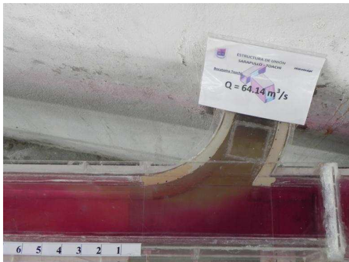
Fotografía No. 39: Características del flujo de aproximación desde el túnel de descarga Sarapullo ( Q_S = 40.0 \text{ m}^3/\text{s} ).
