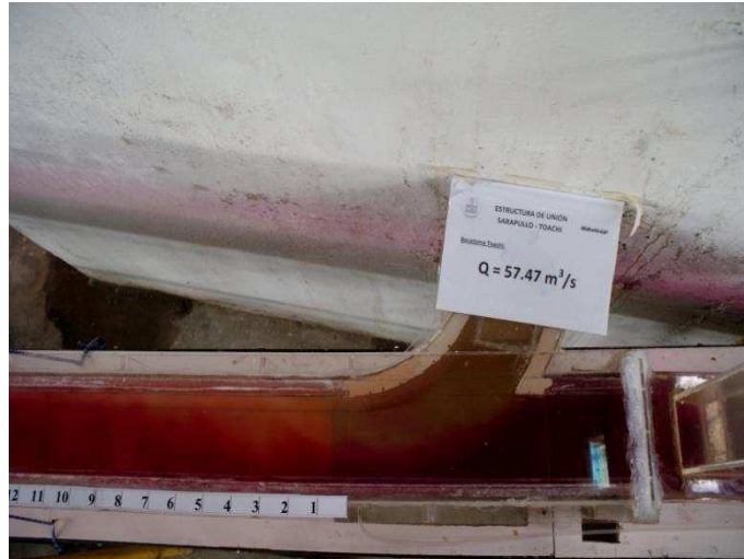
Fotografía No. 45: Estructura de Unión e inicio de la Galería de Interconexión, flujo de aproximación desde el túnel de descarga Sarapullo ( Q_S = 13.3 \text{ m}^3/\text{s} ).
