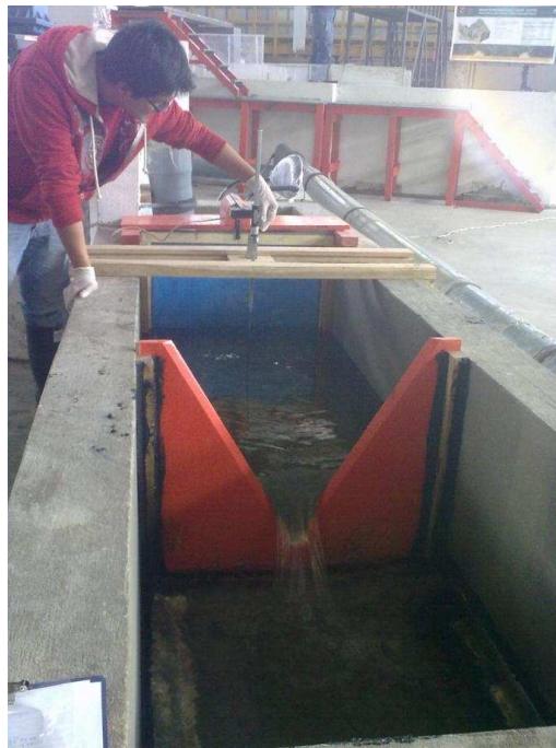
Fotografía No. 13: Vista frontal del vertedero triangular de medida del caudal total (ubicado en el canal de descarga del modelo).
