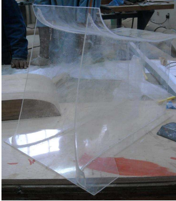
Fotografía No. 7: Detalle del modelo en acrílico de la bocatoma desde el embalse Toachi.
