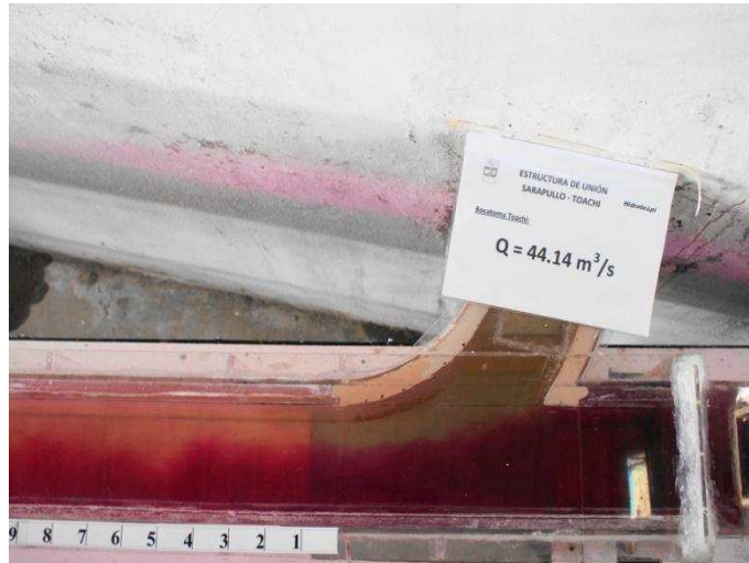
Fotografía No. 43: Características del flujo de aproximación desde el túnel de descarga Sarapullo ( Q_S = 26.7 \text{ m}^3/\text{s} ).
