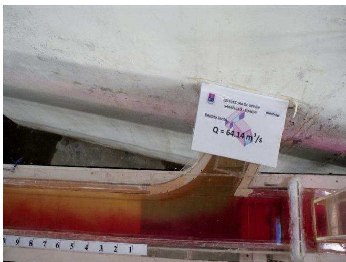
Fotografía No. 47: Características del flujo de aproximación desde el túnel de descarga Sarapullo ( Q_S = 26.7 \text{ m}^3/\text{s} ).
