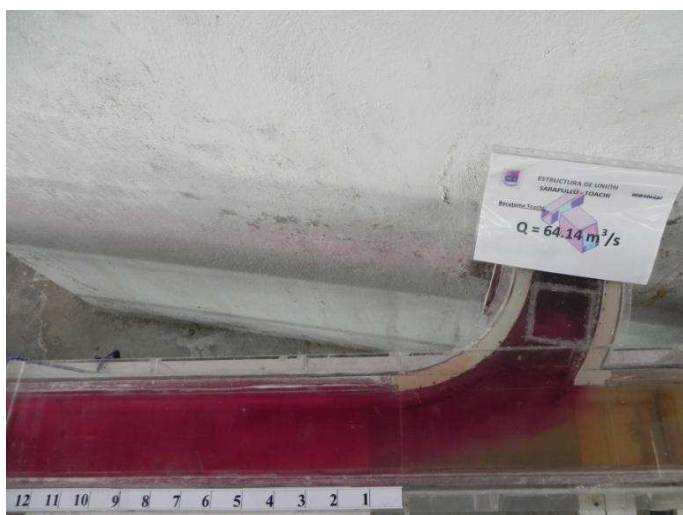
Fotografía No. 40: Estructura de Unión e inicio de la Galería de Interconexión, flujo desde la bocatoma en el embalse Toachi ( Q_T = 64.1 \text{ m}^3/\text{s} ).
