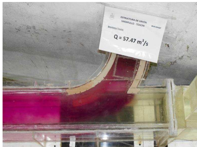
Fotografía No. 21: Características del flujo de entrada desde la bocatoma en el embalse Toachi ( Q_T = 57.5 \text{ m}^3/\text{s} ).
