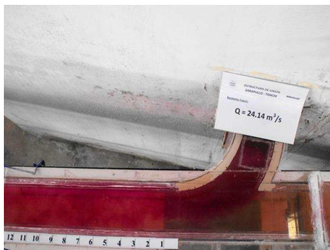
Fotografía No. 42: Características del flujo desde la bocatoma en el embalse Toachi ( Q_T = 24.1 \text{ m}^3/\text{s} ).
