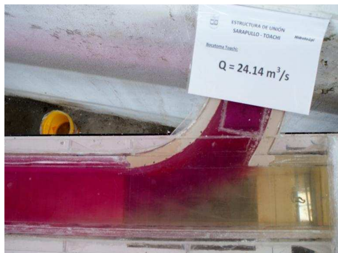
Fotografía No. 27: Características del flujo desde la bocatoma en el embalse Toachi ( Q_T = 24.1 \text{ m}^3/\text{s} ).
