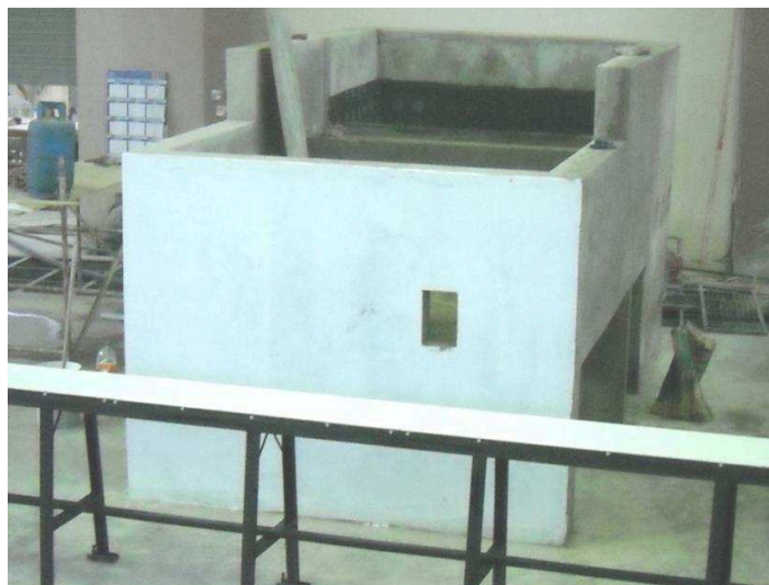
FOTOGRAFÍA No. 5.6: Vista frontal del tanque de abastecimiento Presa Toachi.
