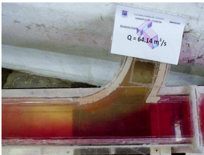
Fotografía No. 34: Características del flujo de aproximación desde el túnel Sarapullo ( Q_S = 26.7 \text{ m}^3/\text{s} ).
