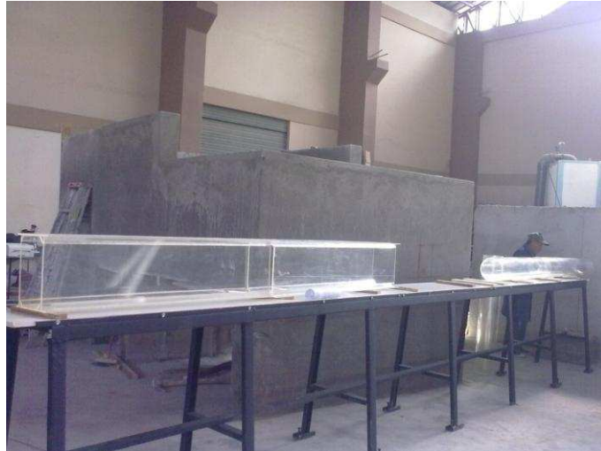
Fotografía No. 5: Montaje de estructuras en acrílico sobre soportes metálicos.
