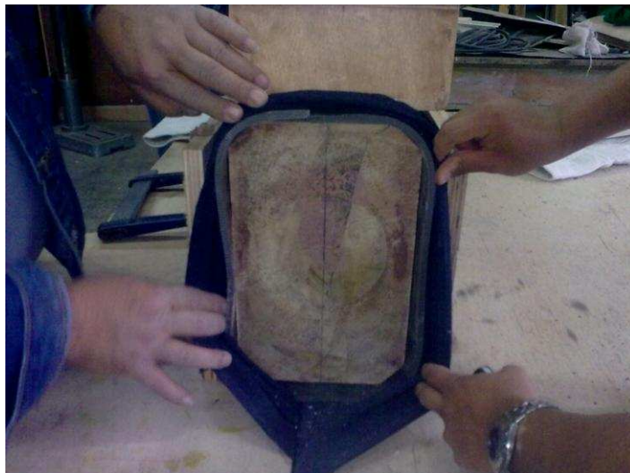
FOTOGRAFÍA No. 5.12: Moldeado en acrílico de la transición.
