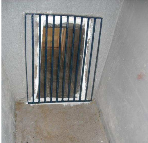
Fotografía No. 9: Rejilla de entrada en el modelo de la bocatoma desde el embalse Toachi.
