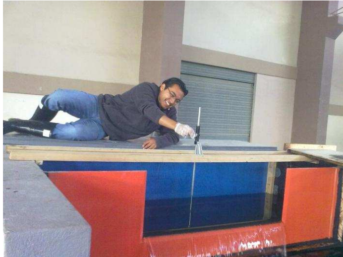
Fotografía No. 12: Vista frontal del vertedero de medida del caudal hacia el embalse Toachi (ubicado en el Tanque No. 2).
