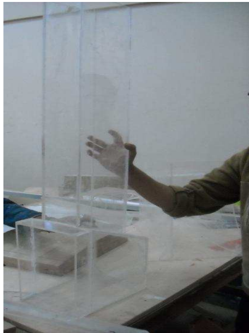
Fotografía No. 8: Pozo de descarga del flujo desde el túnel Sarapullo (montado sobre la galería de interconexión).
