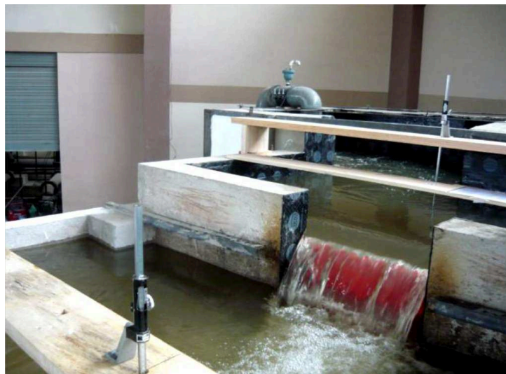
FOTOGRAFÍA No. 5.18: Vertedero rectangular 1, en operación.
