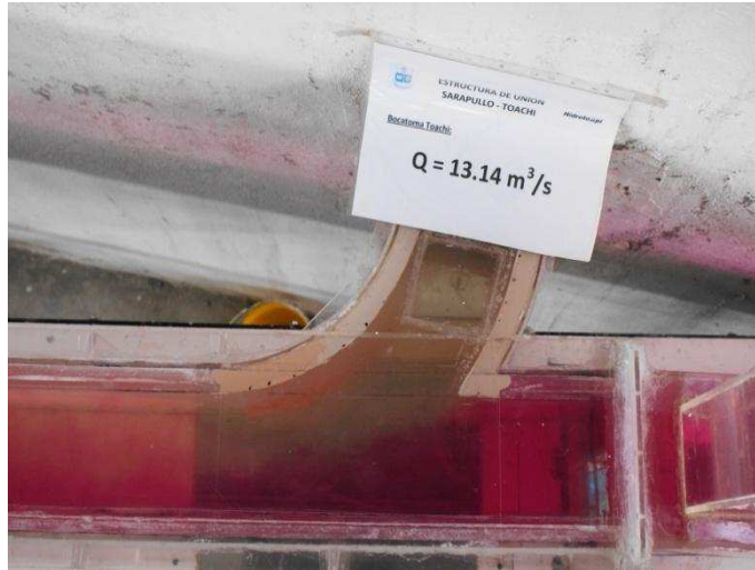
Fotografía No. 24: Características del flujo de aproximación desde el túnel Sarapullo ( Q_S = 6.0 \text{ m}^3/\text{s} ).
