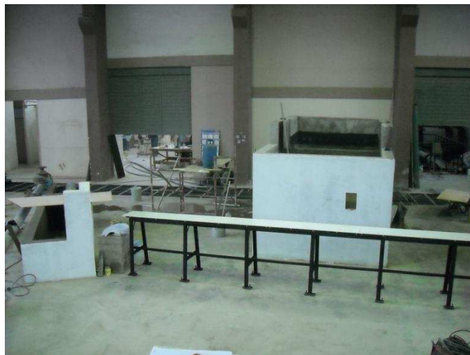
Fotografía No. 6: Mesa de soporte para la estructura de acrílico (galería de interconexión).
