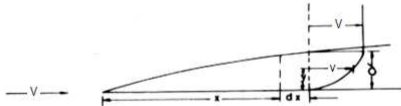
FIGURA No. 2.12: Desarrollo de la capa límite sobre una placa plana.
