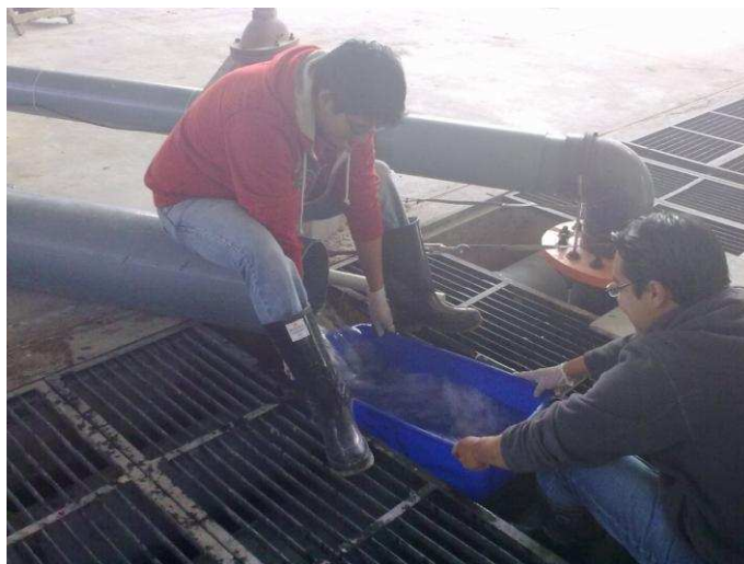
Fotografía No. 10: Medición volumétrica del caudal desde el canal de descarga.
