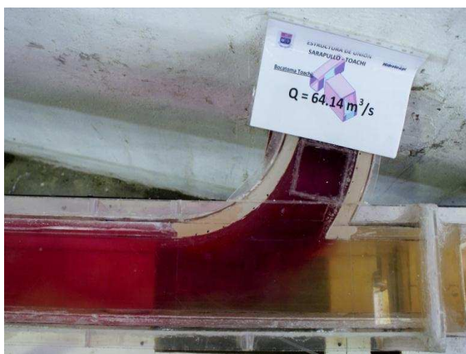
Fotografía No. 35: Características del flujo desde la bocatoma en el embalse Toachi ( Q_T = 64.1 \text{ m}^3/\text{s} ).
