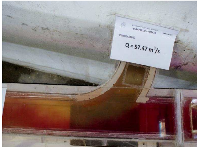
Fotografía No. 32: Características del flujo de aproximación desde el túnel Sarapullo ( Q_S = 13.3 \text{ m}^3/\text{s} ).
