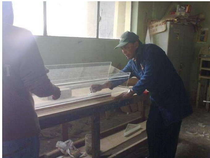
Fotografía No. 4: Elaboración del modelo de la Galería de Interconexión en material acrílico.
