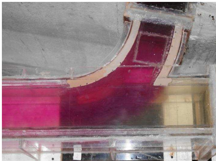
Fotografía No. 19: Características del flujo de entrada desde la bocatoma del embalse Toachi ( Q_T = 31.5 \text{ m}^3/\text{s} ).
