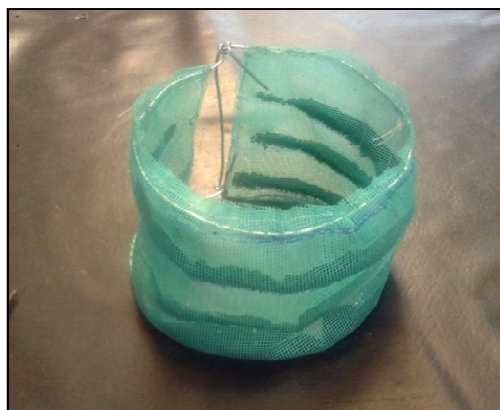
Figura 3.8 Pared cilíndrica de malla con carbón activado
