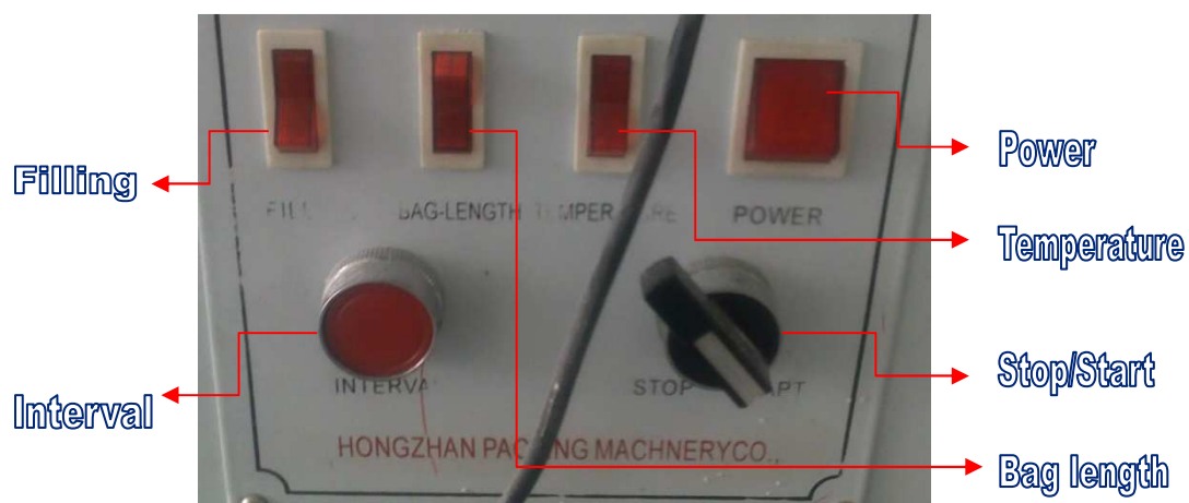
Figura 1.5 Interruptores del panel
