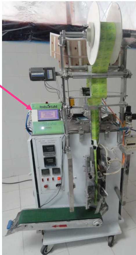
Figura 4.2 Envasadora implementada con el nuevo control
