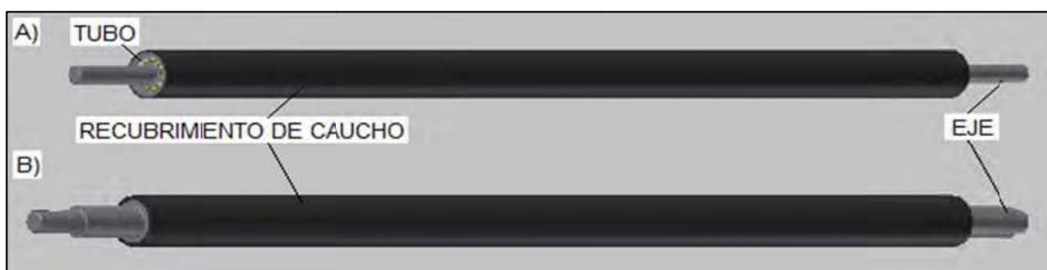
Figura 3.3.2. M3- Identificación de subcomponentes: A) Rodillo de arrastre superior, B) Rodillo de arrastre inferior.
