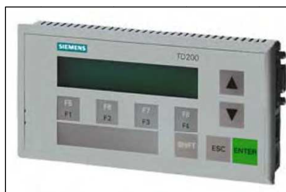
Figura 4.23. Display SIEMENS 6ES7272-0AA30-0YA1
