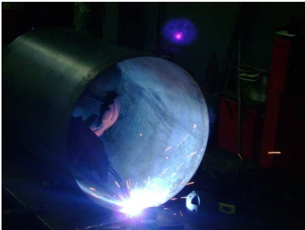
Figura 5.8. Soldado de las planchas
