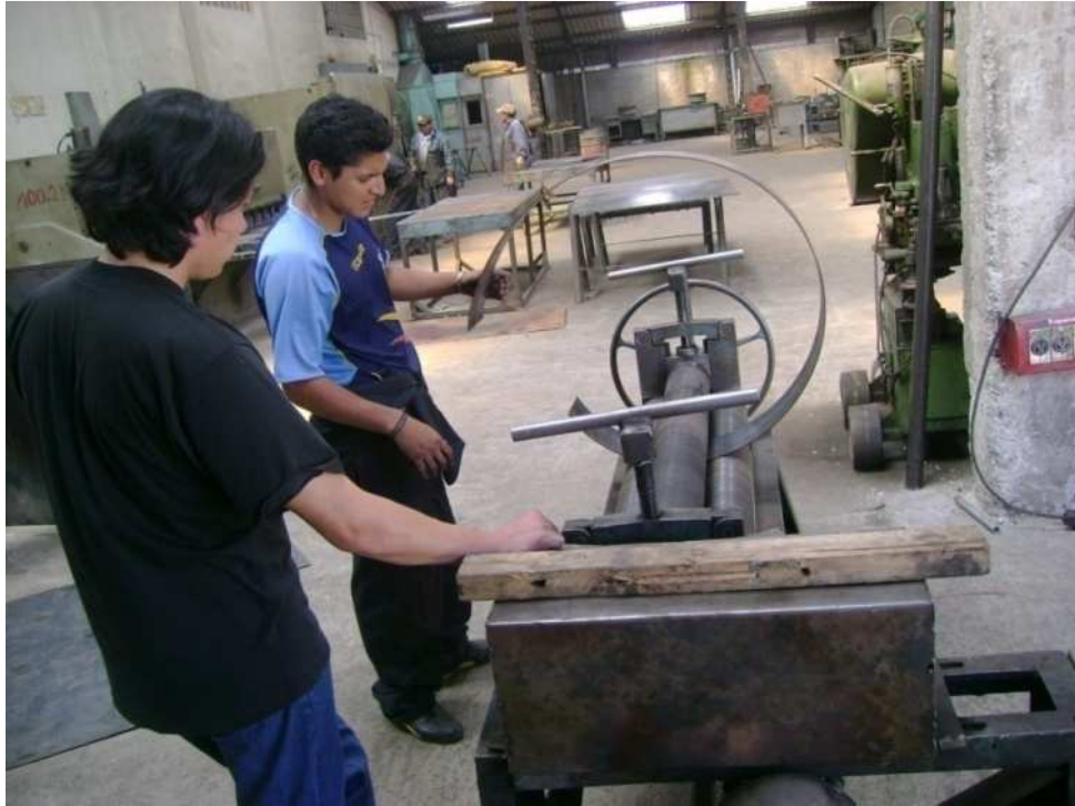
Figura 5.6. Proceso de barolado de las planchas.
