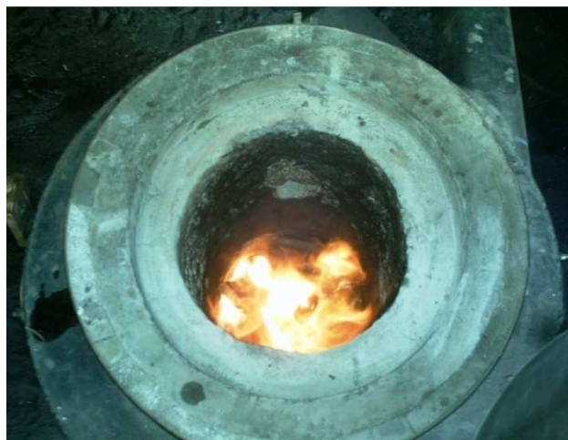
Figura 6.1. Encendido del horno
