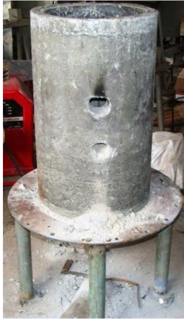
Figura 5.2. Cilindro inferior refractario con agujeros de piqueras y toberas.
