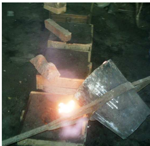
Figura 6.5. Colado de las piezas
