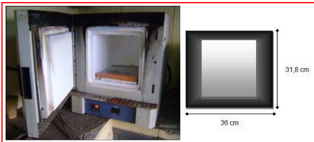
Figura 2.2. Mufla eléctrica utilizada para la calcinación de la muestra
