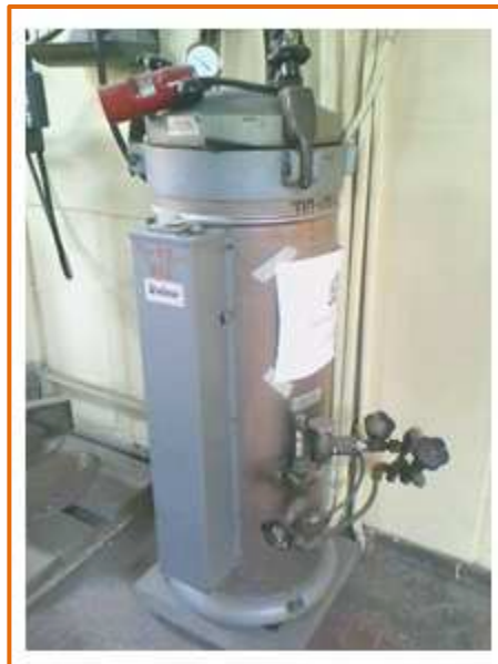
Figura 2.15. Autoclave empleado en el tratamiento de la arcilla prensada con vapor de agua saturado
