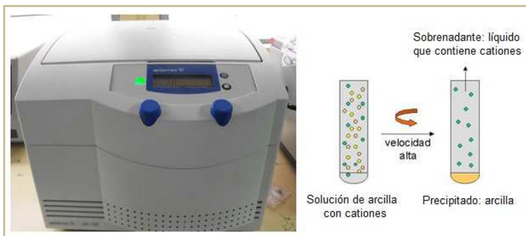
Figura 2.8. Centrifuga utilizada para la determinación de la capacidad de intercambio catiónico (CEC)
