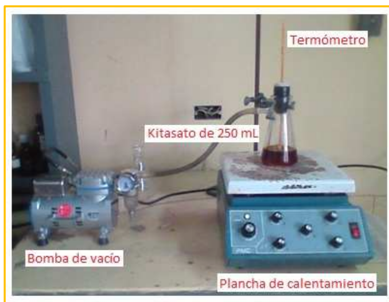
Figura 2.17. Materiales y equipos utilizados para realizar los ensayos de blanqueo de aceite de palma
