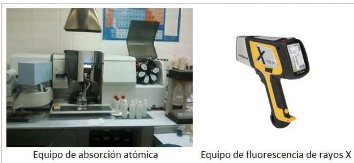
Figura 2.4. Equipos utilizados para la determinación de la composición química de la arcilla de blanqueo
