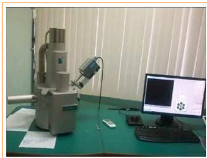
Figura 2.6. Microscopio electrónico de barrido utilizado para la caracterización química de la arcilla de blanqueo
