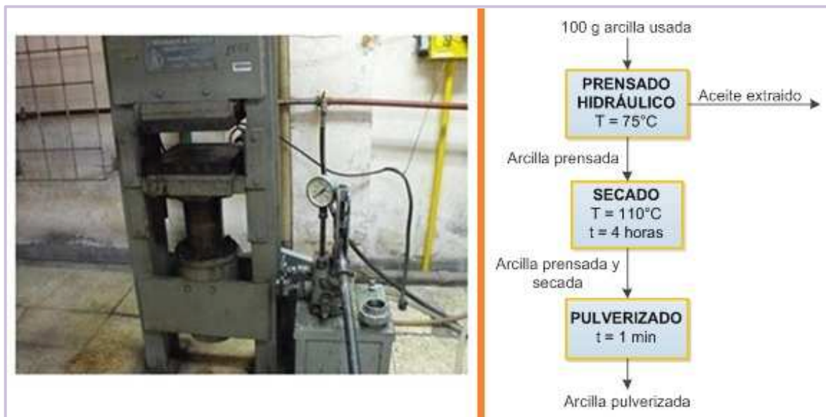
Figura 2.11. Prensa hidráulica y esquema de la metodología experimental empleada en los ensayos de prensado de la arcilla de blanqueo usada
