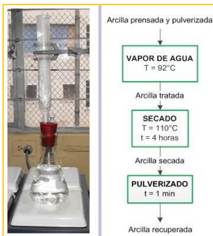
Figura 2.14. Materiales y metodología utilizados para el tratamiento de la arcilla prensada con vapor de agua en un sistema abierto a la atmósfera
