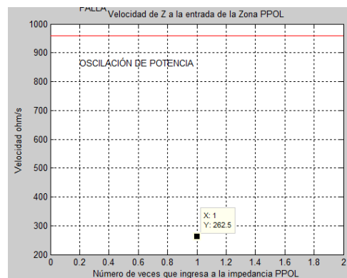
Figura 3- 13. Velocidad de la impedancia con la que cruza la característica PPOL– Fuente FORDI 1.0
