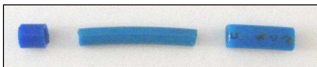
Figura 81. Corte de manguera de poliuretano.
