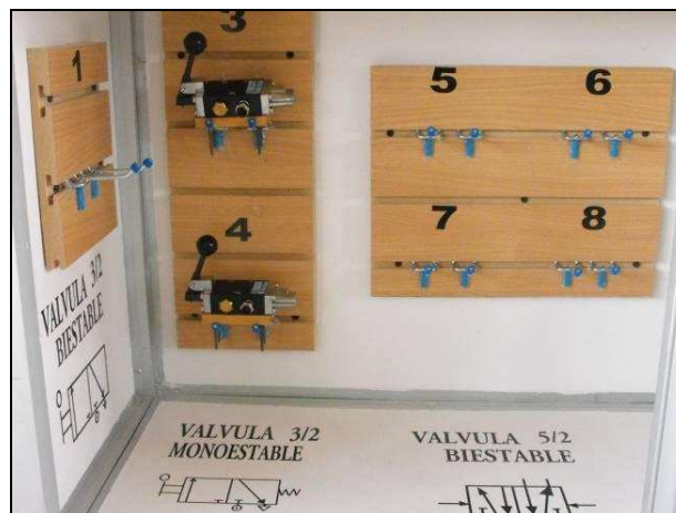
Figura 93. Soportes de los elementos neumáticos.
