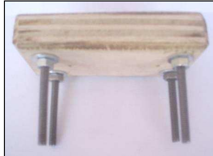
Figura 87. Colocación de pernos en la base.
