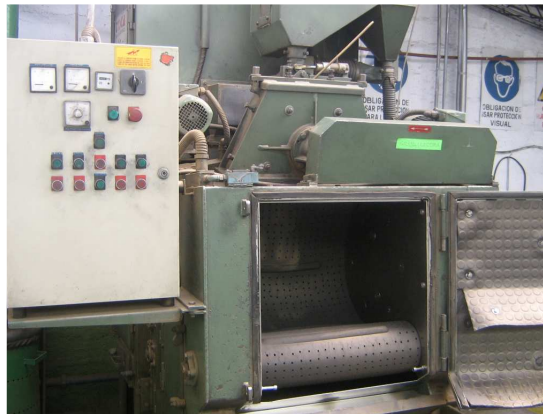
Fig. 15.- Granalladora marca TOSCA
