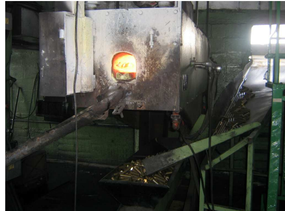
Fig. 8.- Calentamiento en horno
