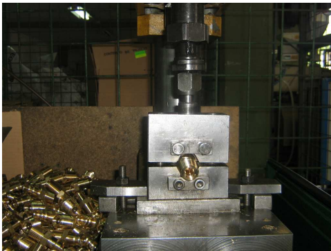
Fig. 22.- Marcado de válvulas
