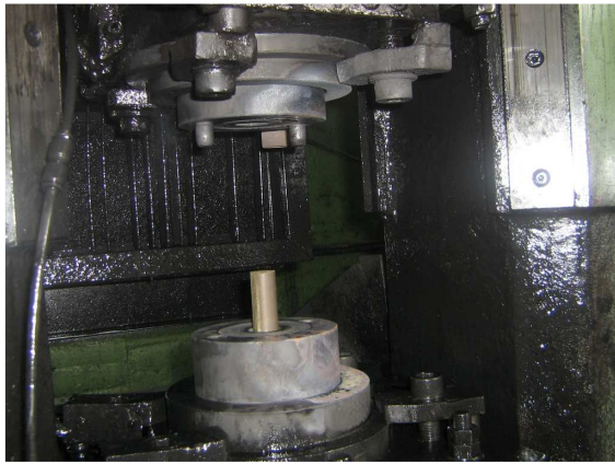
Fig. 9.- Estampado en caliente o forja
