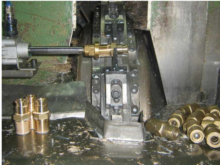
Fig. 17.- Maquinado final de la válvula
