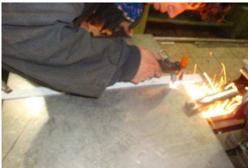
Figura 4.2. Corte de la placa de Acero Inoxidable.
