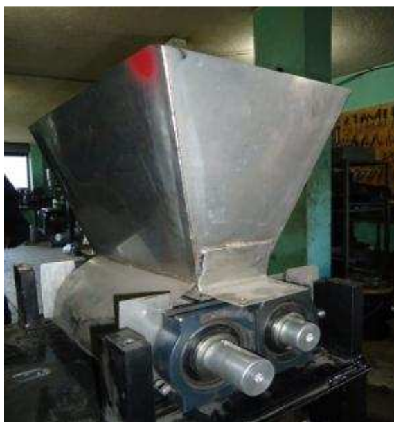
Figura 4.7. Montaje de tolva.
