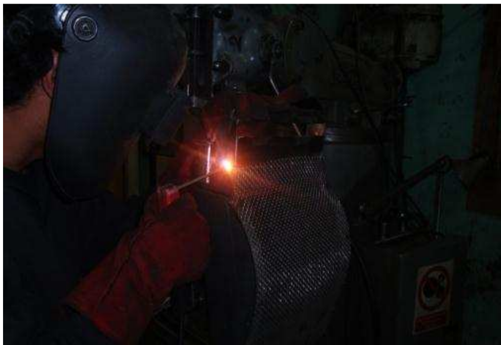
Figura 4.3. Soldadura de partes del tamiz.
