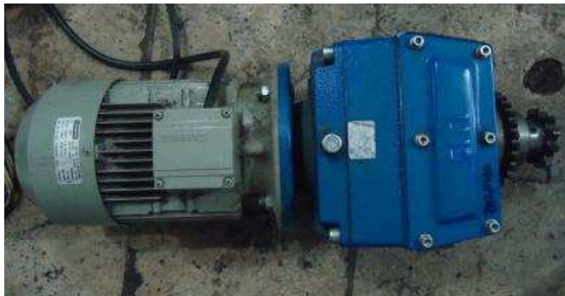
Figura 3.1. Motorreductor empleado para construir la máquina.
