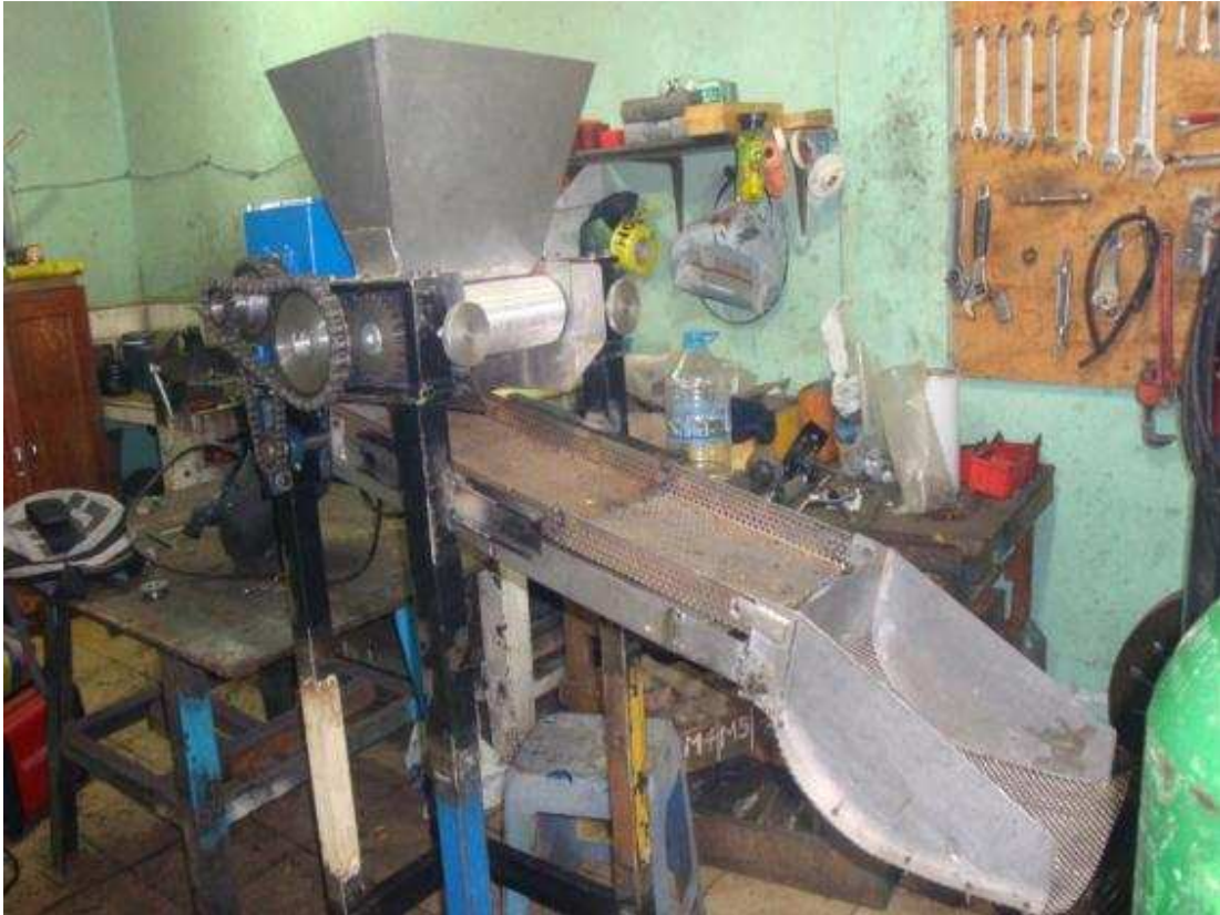
Figura 4.10. Montaje completo de la descascarilladora de cacao.
