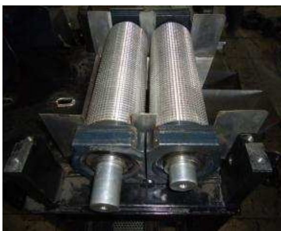
Figura 4.6. Montaje de ejes-rodillos.
