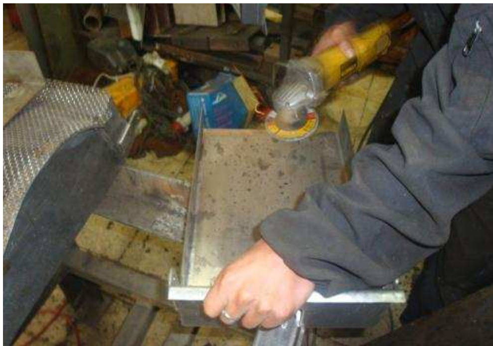
Figura 4.4. Eliminación de rebabas.
