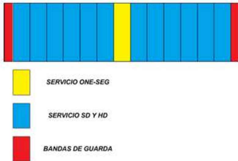
Figura 3.2 Segmentos para servicios y bandas de guarda
