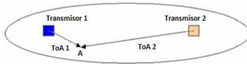
Figura 4.21 Diferencia de tiempo de llegada de la señal a un receptor
