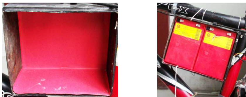
Figura 2.7 Montaje de las baterías en la bicicleta
