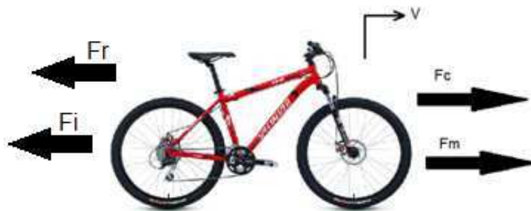
Figura 3.5 Diagrama de fuerzas en la bicicleta
