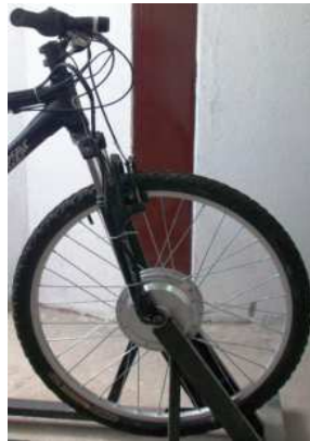
Figura 2.5 Acople del motor a la bicicleta
