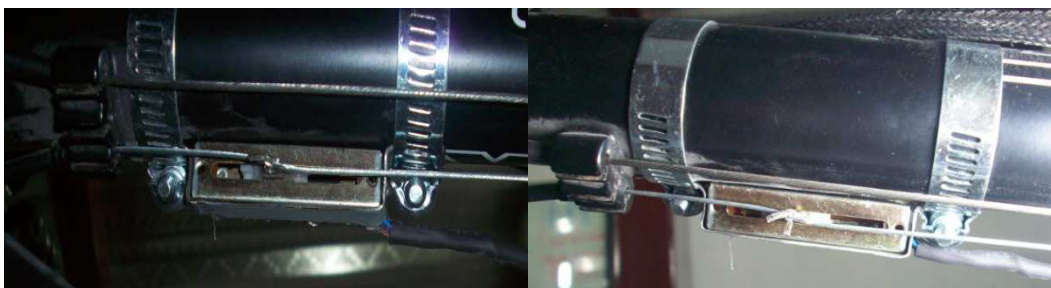
Figura 2.33 Instalación del potenciómetro para sensor las marchas
