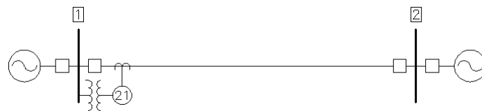
Figura A3.1 Sistema de potencia radial
