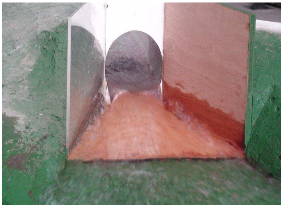
Fotografía No. 35: Detalle del funcionamiento de la estructura de salida, con la modificación MI-2, Q=200 \text{ m}^3/\text{s}
