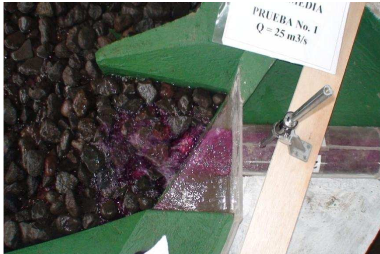
Fotografía No. 53: Vista en planta del funcionamiento de la estructura de salida en la Descarga Intermedia ( Q = 25 \text{ m}^3/\text{s} )
