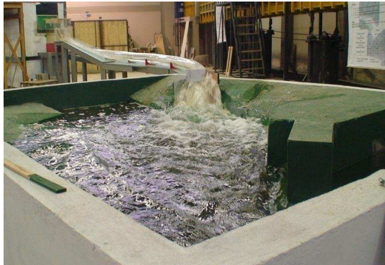
Fotografía No. 30: Vista frontal del flujo de salida con funcionamiento del dissipador tipo Kumin con Caudal = 900 \text{ m}^3/\text{s} . Modificación MDE-1. Sin control aguas abajo
