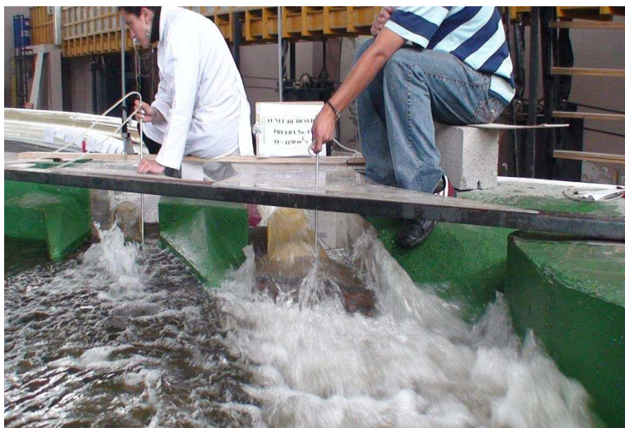
Fotografía No. 79: Toma de medida en el punto 2 TD en la salida Túnel de Desvío y 3DI en la Descarga Intermedia ( Q_{TDp} = 1138.27 \text{ m}^3/\text{s} , Q_{Dlp} = 192.40 \text{ m}^3/\text{s} )
