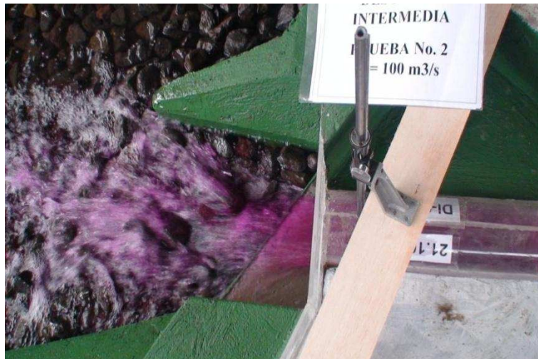
Fotografía No. 54: Vista en planta del funcionamiento de la estructura de salida en la Descarga Intermedia ( Q = 100 \text{ m}^3/\text{s} )
