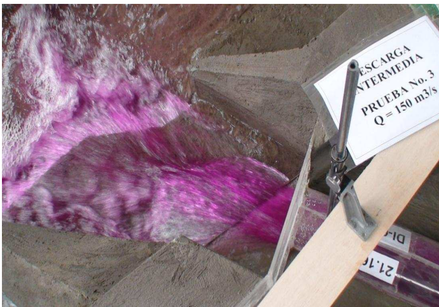
Fotografía No. 53: Vista superior del flujo de salida de la Descarga Intermedia, ( Q_{DI}=150.00 \text{ m}^3/\text{s} )
