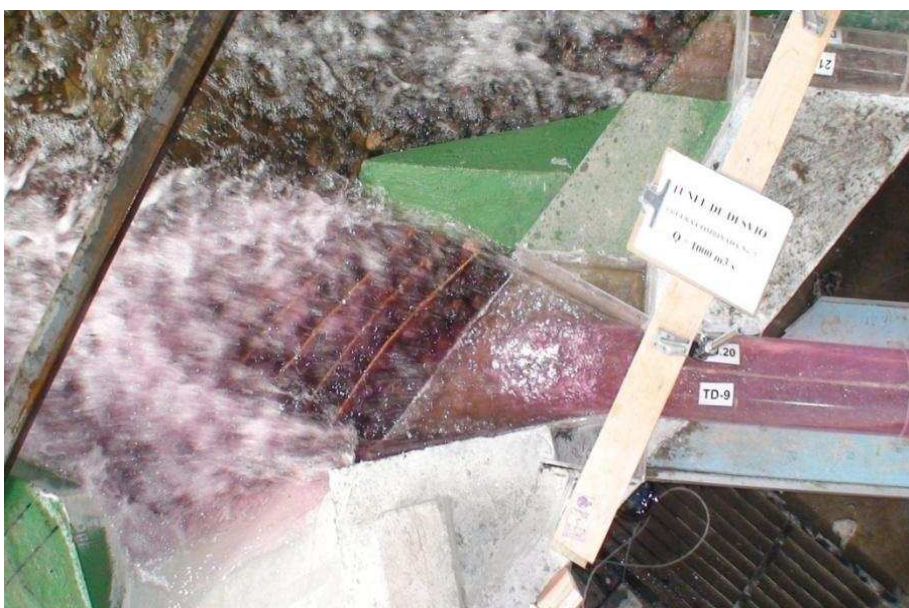
Fotografía No. 60: Vista en planta del funcionamiento de la estructura de salida en el Túnel de Desvío ( Q = 1000 \text{ m}^3/\text{s} ). Modificación MDE-3.
