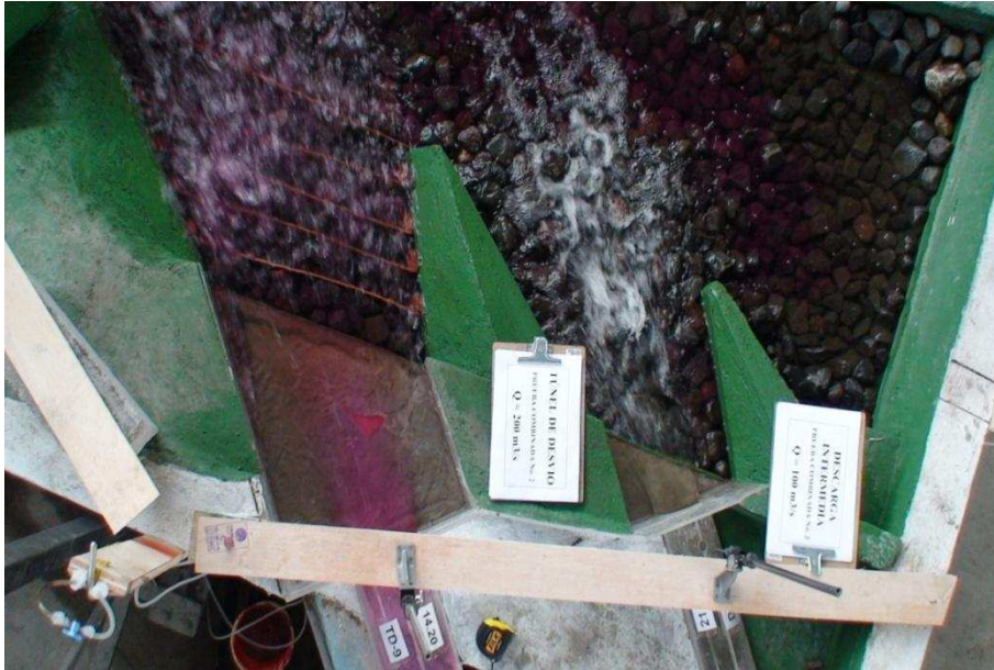
Fotografía No. 70: Vista superior de la salida del flujo de la Descarga Intermedia y el Túnel de Desvío ( Q_{TDp} = 199.25 \text{ m}^3/\text{s} , Q_{Dlp} = 103.00 \text{ m}^3/\text{s} )
