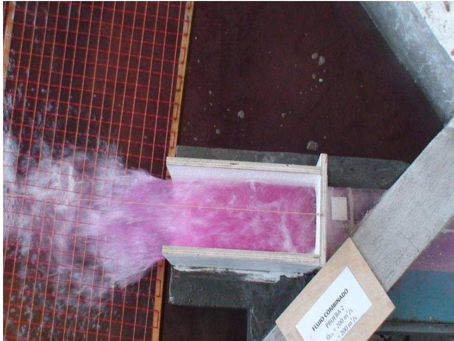
Fotografía No. 13 Vista de planta del funcionamiento del dissipador de energía tipo Kumin con un caudal de 397,8 \text{ m}^3/\text{s} ( Q_{TD} = 198,0 \text{ m}^3/\text{s} y Q_{DI} = 199,8 \text{ m}^3/\text{s} )
