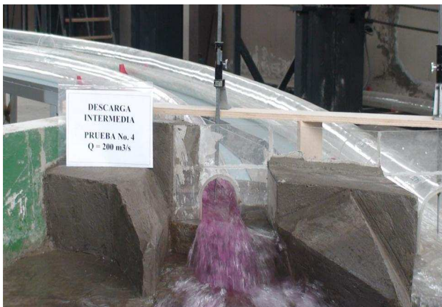
Fotografía No. 55: Vista frontal del flujo de la salida en la Descarga Intermedia, ( Q_{DI}=200.00 \text{ m}^3/\text{s} )
