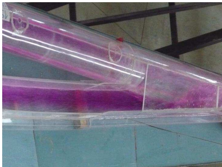
Fotografía No. 16: Estructura de unión de la Descarga Intermedia y Túnel de Desvío.
