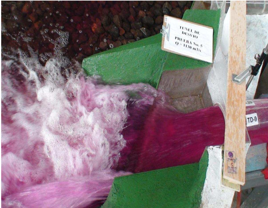
Fotografía No. 46: Imagen superior del flujo en la salida del Túnel de Desvío, ( Q_{TD}=1130.00 \text{ m}^3/\text{s} )
