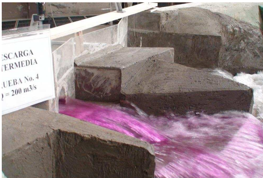
Fotografía No. 54: Vista lateral del flujo de la salida en la Descarga Intermedia, ( Q_{DI}=200.00 \text{ m}^3/\text{s} )
