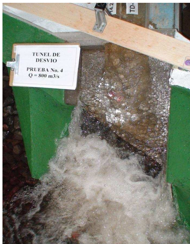
Fotografía No. 43: Imagen superior del flujo en la salida del Túnel de Desvío, ( Q_{TD}=800.00 \text{ m}^3/\text{s} )
