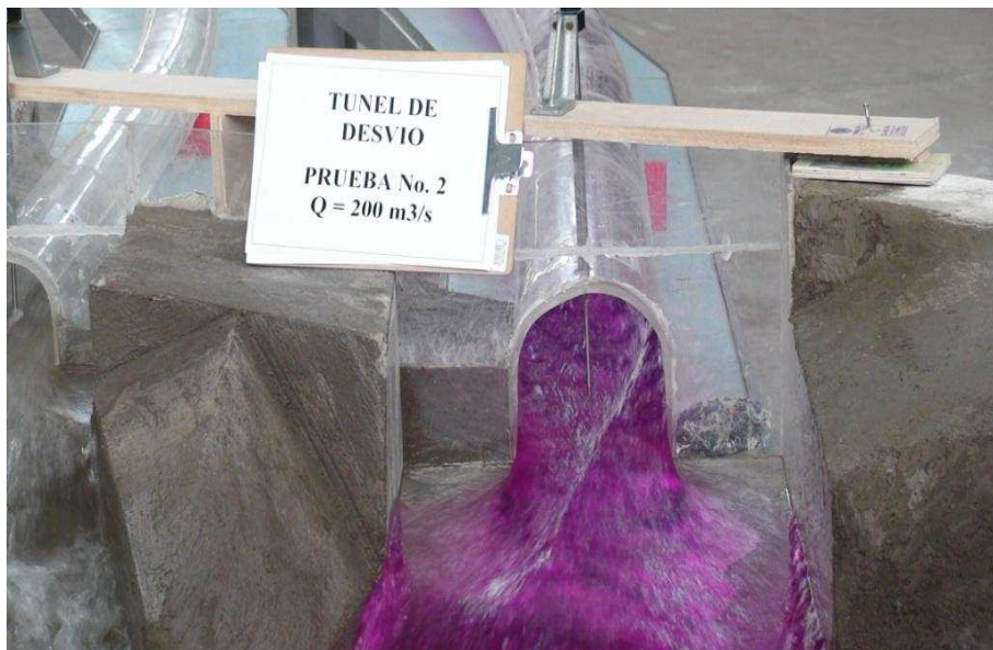
Fotografía No. 39: Vista del flujo en la salida del Túnel de Desvío, ( Q_{TD}=200 \text{ m}^3/\text{s} )
