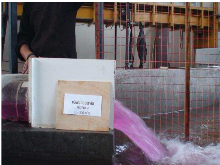
Fotografía No. 4 Vista lateral del flujo de salida del dissipador de energía tipo Kumin con un caudal aproximado de Q_{TD} = 500 \text{ m}^3/\text{s}
