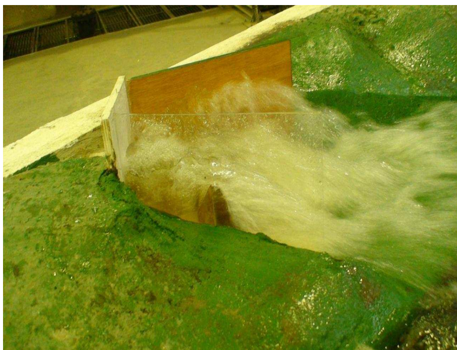
Fotografía No. 31: Vista de Perfil del funcionamiento de la estructura de salida, con la modificación MI-1, Q_{\text{aprox}}=1130 \text{ m}^3/\text{s}
