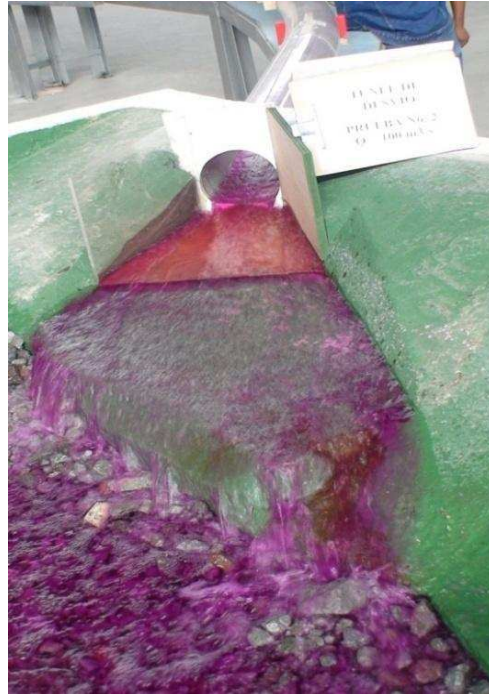
Fotografía No. 38: Vista frontal del funcionamiento de la estructura de salida con Q_{TD}=100\text{m}^3/\text{s} . Sin control desde aguas abajo. Modificación MDE-2.
