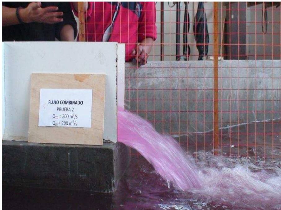
Fotografía No. 14 Vista lateral del flujo de salida del dissipador de energía tipo Kumin con un caudal de 397,8 \text{ m}^3/\text{s} ( Q_{TD} = 198,0 \text{ m}^3/\text{s} y Q_{DI} = 199,8 \text{ m}^3/\text{s} )
