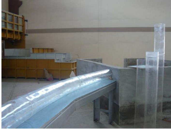
Fotografía No.10: Tramo de la tubería en acrílico a la salida del Túnel de Desvío
