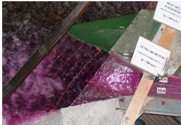
Fotografía No.57: Vista en planta de la geometría propuesta para el diseño definitivo de la zona de entrega desde el Túnel de Desvío.
