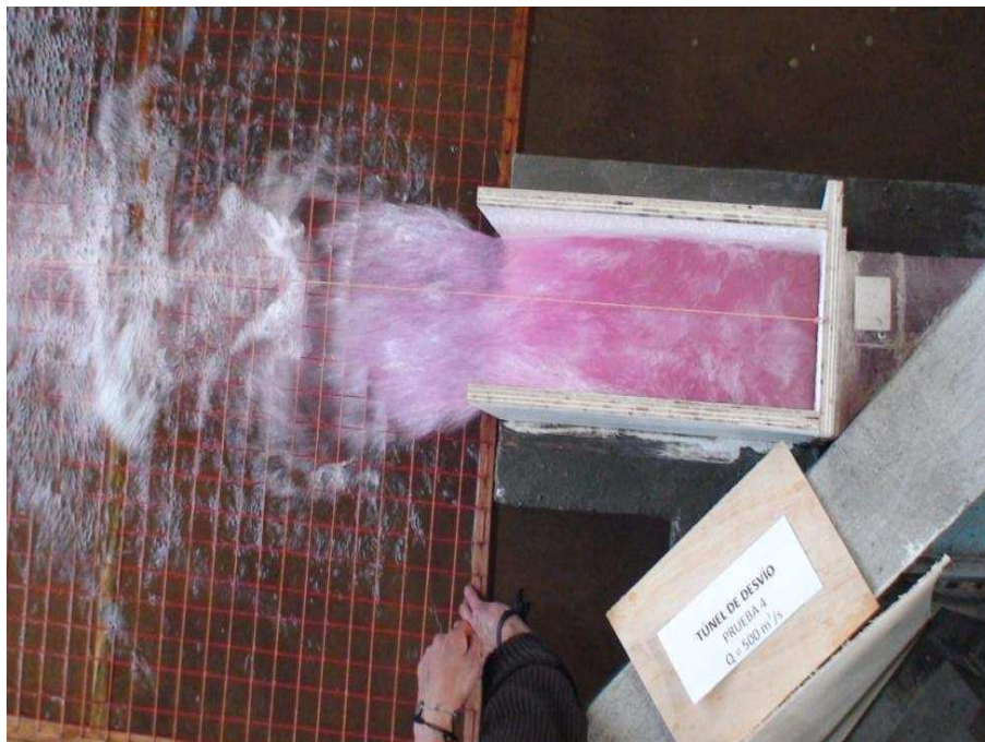
Fotografía No. 3 Vista de planta del funcionamiento del dissipador de energía tipo Kumin con un caudal aproximado de Q_{TD} = 500 \text{ m}^3/\text{s}
