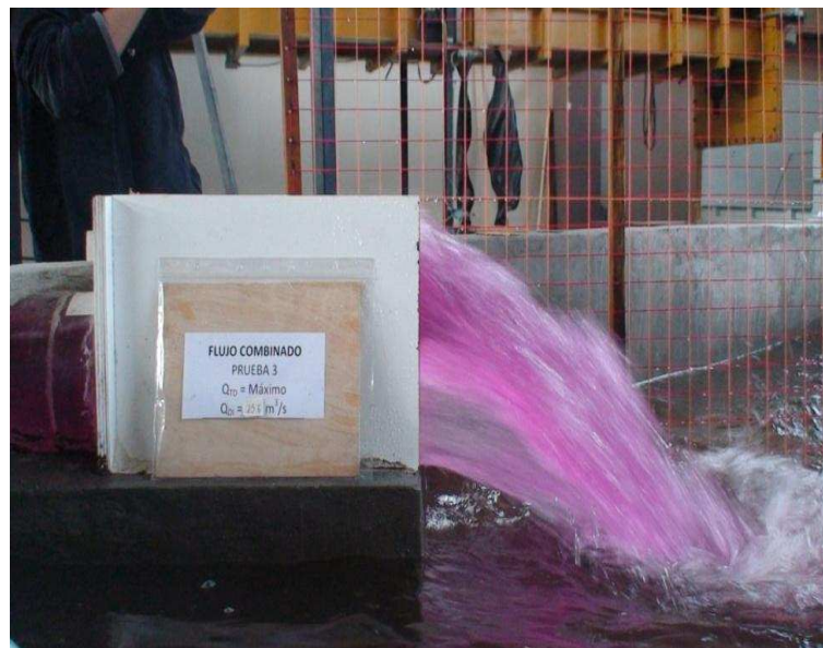
Fotografía No.19: Vista lateral del flujo de salida del dissipador de energía tipo Kumin con un caudal de 1.022 m 3 /s ( Q_{TD} = 997.0 \text{ m}^3/\text{s} y Q_{DI} = 25 \text{ m}^3/\text{s} )
