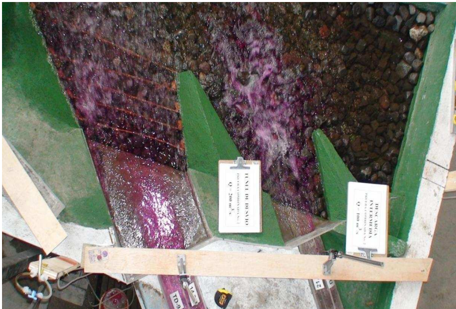
Fotografía No. 69: Vista superior de la salida del flujo de la Descarga Intermedia y el Túnel de Desvío ( Q_{TD}=199.25 m^3/s , Q_{DI}=103.00 m^3/s )
