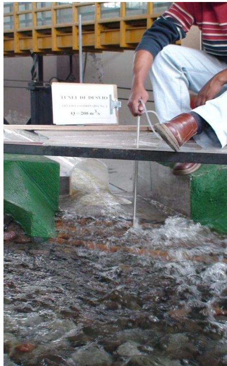
Fotografía No. 65: Toma de medida en el punto 5 TD a la salida del túnel de desvío ( Q_{TD}=199.25 \text{ m}^3/\text{s} , Q_{DI}=103.00 \text{ m}^3/\text{s} )
