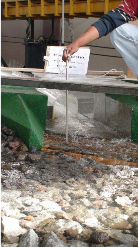
Fotografía No. 58: Prueba combinada con el Pitot, en el punto 4TD, ( Q_{TD} = 99.55 \text{ m}^3/\text{s} , Q_{DI} = 23.7 \text{ m}^3/\text{s} )
