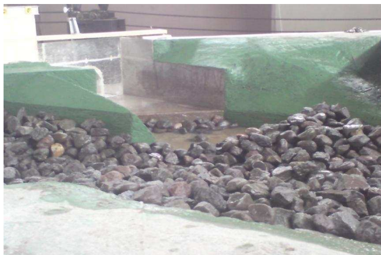
Fotografía No. 48: Formación del cuenco en el tramo del río Paute, representado con material suelto, luego de la operación del dissipador. Geometría de Fase III.
