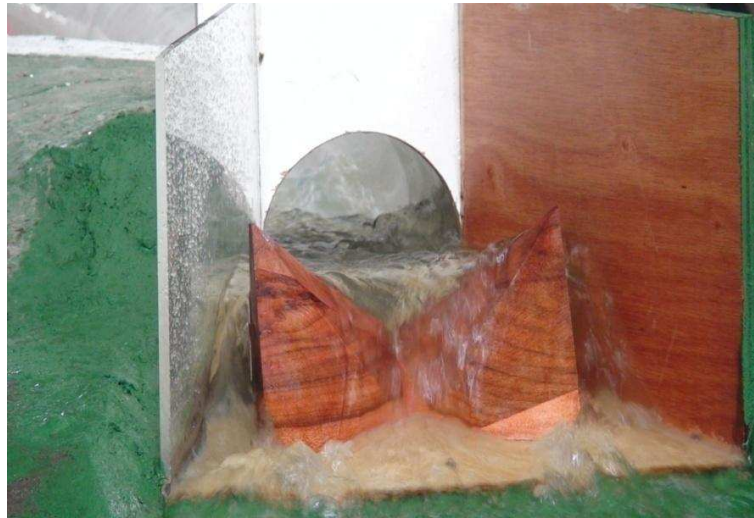
Fotografía No. 28: Vista frontal del flujo de salida con funcionamiento del dissipador tipo Kumin con Caudal = 100 \text{ m}^3/\text{s} . Modificación MDE-1. Sin control aguas abajo
