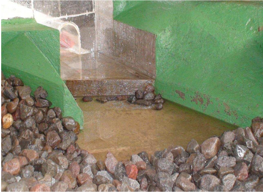
Fotografía No. 48: Imagen de la estructura de salida del Túnel de Desvío, movimiento de material sólido sobre el río. ( Q_{TD}=1130.00 \text{ m}^3/\text{s} )
