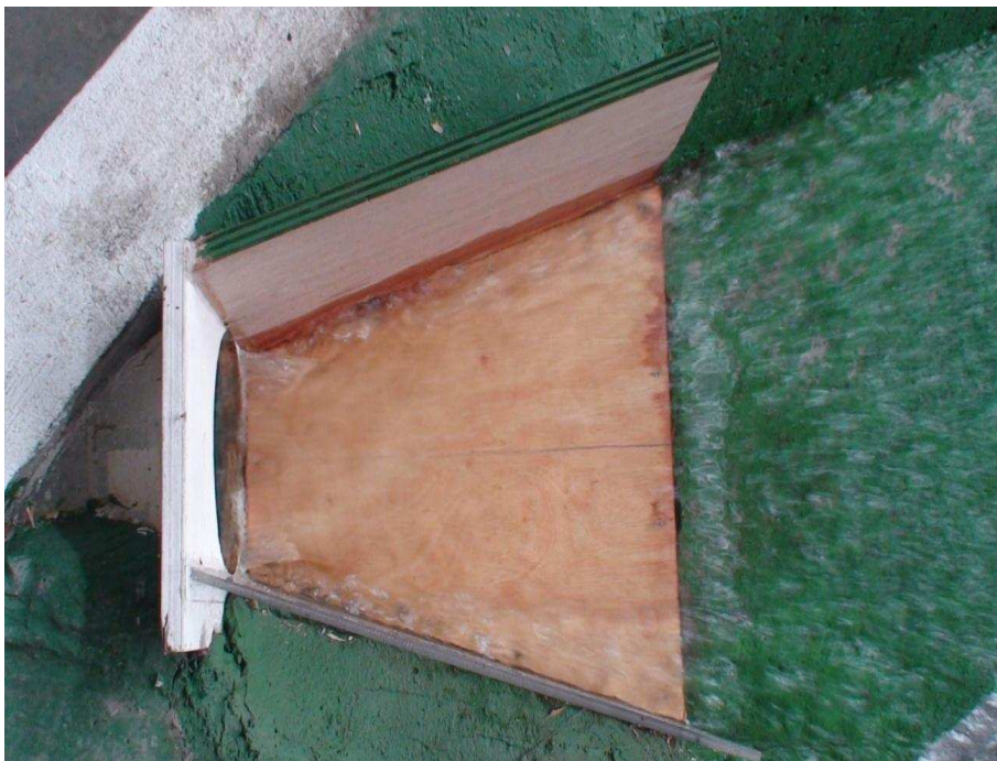
Fotografía No. 33: Vista en Planta del funcionamiento de la estructura de salida, con la modificación MI-2, Q=200 \text{ m}^3/\text{s}
