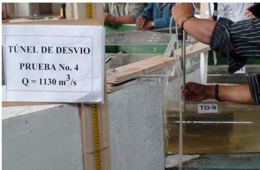
Fotografía No. 77: Toma de medida en el punto TD-9 al final del Túnel de Desvío ( Q_{TDp} = 1138.27 \text{ m}^3/\text{s} , Q_{Dip} = 192.40 \text{ m}^3/\text{s} )
