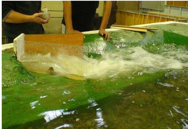
Fotografía No. 33: Formación del cuenco de socavación en el río Paute, representado con material suelto, luego de la operación del dissipador. Modificación MDE-1. Con control de aguas abajo a 6.00m.
