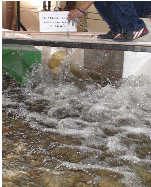
Fotografía No. 89: Vista frontal del flujo de salida en el Túnel de Desvío ( Q_{TDp} = 799.92 \text{ m}^3/\text{s} , Q_{Dip} = 186.86 \text{ m}^3/\text{s} )
