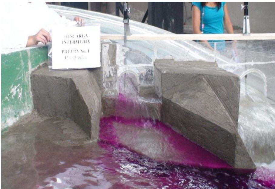
Fotografía No. 49: Vista del flujo en la salida de la Descarga Intermedia, ( Q_{DI}=25.00 \text{ m}^3/\text{s} )
