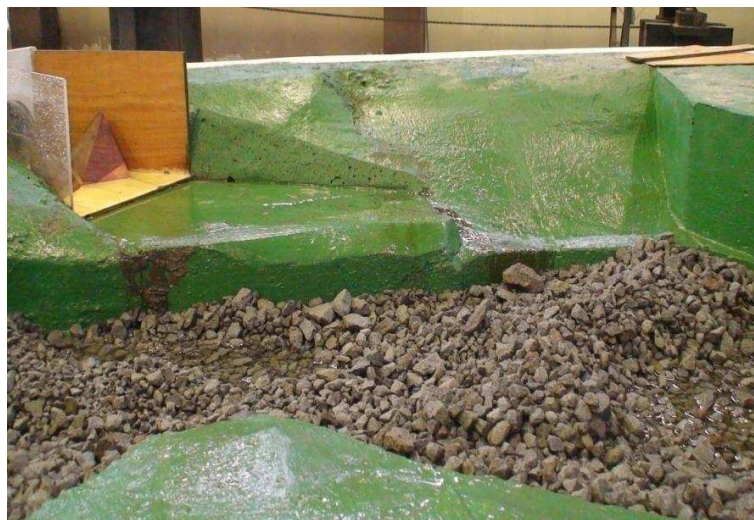
Fotografía No. 33: Formación del cuenco de socavación en el río Paute, representado con material suelto, luego de la operación del dissipador. Modificación MDE-1. Con control de aguas abajo a 6.00m.
