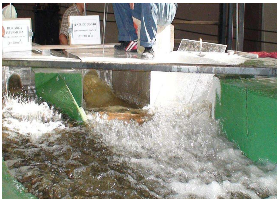
Fotografía No. 96: Vista frontal de la estructura de salida modificada del Túnel de Desvío ( Q_{TDP} = 1001.02 \text{ m}^3/\text{s} , Q_{Dlp} = 200.05 \text{ m}^3/\text{s} )
