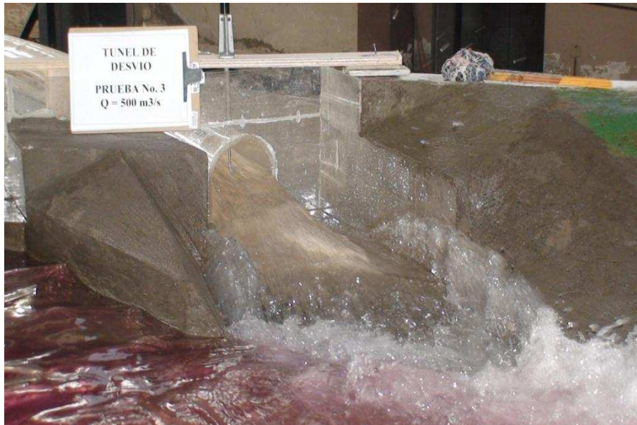
Fotografía No. 42: Vista del flujo de salida en el Túnel de Desvío, ( Q_{TD}=500 \text{ m}^3/\text{s} )
