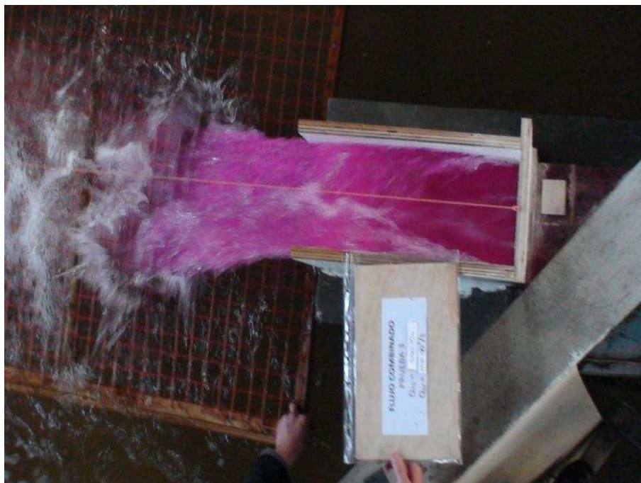
Fotografía No. 15 Vista de planta del funcionamiento del dissipador de energía tipo Kumin con un caudal de 998,8 \text{ m}^3/\text{s} ( Q_{TD} = 898,0 \text{ m}^3/\text{s} y Q_{DI} = 100,8 \text{ m}^3/\text{s} )
