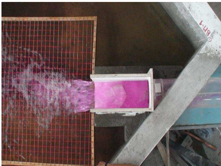
Fotografía No. 8 Vista de planta del funcionamiento del disipador de energía tipo Kumin con un caudal aproximado de Q_{D1} = 100 \text{ m}^3/\text{s}
