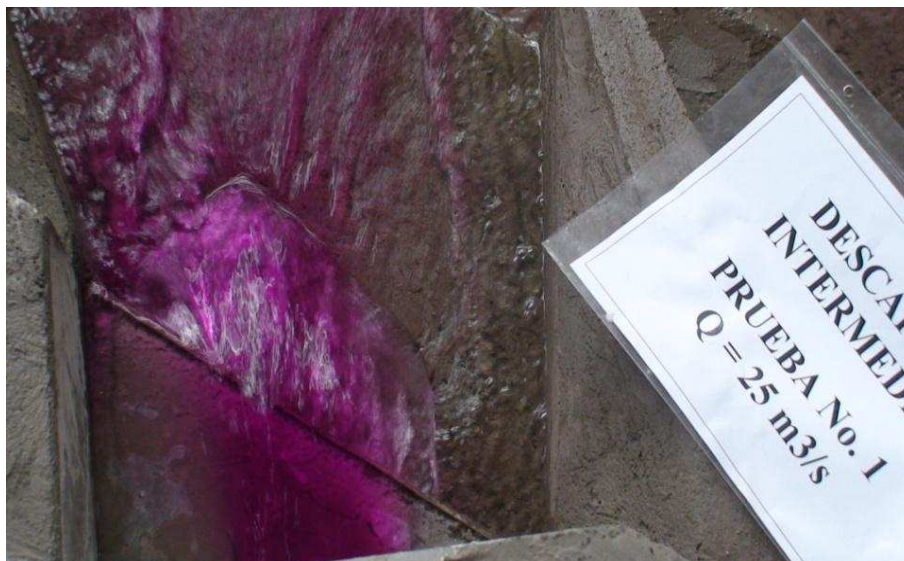
Fotografía No. 50: Vista superior del flujo en la salida de la Descarga Intermedia, ( Q_{DI}=25.00 \text{ m}^3/\text{s} )
