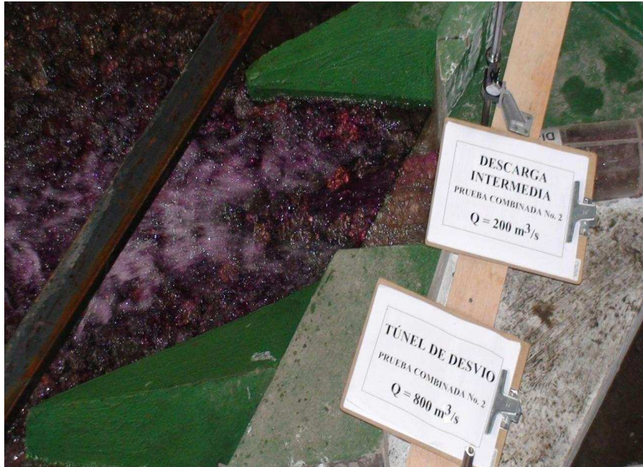
Fotografía No. 92: Vista superior del flujo de salida de la Descarga Intermedia ( Q_{TDp} = 799.92 \text{ m}^3/\text{s} , Q_{Dip} = 186.86 \text{ m}^3/\text{s} )
