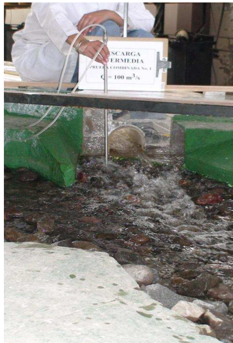
Fotografía No. 85: Toma del punto 4 DI en la salida de la Descarga Intermedia ( Q_{TDp} = 499.62 \text{ m}^3/\text{s} , Q_{Dip} = 87.6 \text{ m}^3/\text{s} )
