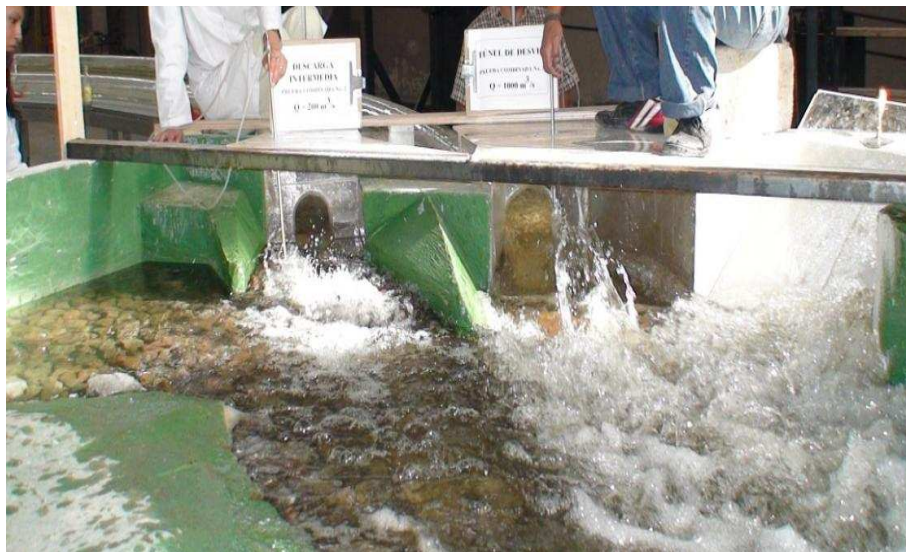
Fotografía No. 100: Vista frontal de la salida del flujo de la Descarga Intermedia el Túnel de Desvío ( Q_{TDp} = 1001.02 \text{ m}^3/\text{s} , Q_{Dlp} = 200.05 \text{ m}^3/\text{s} )
