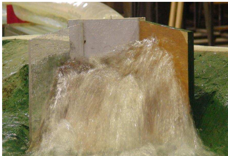
Fotografía No. 31: Vista frontal del flujo de salida con funcionamiento del dissipador tipo Kumin con Caudal = 900 \text{ m}^3/\text{s} . Modificación MDE-1. Sin control aguas abajo
