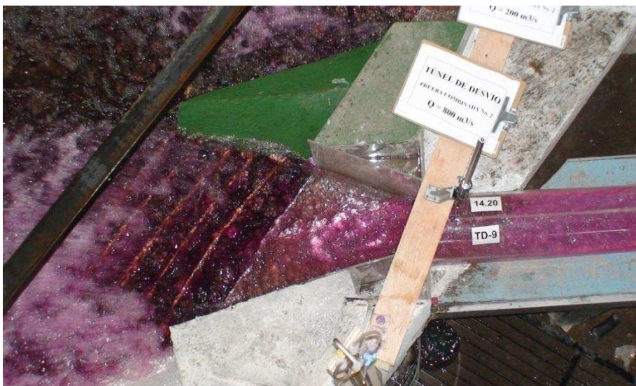
Fotografía No. 60: Vista en planta del funcionamiento de la estructura de salida en el Túnel de Desvío ( Q = 1000 \text{ m}^3/\text{s} ). Modificación MDE-3.
