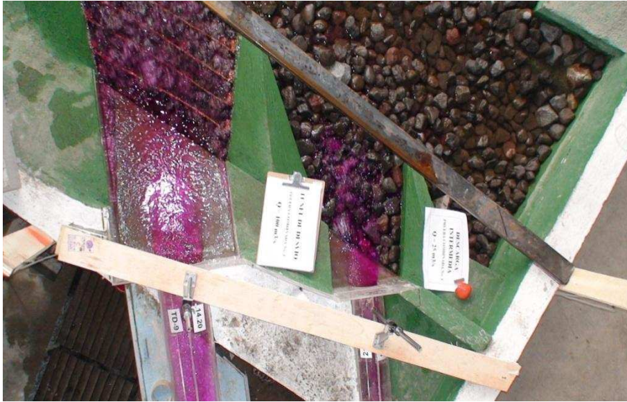
Fotografía No. 60: Vista superior del flujo de salida del Túnel de Desvío y la descarga intermedia, ( Q_{TD} = 99.55 \text{ m}^3/\text{s} , Q_{DI} = 23.7 \text{ m}^3/\text{s} )
