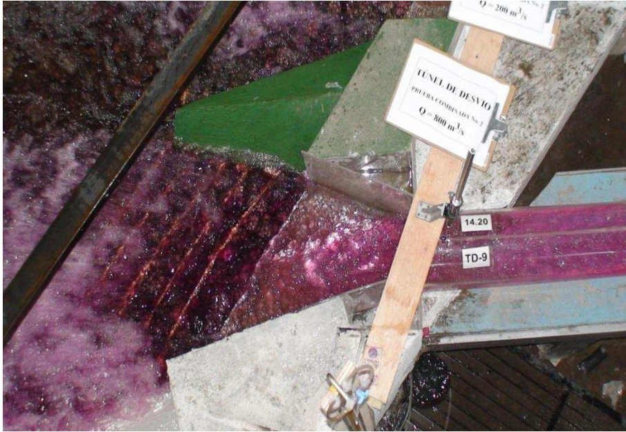
Fotografía No. 90: Vista superior del flujo de salida en el Túnel de Desvío ( Q_{TDp} = 799.92 \text{ m}^3/\text{s} , Q_{Dlp} = 186.86 \text{ m}^3/\text{s} )
