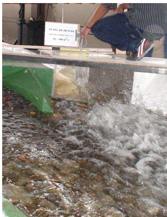
Fotografía No. 83: Vista frontal del flujo de salida en el Túnel de Desvío y la Descarga Intermedia ( Q_{TDp} = 499.62 \text{ m}^3/\text{s} , Q_{Dip} = 87.6 \text{ m}^3/\text{s} )
