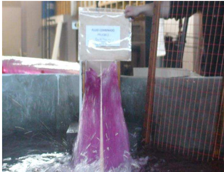
Fotografía No. 20: Vista frontal del flujo de salida del dissipador de energía tipo Kumin con un caudal de 1.022 m 3 /s (QTD = 997.0 m 3 /s y QDI = 25 m 3 /s)
