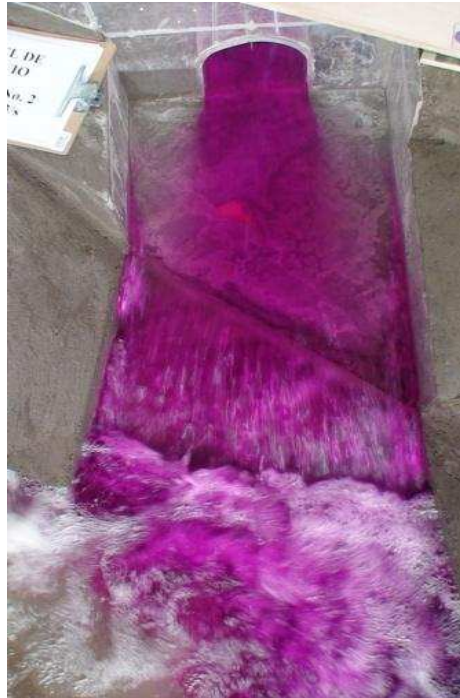
Fotografía No. 40: Vista del flujo en la salida del Túnel de Desvío, ( Q_{TD}=200 \text{ m}^3/\text{s} )
