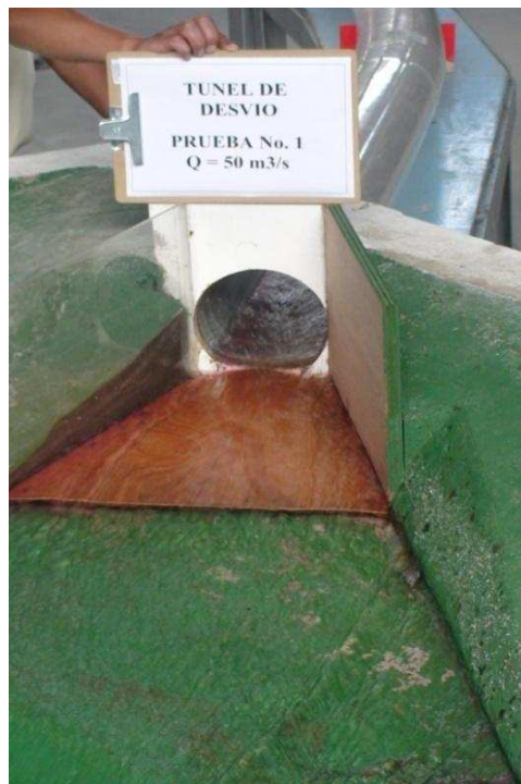
Fotografía No. 37: Vista frontal del funcionamiento de la estructura de salida con Q_{TD}=50 \text{ m}^3/\text{s} . Modificación MDE-2.
