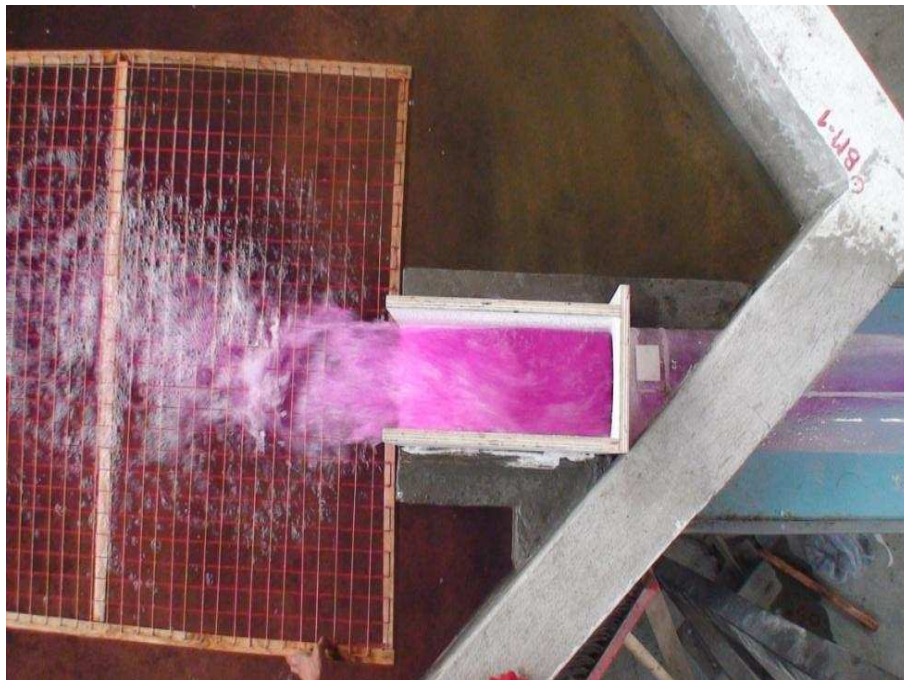
Fotografía No. 9 Vista de planta del funcionamiento del dissipador de energía tipo Kumin con un caudal aproximado de Q_{D1} = 200 \text{ m}^3/\text{s}
