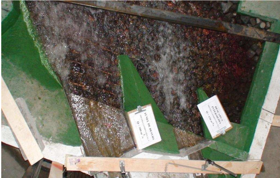
Fotografía No. 76: Vista aérea de la salida del flujo en el Túnel de Desvío y la Descarga Intermedia ( Q_{TDp} = 502.37 \text{ m}^3/\text{s} , Q_{Dip} = 151.90 \text{ m}^3/\text{s} )
