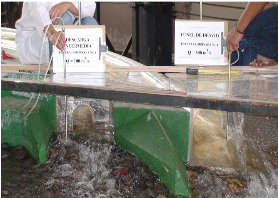
Fotografía No. 87: Toma de medidas en el punto 4 DI de la Descarga Intermedia y 5TD del Túnel de Desvío ( Q_{TDp} = 499.62 \text{ m}^3/\text{s} , Q_{Dip} = 87.6 \text{ m}^3/\text{s} )
