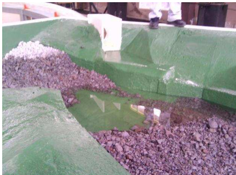
Fotografía No. 24: Formación del cuenco en el tramo del río Paute, representado con material suelto, luego de la operación del dissipador con el caudal de 900 \text{ m}^3/\text{s} .
