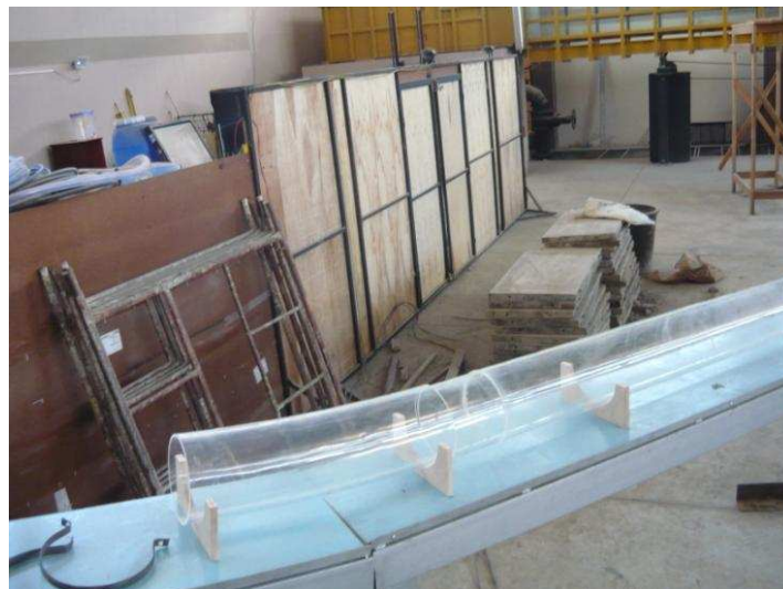
Fotografía No.9: Vista superior de la tubería en acrílico para representar el Túnel de Desvío
