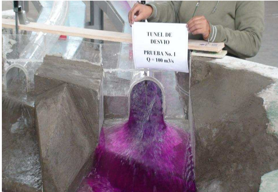
Fotografía No. 38: Vista frontal del flujo de salida en el Túnel de Desvío, ( Q_{TD}=100 \text{ m}^3/\text{s} )
