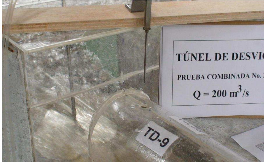
Fotografía No. 64: Toma de medida en el punto 2TD del túnel de desvío ( Q_{TD}=199.25 \text{ m}^3/\text{s} , Q_{DI}=103.00 \text{ m}^3/\text{s} )
