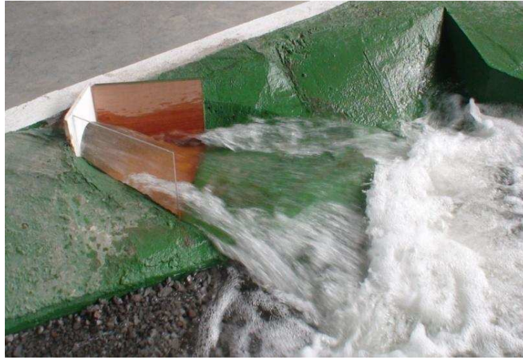
Fotografía No. 42: Vista superior del funcionamiento de la estructura de salida con QTD=951m^3/s . Modificación MDE-2.
