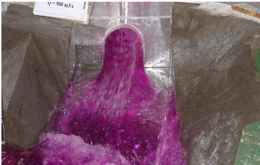
Fotografía No. 41: Vista frontal del flujo de salida en el Túnel de Desvío, ( Q_{TD}= 500 \text{ m}^3/\text{s} )
