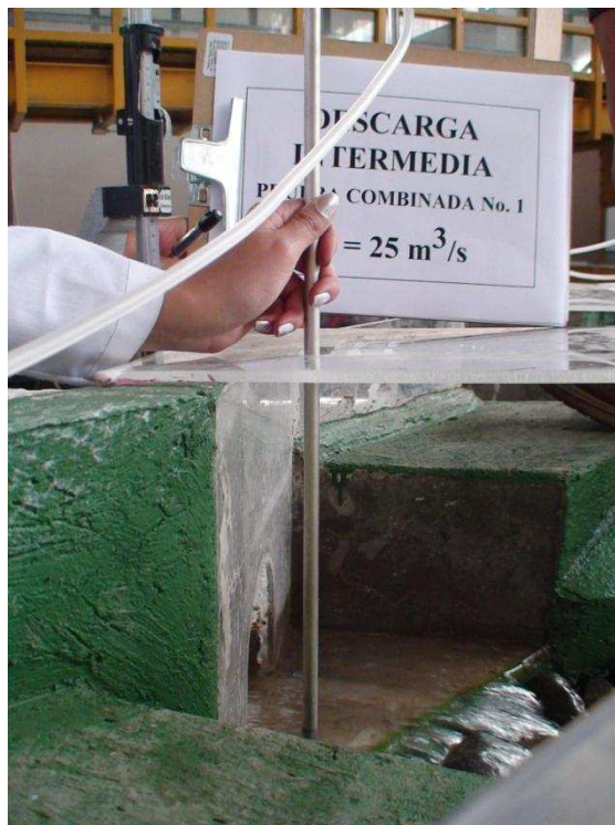
Fotografía No. 61: Vista lateral de la medición con el Pitot en el punto 3DI, ( Q_{TD} = 99.55 \text{ m}^3/\text{s} , Q_{DI} = 23.7 \text{ m}^3/\text{s} )
