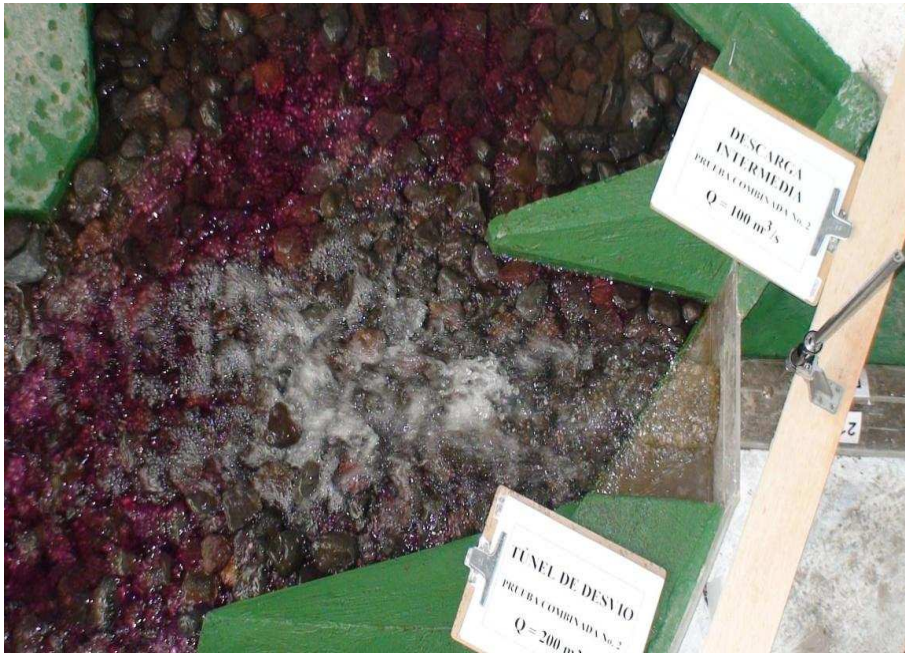
Fotografía No. 68: Vista superior de la salida del flujo en la Descarga Intermedia ( Q_{TD}=199.25 m^3/s , Q_{DI}=103.00 m^3/s )
