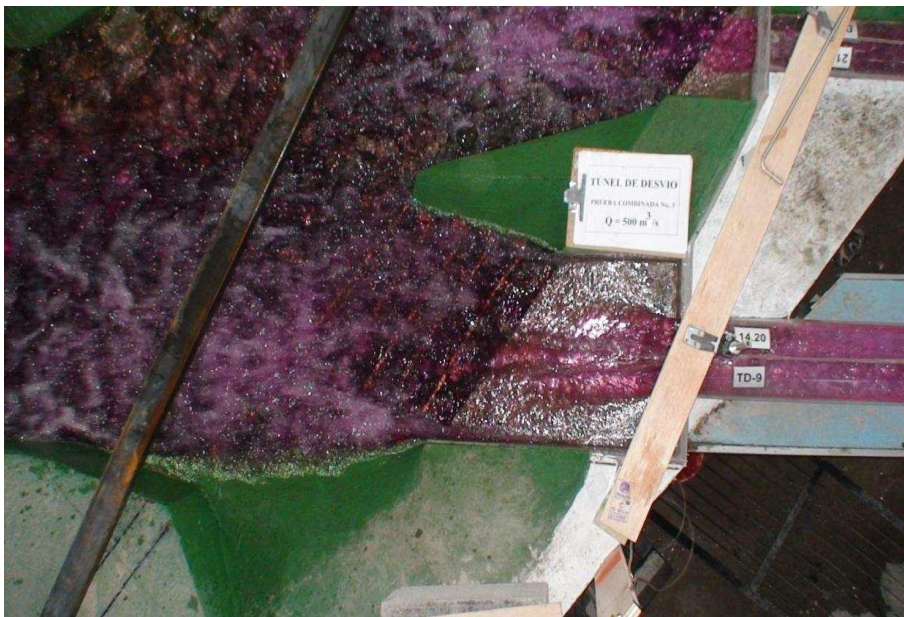
Fotografía No. 73: Vista superior de la salida del flujo en el Túnel de Desvío ( Q_{TDp} = 502.37 \text{ m}^3/\text{s} , Q_{Dlp} = 151.90 \text{ m}^3/\text{s} )
