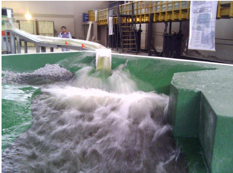
Fotografía No. 18 Vista frontal del flujo de salida del dissipador tipo Kumin hacia el tramo del río Paute con un caudal aproximado de 900 \text{ m}^3/\text{s}
