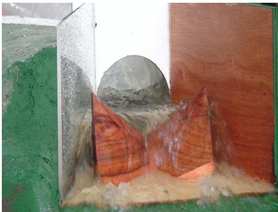
Fotografía No.23: Detalle de la inclusión de un dissipador Tipo Kumin, de tamaño aumentado.
