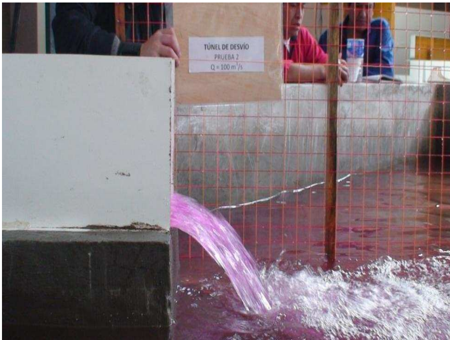
Fotografía No. 2 Vista lateral del flujo de salida del dissipador de energía tipo Kumin con un caudal aproximado de Q_{TD} = 100 \text{ m}^3/\text{s}
