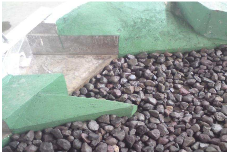
Fotografía No.47: Representación del Río Paute con material suelto antes del funcionamiento del modelo.
