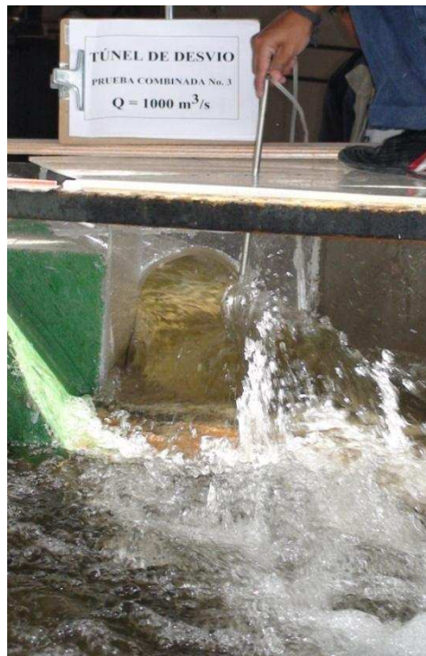
Fotografía No. 95: Vista frontal del flujo de salida del Túnel de Desvío ( Q_{TDp} = 1001.02 \text{ m}^3/\text{s} , Q_{Dip} = 200.05 \text{ m}^3/\text{s} )
