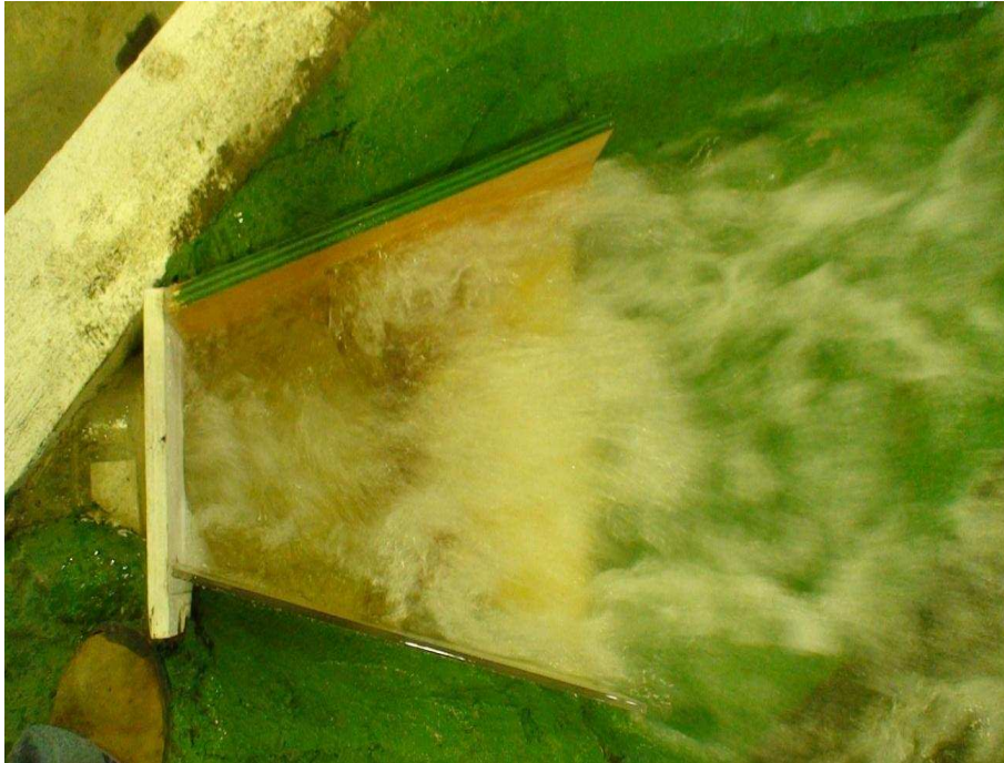
Fotografía No. 32: Vista en Planta del funcionamiento de la estructura de salida, con la modificación MI-1, Q_{\text{aprox}}=1130 \text{ m}^3/\text{s}
