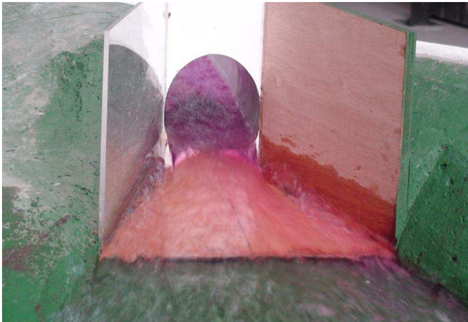
Fotografía No.25: Vista Frontal de la modificación en la geometría de estructura de salida denominada MDE-2.
