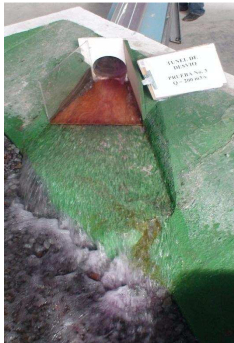
Fotografía No. 39: Vista frontal del funcionamiento de la estructura de salida con Q_{TD}=200\text{m}^3/\text{s} . Sin control desde aguas abajo. Modificación MDE-2.
