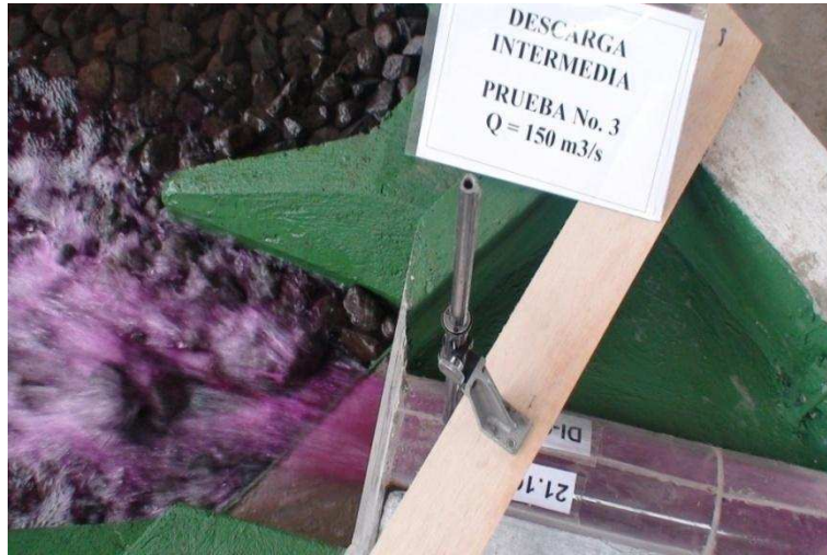
Fotografía No. 55: Vista en planta del funcionamiento de la estructura de salida en la Descarga Intermedia ( Q_{di}=150 \text{ m}^3/\text{s} )
