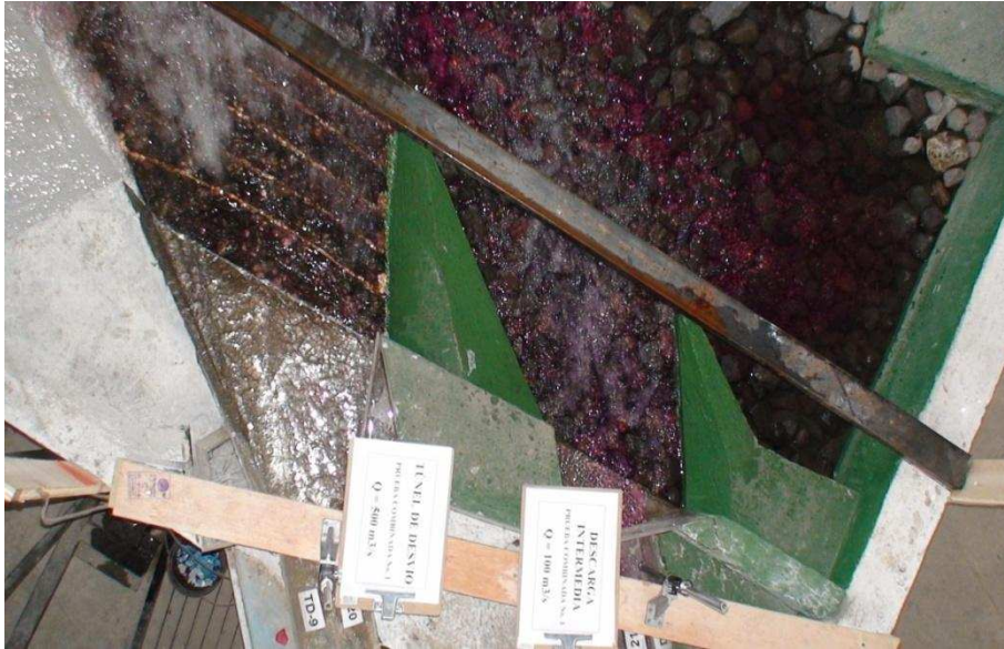
Fotografía No. 88: Vista superior del flujo de salida en el Túnel de Desvío y la Descarga Intermedia ( Q_{TDp} = 499.62 \text{ m}^3/\text{s} , Q_{Dip} = 87.6 \text{ m}^3/\text{s} )
