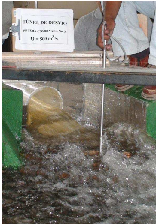
Fotografía No. 72: Toma de medida en el punto 5TD en el Túnel de Desvío ( Q_{TDp} = 502.37 \text{ m}^3/\text{s} , Q_{Dlp} = 151.90 \text{ m}^3/\text{s} )
