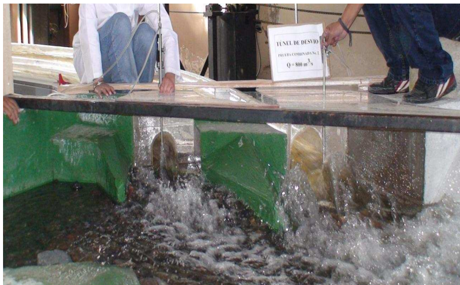
Fotografía No. 93: Vista frontal del flujo de salida de la Descarga Intermedia y Túnel de Desvío ( Q_{TDp} = 799.92 \text{ m}^3/\text{s} , Q_{Dip} = 186.86 \text{ m}^3/\text{s} )
