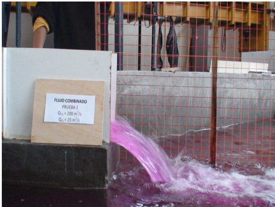
Fotografía No. 12 Vista lateral del flujo de salida del dissipador de energía tipo Kumin con un caudal de 224,5 \text{ m}^3/\text{s} ( Q_{TD} = 199,8 \text{ m}^3/\text{s} y Q_{DI} = 24,7 \text{ m}^3/\text{s} )
