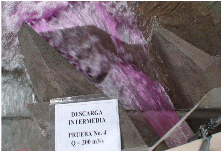
Fotografía No. 56: Vista frontal del flujo de la salida en la Descarga Intermedia, ( Q_{DI}=200.00 \text{ m}^3/\text{s} )
