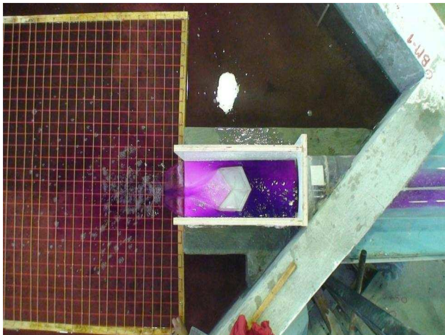
Fotografía No. 7 Vista de planta del funcionamiento del disipador de energía tipo Kumin con un caudal aproximado de Q_{D1} = 15 \text{ m}^3/\text{s}
