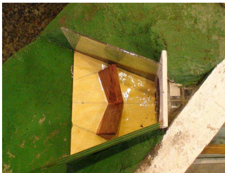
Fotografía No. 25: Vista superior de la implantación de la estructura de disipación, tipo Kumin. Modificación MDE-1
