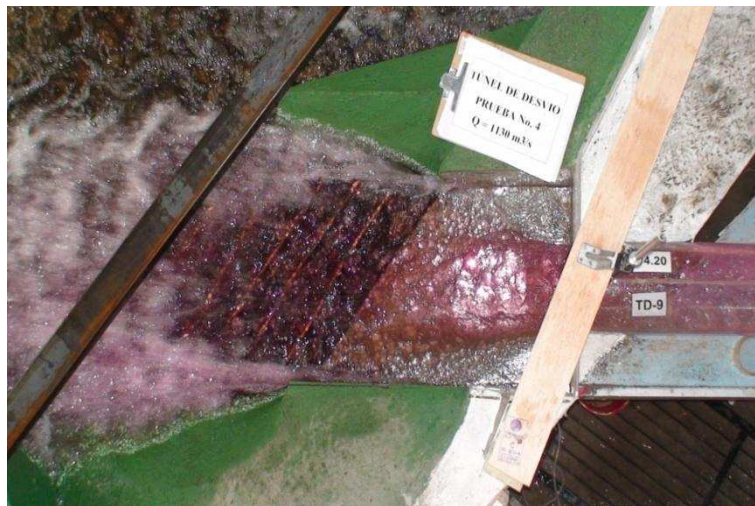
Fotografía No. 52: Vista en planta del funcionamiento de la estructura de salida en el Túnel de Desvío ( Q = 1130 \text{ m}^3/\text{s} )
