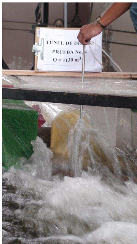
Fotografía No. 78: Toma de medida en el punto 2 TD en la salida Túnel de Desvío ( Q_{TDp} = 1138.27 \text{ m}^3/\text{s} , Q_{Dlp} = 192.40 \text{ m}^3/\text{s} )
