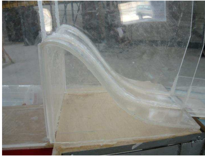
Fotografía No. 13: Vista lateral del modelo del vertedero con perfil Creager.
