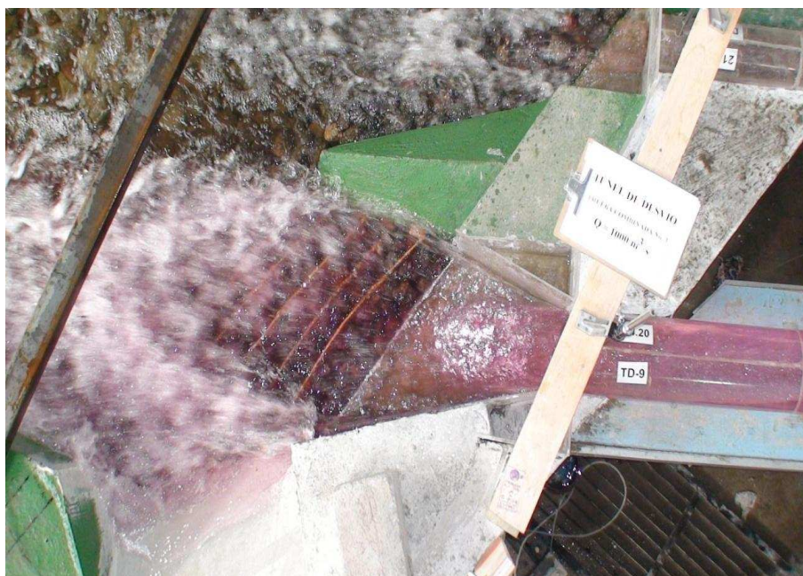
Fotografía No. 97: Vista superior del flujo en la estructura de salida modificada del Túnel de Desvío ( Q_{TDP} = 1001.02 \text{ m}^3/\text{s} , Q_{Dlp} = 200.05 \text{ m}^3/\text{s} )
