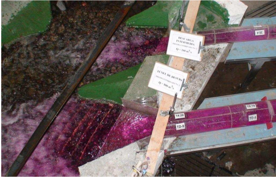
Fotografía No. 94: Vista superior del flujo de salida de la Descarga Intermedia y Túnel de Desvío ( Q_{TDp} = 799.92 \text{ m}^3/\text{s} , Q_{Dip} = 186.86 \text{ m}^3/\text{s} )
