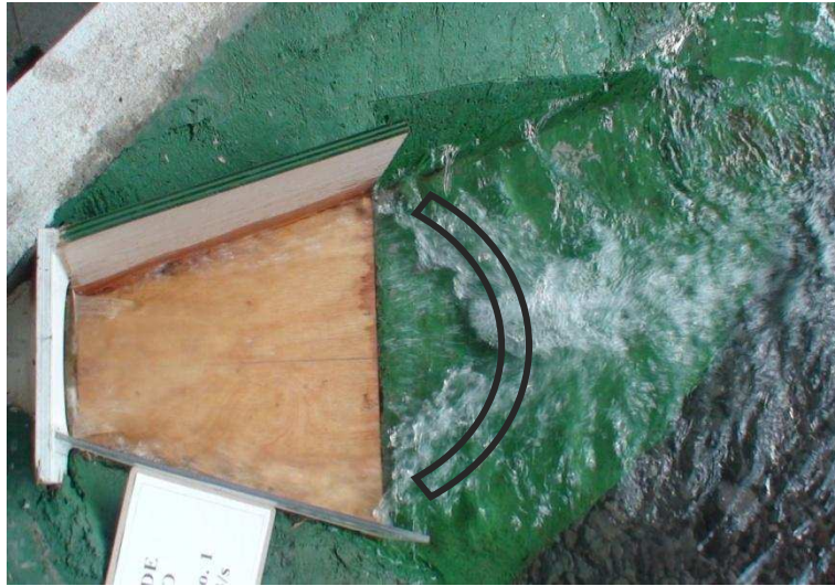
Fotografía No. 40: Resalto circular en estructura de salida con Q_{TD}=200\text{m}^3/\text{s} . Modificación MDE-2.
