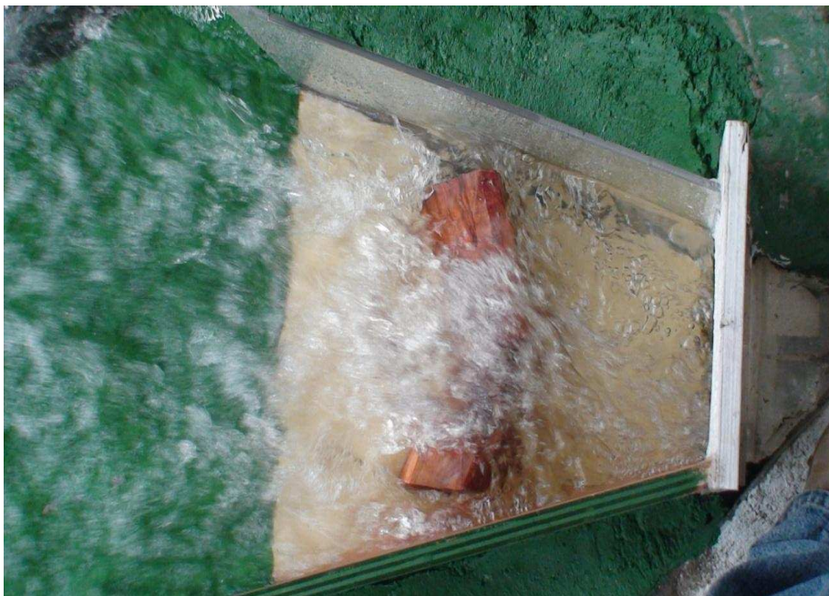
Fotografía No.20: Vista en Planta de la modificación en la geometría de estructura de salida denominada MDE-1
