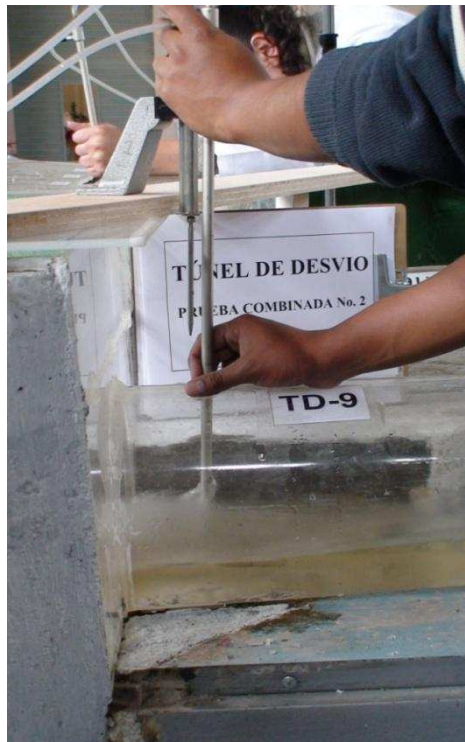
Fotografía No. 63: Toma de medida en el punto TD-9 del túnel de desvío ( Q_{TD} = 199.25 \text{ m}^3/\text{s} , Q_{DI} = 103.00 \text{ m}^3/\text{s} )
