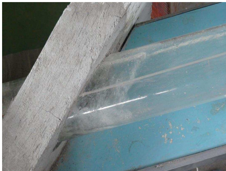
Fotografía No. 21: Onda transversal oblicua generada para caudales superiores a 500m 3 /s.
