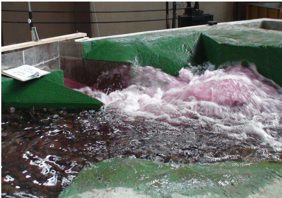
Fotografía No. 47: Imagen del flujo en la salida del Túnel de Desvío, ( Q_{TD}=1130.00 \text{ m}^3/\text{s} )
