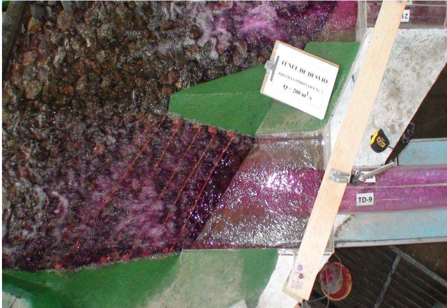
Fotografía No. 66: Vista superior del flujo de salida del túnel de desvío ( Q_{TD} = 199.25 \text{ m}^3/\text{s} , Q_{DI} = 103.00 \text{ m}^3/\text{s} )
