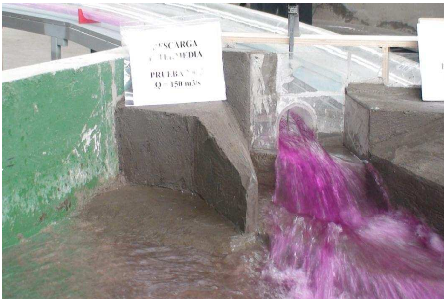
Fotografía No. 52: Vista frontal del flujo de salida de la Descarga Intermedia, ( Q_{DI}=150.00 \text{ m}^3/\text{s} )
