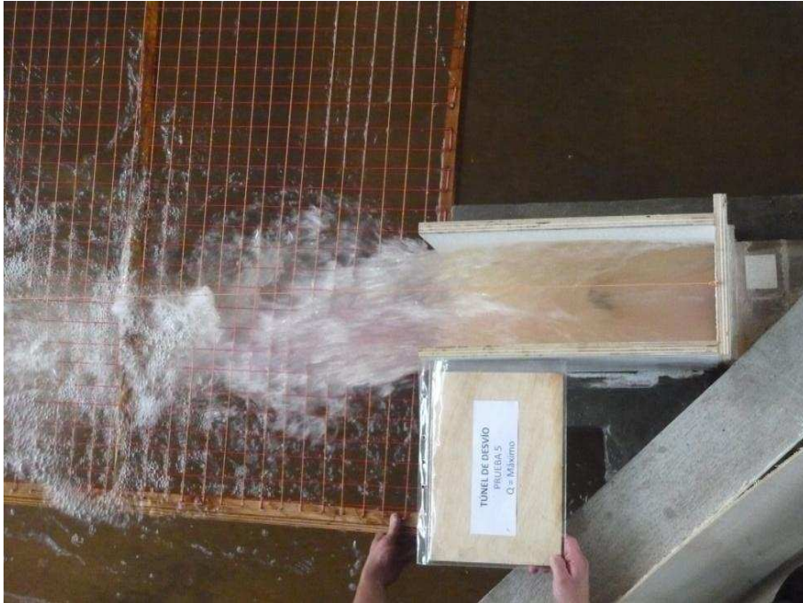
Fotografía No. 5 Vista de planta del funcionamiento del dissipador de energía tipo Kumin con un caudal de Q_{TD} = 940,5 \text{ m}^3/\text{s}
