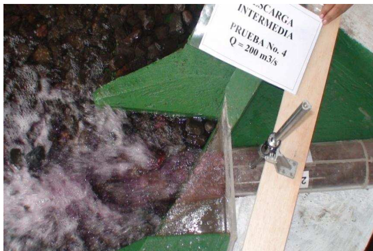
Fotografía No. 56: Vista en planta del funcionamiento de la estructura de salida en la Descarga Intermedia ( Q_{di}=200 \text{ m}^3/\text{s} )
