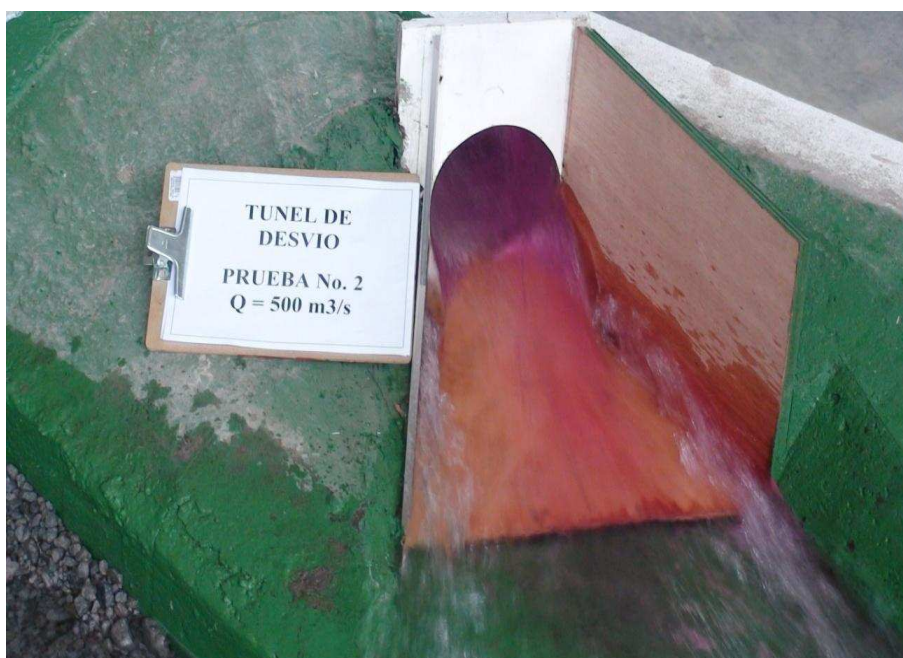
Fotografía No. 37: Vista Frontal del funcionamiento de la estructura de salida, con la modificación MI-2, Q=500 \text{ m}^3/\text{s}
