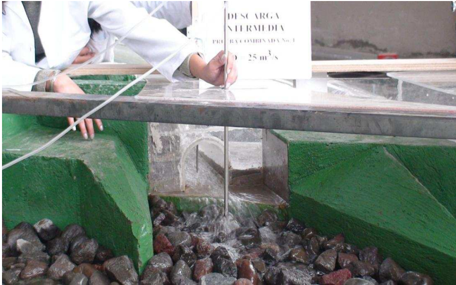
Fotografía No. 62: Vista frontal de la medición con el Pitot en el punto 5DI, ( Q_{TD} = 99.55 \text{ m}^3/\text{s} , Q_{DI} = 23.7 \text{ m}^3/\text{s} )
