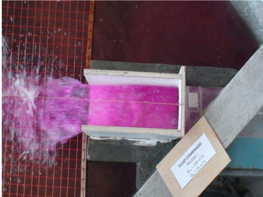
Fotografía No. 11 Vista de planta del funcionamiento del dissipador de energía tipo Kumin con un caudal de 224,5 \text{ m}^3/\text{s} ( Q_{TD} = 199,8 \text{ m}^3/\text{s} y Q_{DI} = 24,7 \text{ m}^3/\text{s} )
