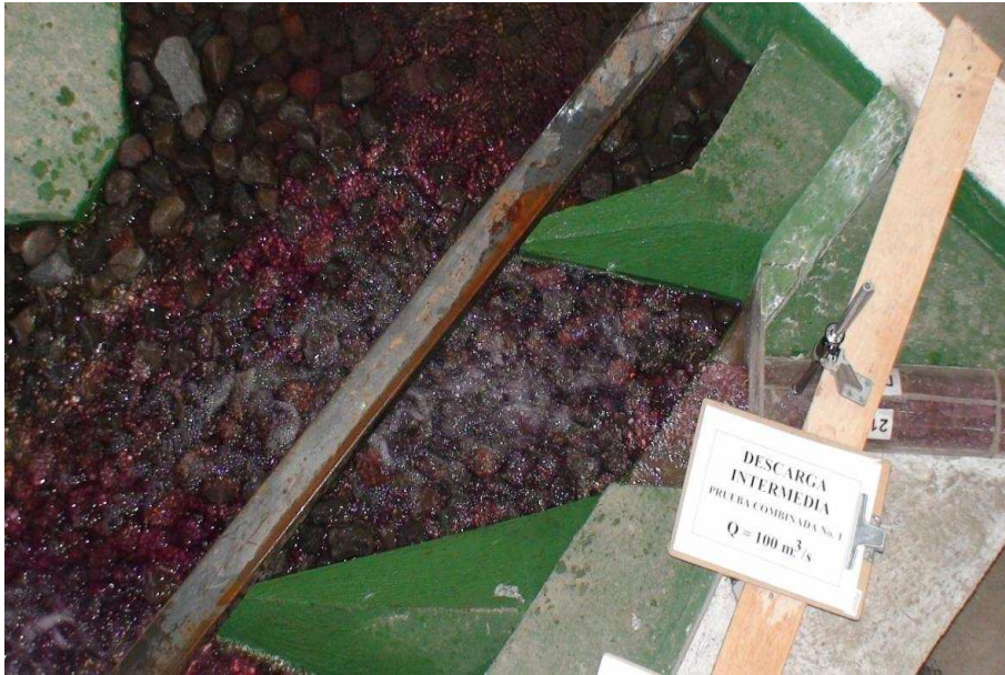
Fotografía No. 86: Vista superior del flujo de salida en la Descarga Intermedia ( Q_{TDp} = 499.62 \text{ m}^3/\text{s} , Q_{Dip} = 87.6 \text{ m}^3/\text{s} )
