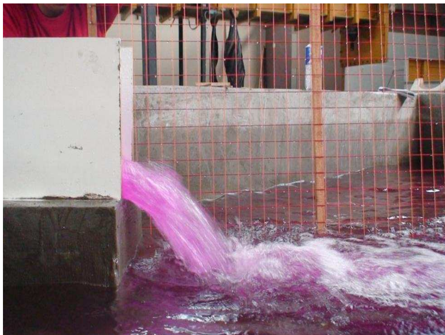
Fotografía No. 10 Vista lateral del flujo de salida del dissipador de energía tipo Kumin con un caudal aproximado de Q_{D1} = 200 \text{ m}^3/\text{s}
