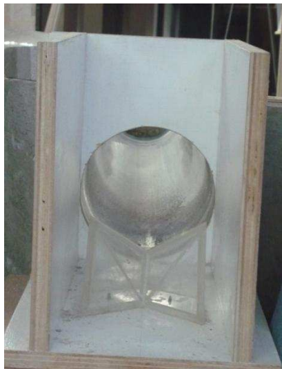
Fotografía No.11: Modelo del dissipador Tipo Kumin ubicado al extremo del Túnel de Desvío.
