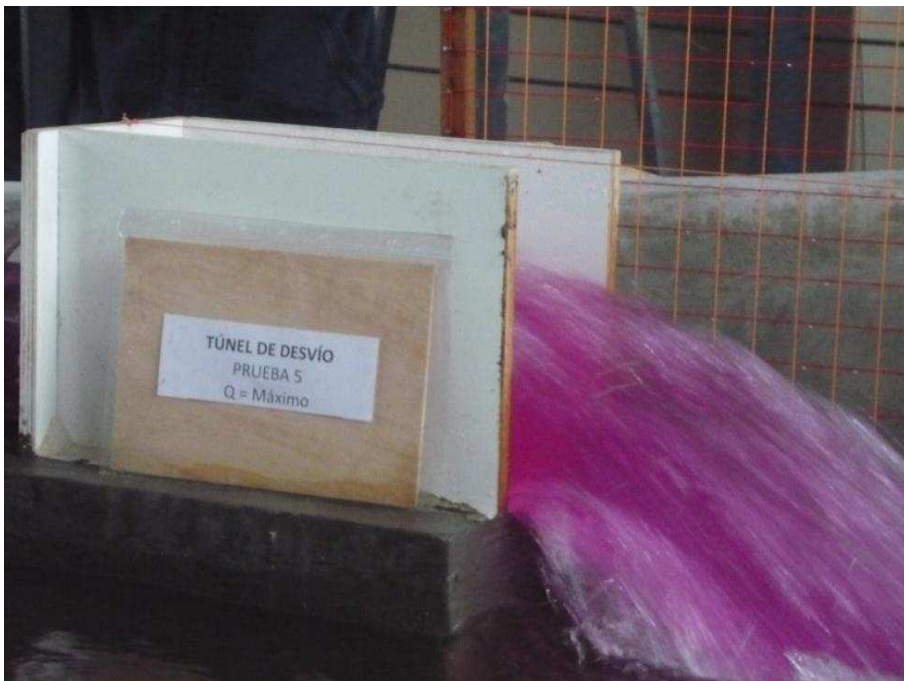
Fotografía No. 6 Vista lateral del flujo de salida del dissipador de energía tipo Kumin con un caudal de Q_{TD} = 940,5 \text{ m}^3/\text{s}
