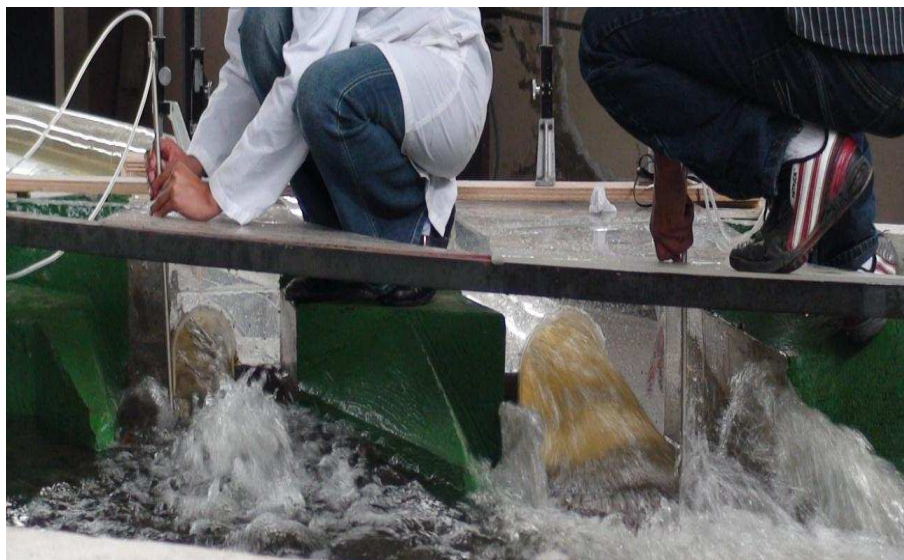
Fotografía No. 82: Vista frontal del flujo de salida en el Túnel de Desvío y la Descarga Intermedia ( Q_{TDp} = 1138.27 \text{ m}^3/\text{s} , Q_{Dip} = 192.40 \text{ m}^3/\text{s} )
